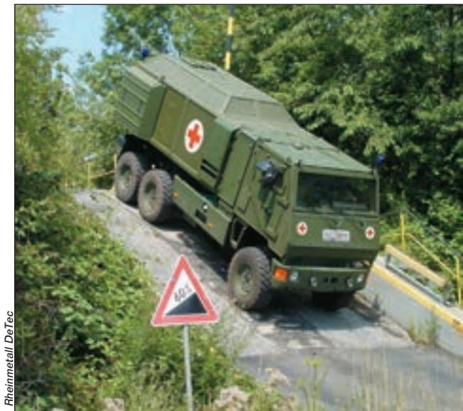
nih značajki vozila. Omogućava korisniku prilagodbu vozila traženoj zadaći uporabom specifičnih modula koji se postavljaju na standardizirano podvozje. Moduli mogu funkcionirati i stacionarno, kad se odvoje od podvozja što može biti prednost u pogledu logističke potpore.
