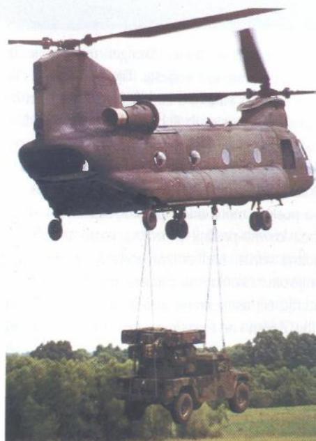
**U slučaju potrebe sustav Avenger brzo i lako menjaju položaj krećući se vlastitim pogonom ili prenošenjem zrakom pomoću transportnog helikoptera (na slici CH-47 nosi Avenger)**
