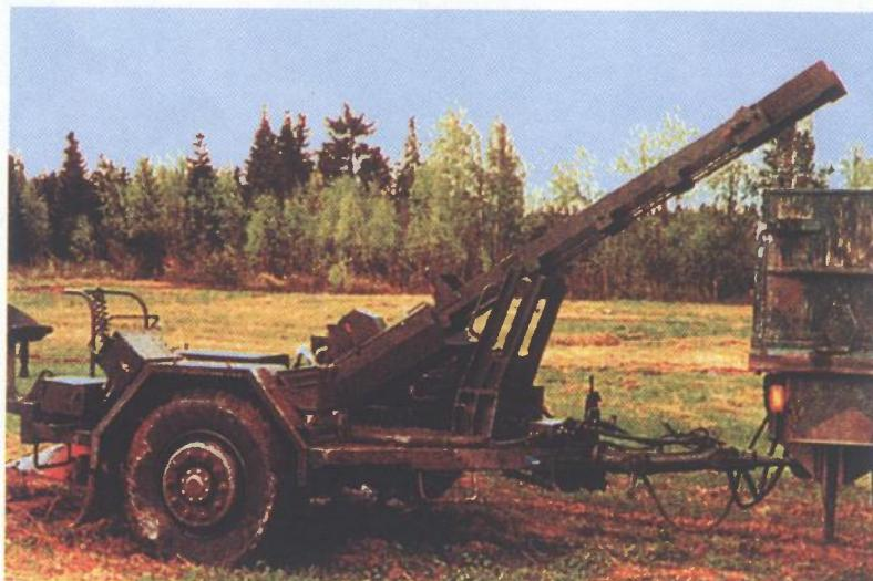
Minopolagač FFV 5821 ima masu 2,8 tona i može biti vučen brzinom od 7 km/h prikladnim vozilom dopuštajući četvorčlanoj posluži postavljanje više od 300 mina FFV 028 za jedan sat. Ako se mine postavljaju na ravno zemljište onda se može postaviti 500 mina za jedan sat. Nadalje, FFV može popuniti 1000 metara dugu minsko polje sa 70 postotnom vjerojatnošću aktiviranja što je pri klasičnom postavljanju ekvivalentno radu 30 vojnika u trajanju 3,5 sati uz korištenje tri kamiona
