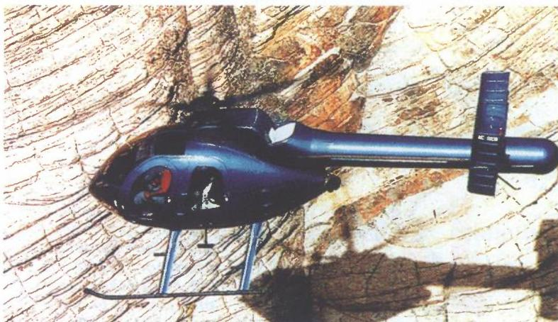
*Na slici je vidljiva jedna od prednosti NOTAR helikoptera pred konvencionalnim letjelicama: MD 520N lebdi uz stijenu bez opasnosti da repni rotor udari u zapreku*
