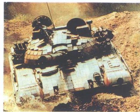
*Na slici je prikazan poljski tank T-72 opremljen ERA oklopom koji mu pruža dodatnu zaštitu od djelovanja klasičnih kumulativnih bojnih glava*
