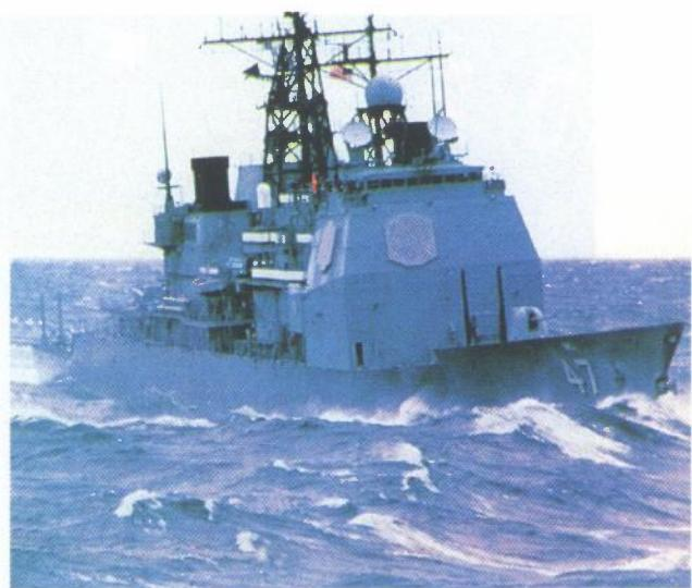
*Na slici se vide dvije od četiri ravne antenske rešetke, postavljene na nadgradu broda*
