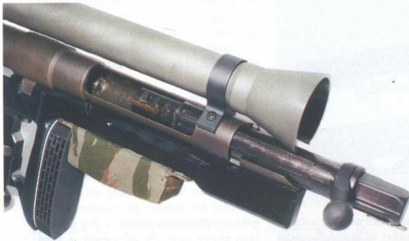
*Bravljjenje zatvarača za cijev obavlja se pomoću bradavica raspoređenih u tri reda*
