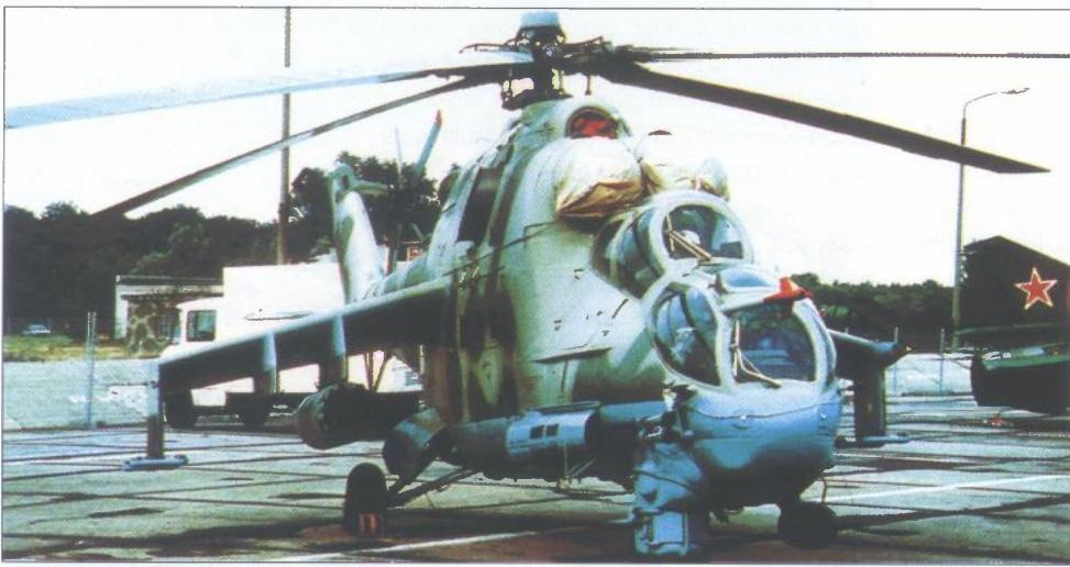
**Mil Mi-24P** dobio je umjesto šestocijevne gatling strojnica kal. 12,7 mm dvocijevni 30 mm top. Izvozna inačica Mil Mi-35P, osim manjih izmjena avionike, u biti je identična Mi-24P
