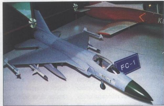
šine podsjećaju na one kod Lockheed Martina F-16 a i slične su veličine. Jednomotorni zrakoplov ima dva bočno postavljena uvodnika zraka i bit će pokretan turboventilatorskim motorom RD-93 (verzija s povećanim potiskom motora RD-33) ruskog biroa Klimov, s
