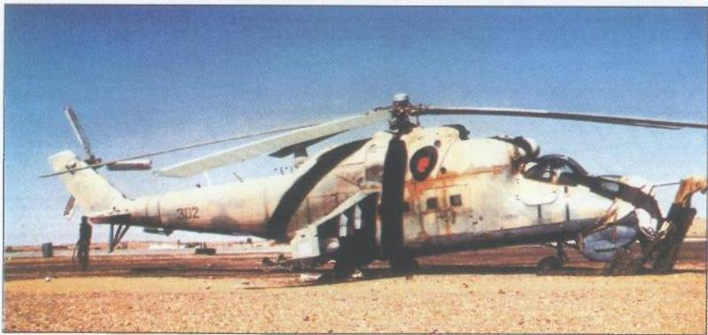
**Mil Mi-25, eksportna inačica Mi-24D; snimljeni primjerak zarobljen je u Čadu. Na helikopteru se vidi IC impulsni ometać Ispanka, lanseri IC i radarskih mamaca na repu, te odsustvo RHAWS sustava Berjoza**
