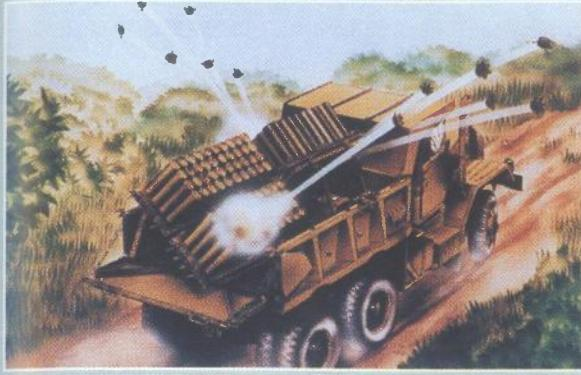
**Sustav Volcano ugrađen na kamion sa 160 lansirnih cijevi i 960 mina Gator**
