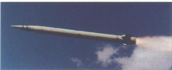
**KEM** (engl., *The Kinetic Energy Missile - raketa s velikom kinetičkom energijom*) sustava LOSAT ima brzinu od 1524 m/s a njezin penetrator može poraziti sve danas poznate oklope. Sustav je konstruiran kako bi se zadovoljili zahtjevi za sustavom koji može voditi PO borbu na povećanim udaljenostima
