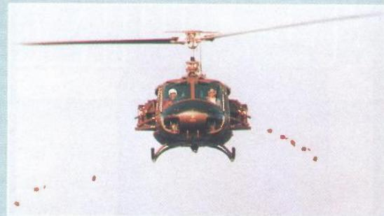
**Skorpion** sustav ugrađen na helikopter Bell UH-1D s mogućnošću izbacivanja 200 mina AT-2 za 15 sekundi pri srednjoj brzini od 90 km/h
