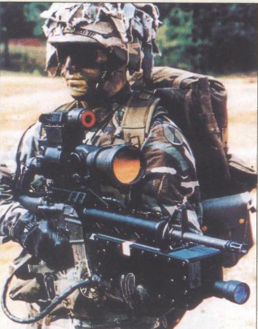
Pripadnici američkih postrojbi tijekom Zaljevskog rata 1990.-1991. godine imali su na raspolaganju razvojne modele Lockheed Sandersovog AN/PLQ-5 (LCMS Laser Countermeasures). Sustav LCMS koji je spojen na modificiranu automatsku pušku M16A2 može onesposobiti optičke i elektro-optičke senzore na udaljenostima većim od 2 km
