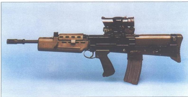
**Britanska automatska puška 5,56 mm L85A1 također ima "bullpup" konstrukciju (spremnik i trajući dijelovi smješteni su iza rukohvata), te optički ciljnik**
