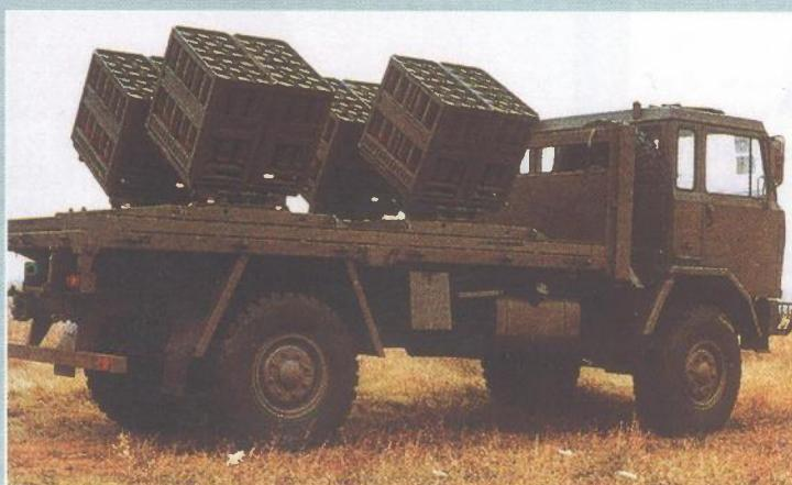
*Valsellin modularni disperzer površinskih mina "Istrice" ugrađen na Fiat - Iveco kamion 4x4 90 PM 16*
