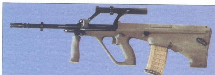
*Austrijska automatska puška 5,56 mm AUG prepoznatljiva je po svojoj "bullpup" konstrukciji, te integriranom optičkom ciljniku*
