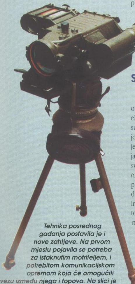
**Tehnika posrednog gađanja postavila je i nove zahtjeve. Na prvom mjestu pojavila se potreba za istaknutim motriteljem, i potrebitom komunikacijskom opremom koja će omogućiti vezu između njega i topova. Na slici je prikazana suvremena oprema istaknutog motritelja NOD AN/TAS-6, koja obuhvaća termovizijski binokularni teleskop za motrenje na velikim udaljenostima i laserski daljinometer.**
