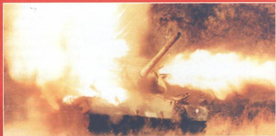
*Na slici je prikazan učinak PO vođene rakete na tanku. S desne strane jasno se vidi snažni kumulativni mlaz nastao aktiviranjem bojne glave PO vođene rakete koji je probio kupolu tanka*
