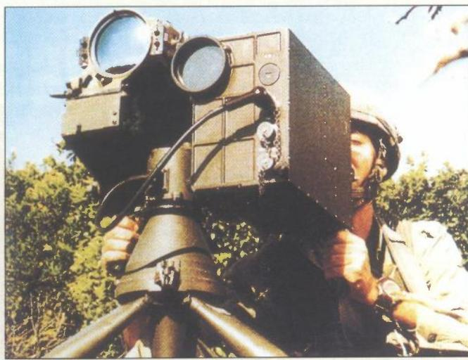
*Izraelska tvrtka El-Op razvila je napredni portabil laserski označivač (PAL) namijenjen za označavanje ciljeva za napad laserski vođenim bombama ili topničkim projektilima na udaljenostima preko 8 km danju i 6 km noću*
