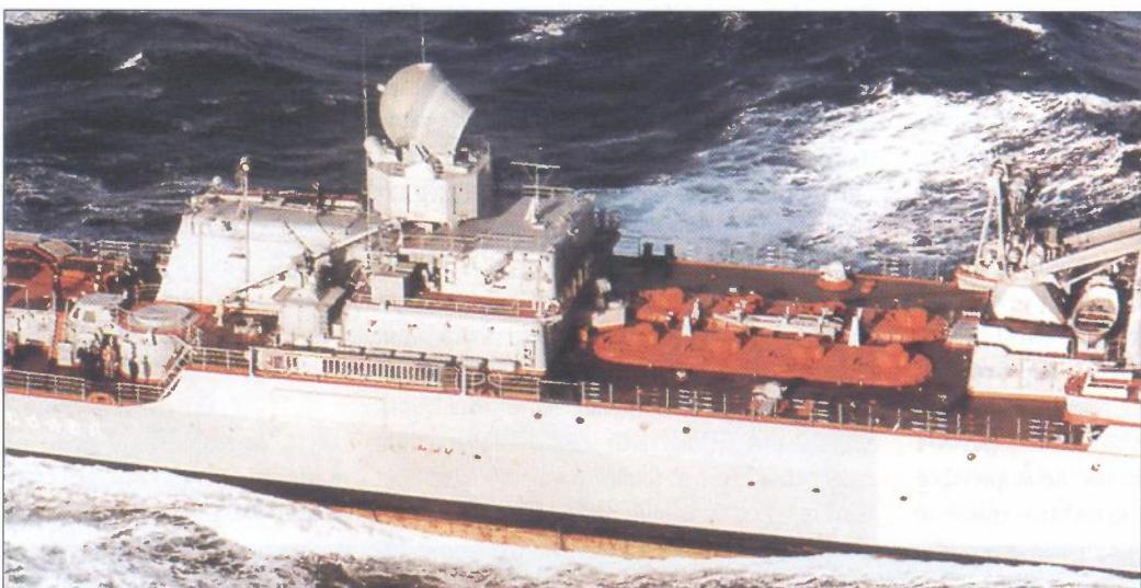
*Kraj hangara za helikopter smješteni su lansirni bunar "ZIF-122" sustava "Osa-M" i pripadajući radar 4R33, a na njegovom krovu je ciljnički radar "Top Dome". Na palubi se vidi skupina lansera sustava S-300F i dizalica za punjenje raketama, a na bokovima su bacači mamaca "ZIF-121"*
