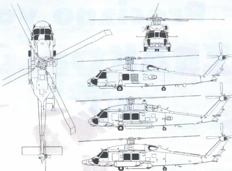
Crtež SH-60B, s dodatnim bočnim crtežima HH-60H (u sredini) i HH-60J (dolje)
