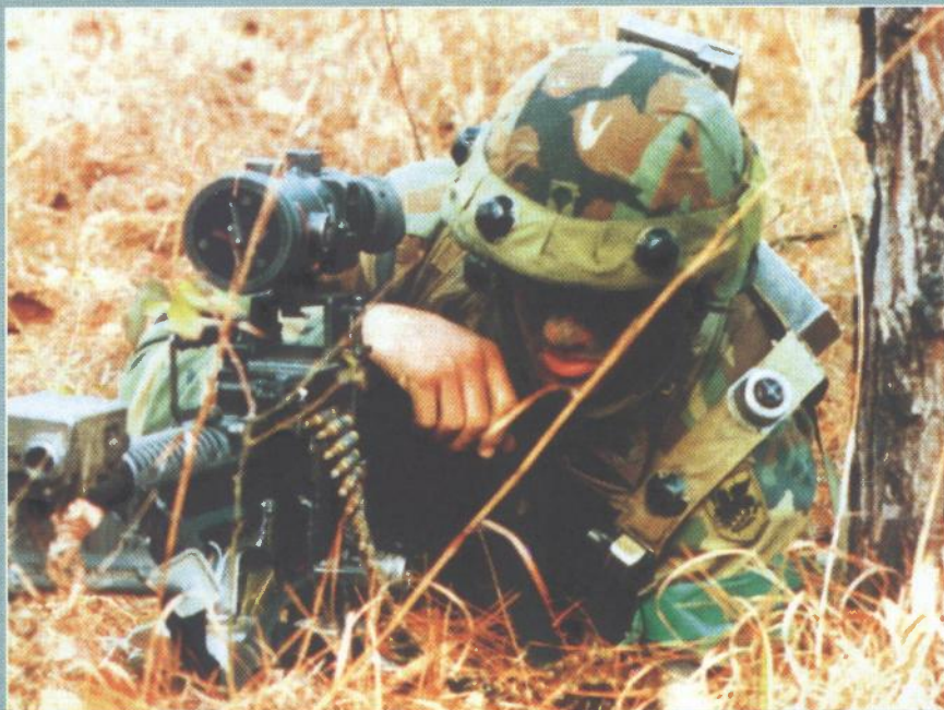
Sustav MILES na vojniku. Jasno se vide senzori na kacigi i na uprtačima
