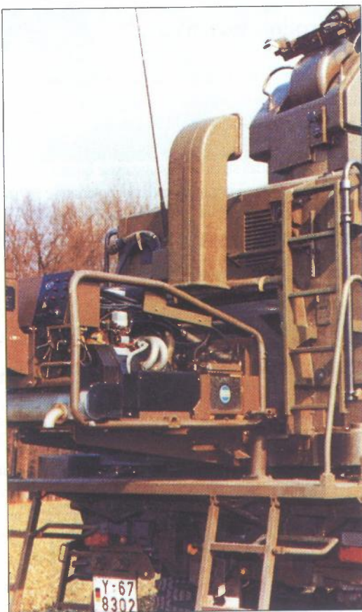
Sustav Field Guard raspolaže velikim stupnjem autonomnosti djelovanja i ima svoj vlastiti električni generator
