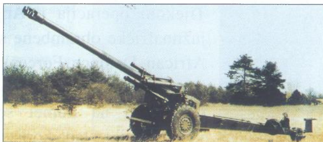
Francuska modifikacija M114 GIAT Industries, korištenjem cijevi 40 kalibara 155 TR
