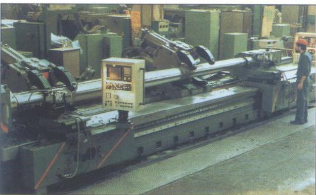
Moderno numeričko upravljano postrojenje u jednoj od tvornica za proizvodnju cijevi kalibra 155 mm
