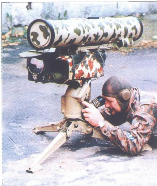
"Maskirani" POVRS "Kornet" u paljbenom položaju s operatorom spremnim za lansiranje rakete. S desne strane lansera vidi se velika leća termovizijske kamere te lijevo od nje "optička skretnica" koja se u slučaju korištenja kamere zatvara poklopcem koji je jasno vidljiv na slici
