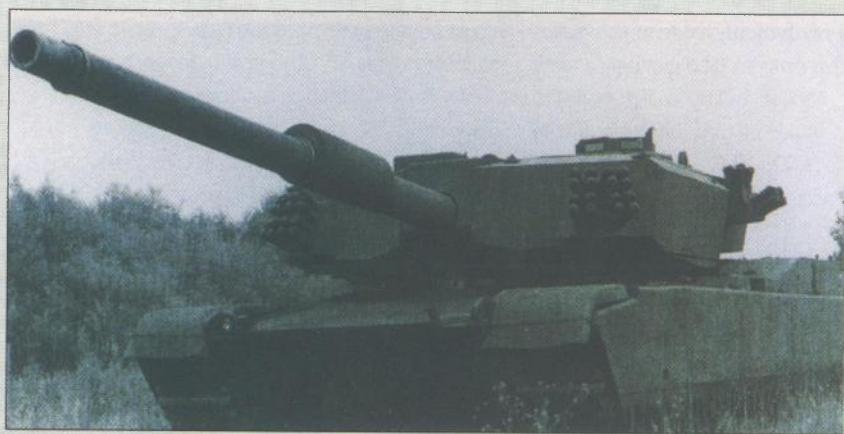
Američki Tank Test Bed ima motor straga, a proizveden je s topom kalibra 120 i opcije 140 mm. Temelj mu je kućištu Abrams tanka
