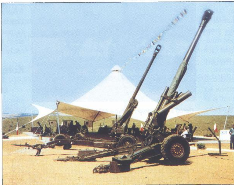
Haubica M114L 155/39 OTO Melara izložena pokraj haubice FH-70 (u drugom planu). Vide se balistički identične cijevi dužine 39 kalibara
