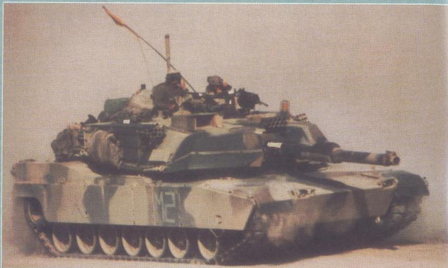
M1A1 tank na vježbi u Nacionalnom središtu u Fort Irwinu. Pojas oko kupole nosi senzore sustava MILES II. Laserski predajnik je smješten u cijevi topa
