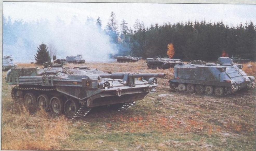
Dvočlana posada švedskog tanka s kazematnim topom "S", ima dvije postaje u kućištu tanka, iz kojih ima mogućnost upravljanja tankom i prilagođavanje topa
