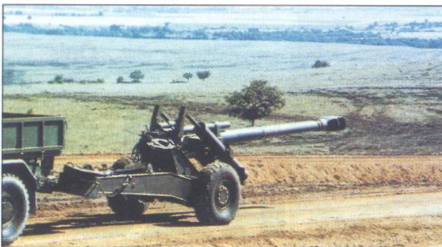
Ispitivanje prijevoznih značajki haubice M114 L OTO Melara brzinom do 60 km/h po neuređenim cestama
