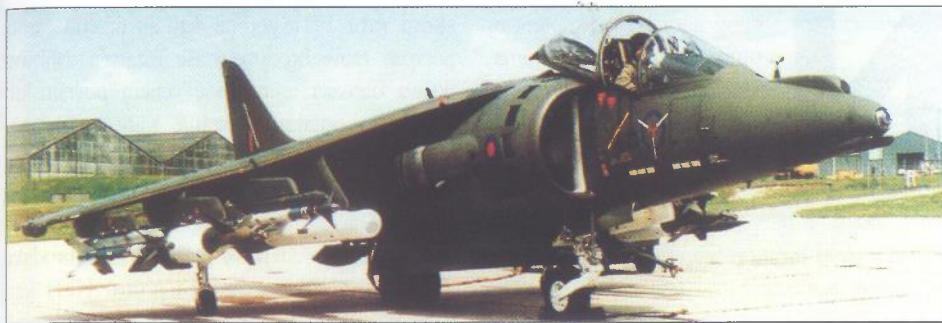
GR.7 s ubojnim teretom od dvije laserski vođene bombe (svaka mase 549 kg), spremnikom sa sustavom TIALD i četiri Sidewindera
