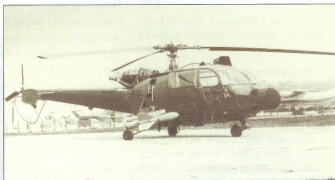
Drugi helikopter početno korišten za ovu namjenu bio je francuski Alouette III (na slici je Alouette III opremljen protubrodskim projektilom AS.12 i motrilačkim radarom)
