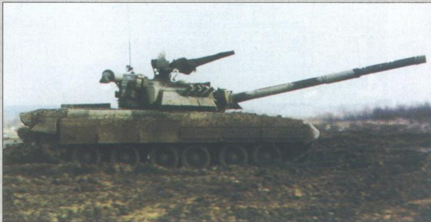
Ruske konstrukcije tenka, kao što su T-72 i T-80 (na slici) odlikuje se kompaktnošću kupole, koja omogućava da oba člana posade imaju neometani pogled prema naprijed. Međutim, prototipska ispitivanja novog ruskog tanka s topom kalibra 140 mm, određuju smještaj tročlane posade u kućištu prednjeg dijela tanka
