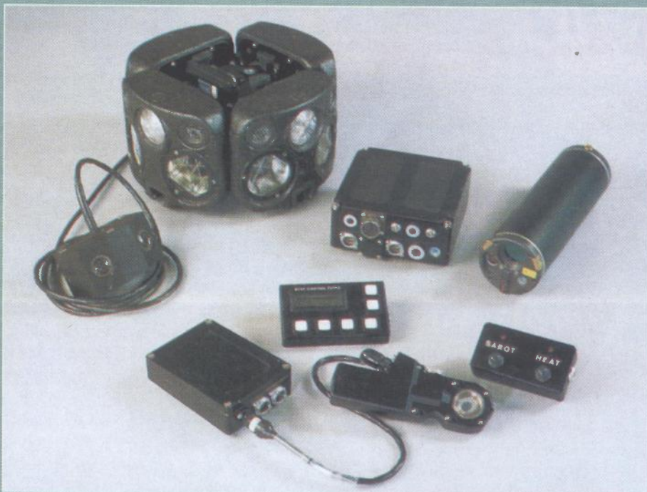
Švedski sustav laserskog tankovskog simulatora BT 46 (SAAB). Komplet uključuje laserski predajnik, nadzornu elektroniku i bateriju retroreflektora
