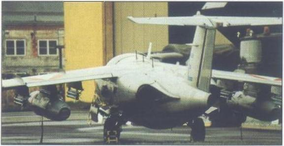
**Saab 105 pripremljen za jurišnu misiju: pod krilima se vide nevodenе rakete zrak-zemlja kal. 75 mm i spremnici s topovima kal. 30 mm**
