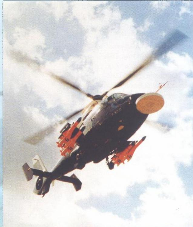
**AS.365F Dauphin 2:** na slici se jasno vide četiri protubrodska projektila AS.15TT (po dva na jednom nosaču na boku vrtoleta), te kućište radara Agrion 15 na nosu letjelice
