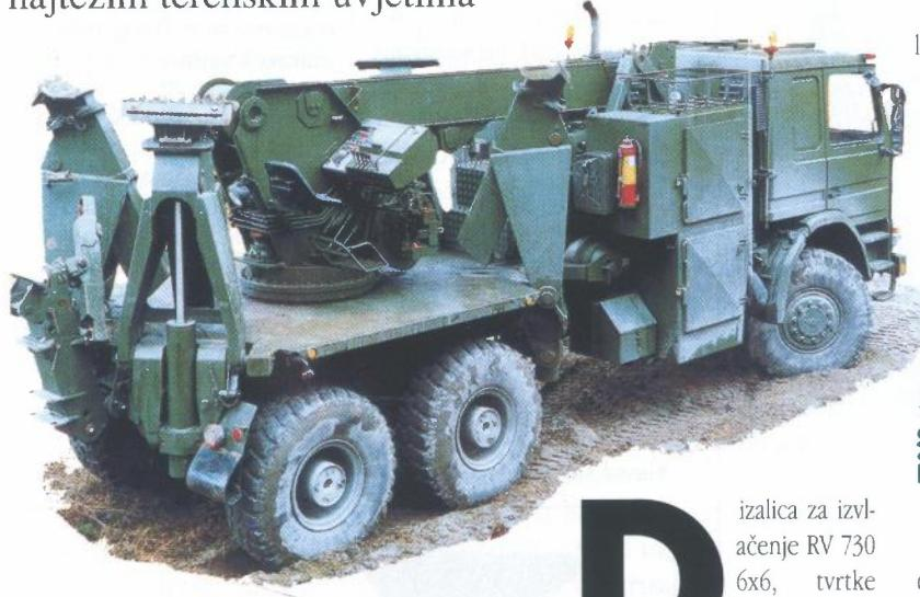
*Terenska dizalica za izvlačenje RV730 na vozilu SCANIA 113H 310 6x6, u transportnom položaju*
