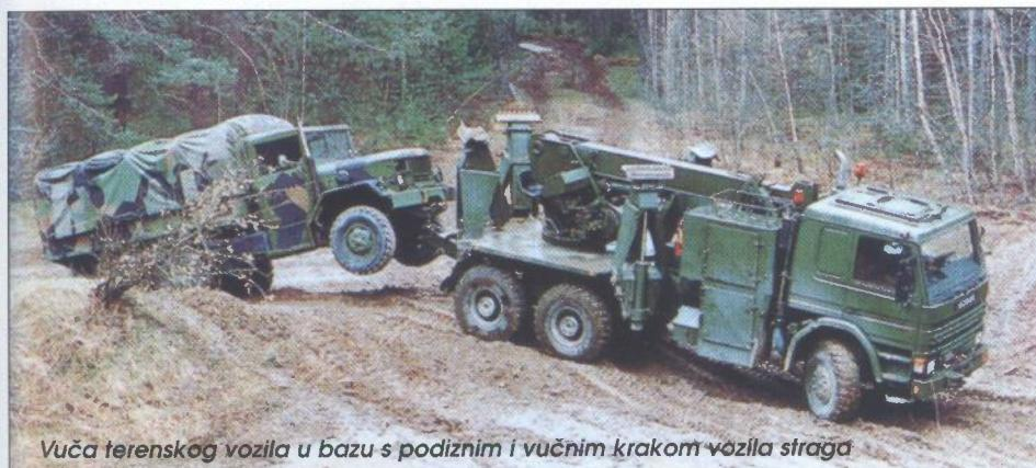
*Vuča terenskog vozila u bazu s podiznim i vučnim krakom vozila straga*
