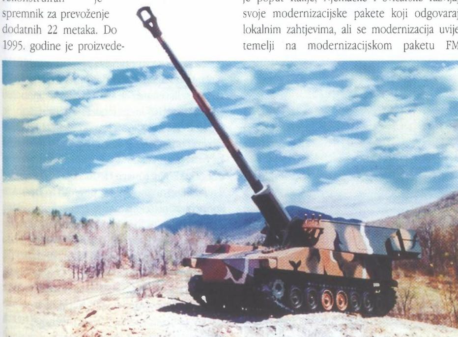
Jedan od modela M109 LP s cijevi dužine 52 kalibara za ispitivanje paljbe s tekućim punjenjem
