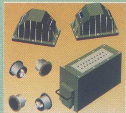
**Integrirani sustav samozaštite vrtloeta (TWE - Threat Warning Equipment) Tiger/Tigre/Gerfaut.** TWE koristi dva senzora za otkrivanje lasera (na slici gore), četiri senzora za otkrivanje radarskog djelovanja (lijevo dolje) i elektroničku jedinicu (desno dolje)
