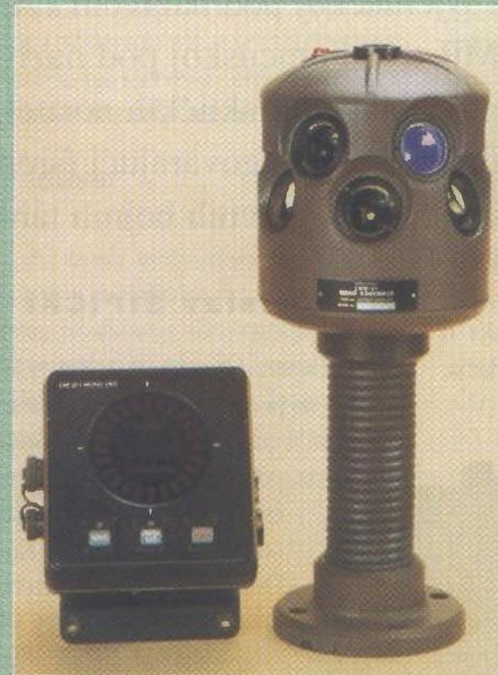
**Upozorivač na lasersko zračenje LWD21 britanske tvrtke Avimo za uporabu na oklopnim vozilima i drugim platformama. Detektorska glava na sebi ima kružno raspoređenih 12 silicijskih fotodioda i jedan vertikalni detektor na vrhu. Azimut položaja prijetnje prikazuje se s točnošću  $15^\circ$  na zapovjednikovu pokazivaču u miliradijanim ili stupnjevima**
