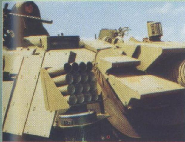
**Sustav POMALS (Pedestal Operated Multi Ammunition Launching System)** koristi Amcoram LWS-2 upozorivač tvrtke Elsira Electronic System. Sustav raspolaže mogućnošću brze reakcije na prisutnu prijetnju ispaljujući dimne projektili, ometače iz višecijevnog lansera. U normalnim meteorološkim uvjetima dvije dimne granate kreiraju dimnu zavjesu 60X6 m na udaljenosti od 50 metara od vozila za dvije sekunde
