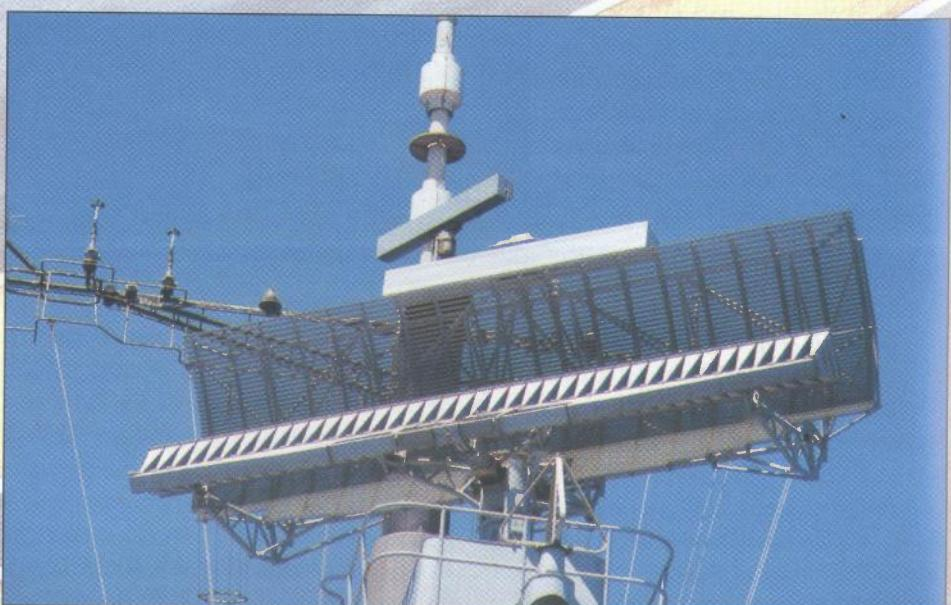
**Antena radara za motrenje zračnog prostora Marconi/Signaal Type 1022 i IFF antena**
