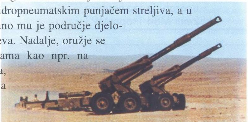
Usporedni prikaz dviju haubica 155 mm M71; jedna s cijevi 39 kalibara, a druga s dužinom cijevi 45 kalibara
