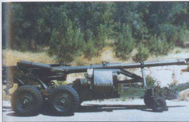
**Izvedenica s pomoćnim pogonom APU koji je ugrađen na lijevom kraku. Na desnom kraku je manipulativna dizalica za utovar - istovar streljiva. Oružje je prilagođeno za vuču klasičnim teglačem**
