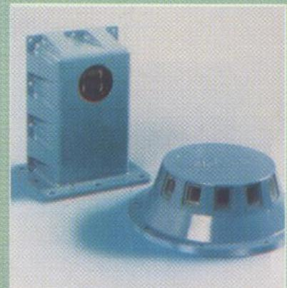
**GEC-Plessey Avionics** je konstruirala prijamnik za upozorenje PA7030 koji radi u valnom području od 0,4 μm do 1,1 μm a koristi kombinaciju izravnih detektora i detektora koji pokrivaju širi spektar. Izravni detektor sadrži 12 silicijevskih dioda čijim je rasporedom omogućeno pokrivanje područja od 360° po smjeru i 55° po visini. Drugi tip detektora za pokrivanje šireg sektora ima dvije fotodiode, osiguravajući pokrivanje s dvije fotodiode zone od 90° po smjeru i 3° po visini
