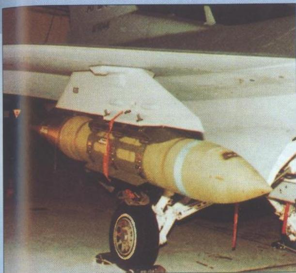
od laserskih označivača ciljeva poput sustava Pave Penny ili Pave Tack, već će biti dovoljno pomoći podatkovne veze koja postoji između zrakoplova nosača i ubojnog sredstva upisati zemljopisne koordinate cilja i prepustiti GPS-u ostatak posla oko navođenja.
