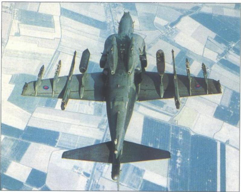
*Harrier GR.7 tijekom izvođenja petlje: na potkrilnim nosačima vidljivi su lanser nevodenih raketa zrak-zemlja (na unutarnjem nosaču lijevog krila) i nosač za vježbovnu bombu (na unutarnjem nosaču suprotnog krila)*
