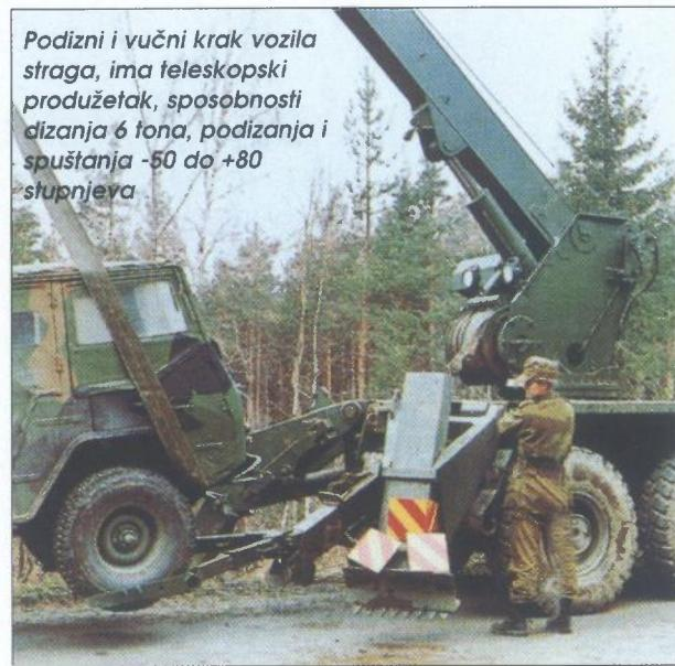
*Podizni i vučni krak vozila straga, ima teleskopski produžetak, sposobnosti dizanja 6 tona, podizanja i spuštanja -50 do +80 stupnjeva*
