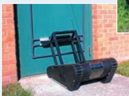
■ Vojni robot Matilda opremljen mehaničkim manipulatorom
