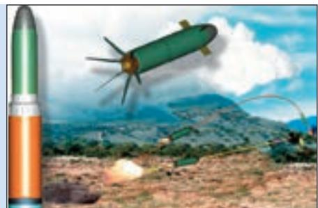
Nakon ispaljenja rasklapa se šest krilaca na stražnjem dijelu projektila i četiri na prednjem dijelu koja usmjeravaju projektil tijekom leta i napada. U početnoj fazi leta projektil se oslanja na inercijalni navigacijski sustav i leti prema mjestu koje mu je uprogramirano prije opaljenja. U završnoj se fazi aktivira kombinirano IC/poluaktivno lasersko tražilo koje izvodi završni zahvat cilja. Ima dva moda napada, izravni napad ili napad odozgora na slabije oklopjenu površinu cilja.
