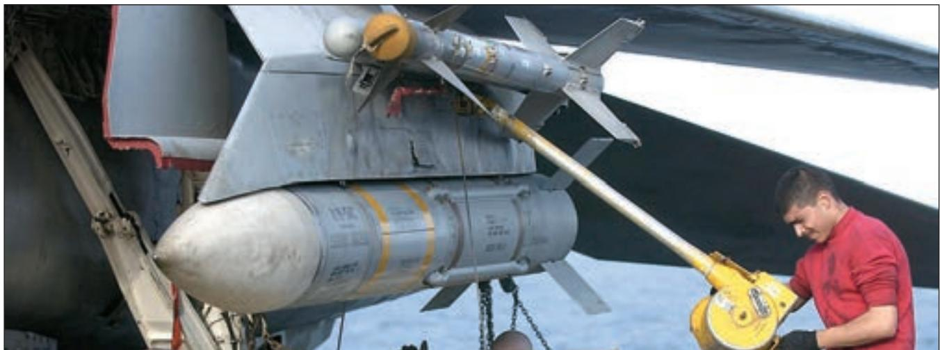
**NAKON** tridesetgodišnje uspješne uporabe US Navy povlači iz operativne uporabe svoj prvi projektil zrak-zrak velikog dometa AIM-54 Phoenix. Phoenix je jedan od tehnološki najnaprednijih taktičkih projektila, odnosno prvi operativni projektil zrak-zrak s aktivnim radarskim navođenjem koji istodobno može napasti više ciljeva.
