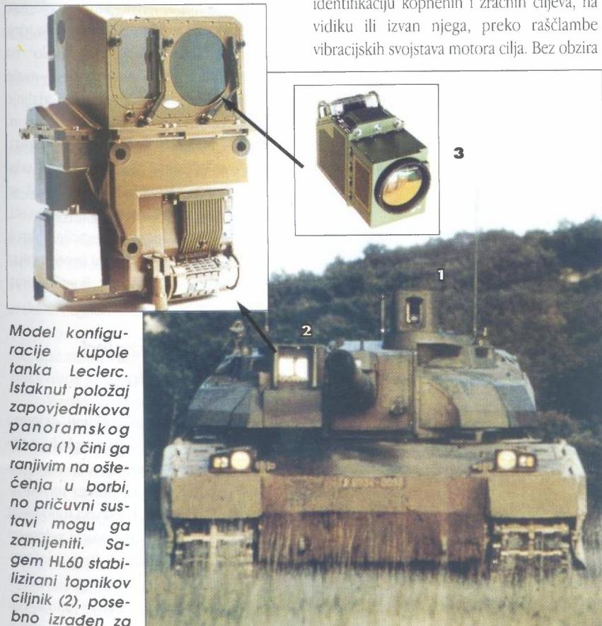
*Model konfiguracije kupole tanka Leclerc. Istaknut položaj zapovjednikova panoramskog vizora (1) čini ga ranjivim na oštećenja u borbi, no pričuvni sustavi mogu ga zamjeniti. Sašem HL60 stabilizirani topnikov cilnjik (2), posebno izrađen za Leclerc tenk, ima kanal za korištenje po danjem svjetlu kao i SAT Athos toplinski vizor (termovizijska kamera/desno), te ugrađen Avimo laserski uređaj za određivanje udaljenosti. Toplinski vizor Athos (3) ugrađen u HL60*
