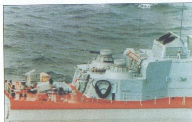
Na stražnjem dijelu nadgrađa vidljiva su dva otvora za izlaz plinova iz turbina za krstarenje, 6-cijevni rotacijski topovi AK-630M, dok su na krmi postavljeni 16-cijevni lanseri chaffova
