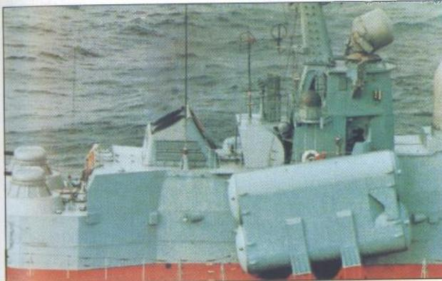
Na sredini broda smješteni su spremnici za projektili sustava "Termit" (Styx), dok se na jarbolu među ostalim nalaze ciljnički radar MR-123 i optronički direktor "Hood Wink", te antene sustava za električnu borbu "Foot Ball", a iza njega sustav 4K32M (bez lansera)
