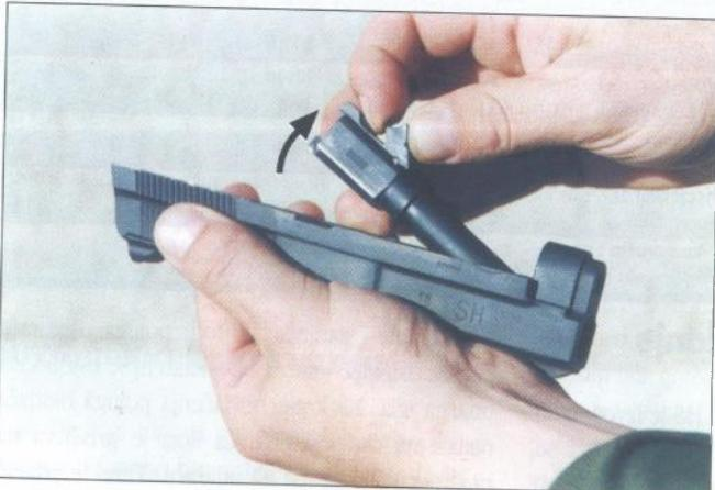
**Podizanjem navješ odvojiti cijev od navlake**
