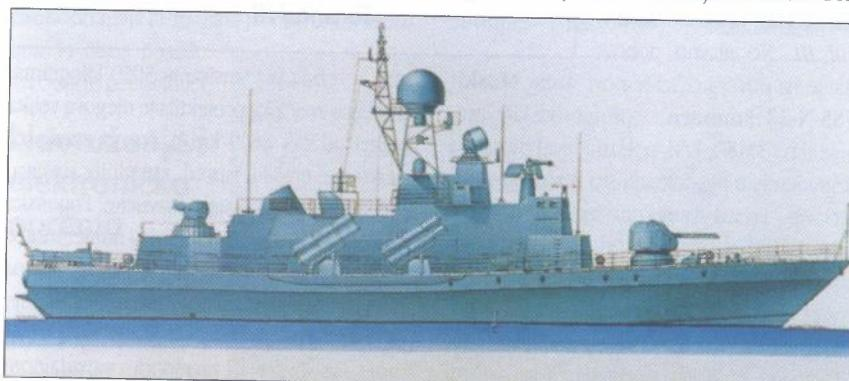
**Crtič inačice Projekt 12418 naoružane sustavom "Uran" s projektilima H-35**
