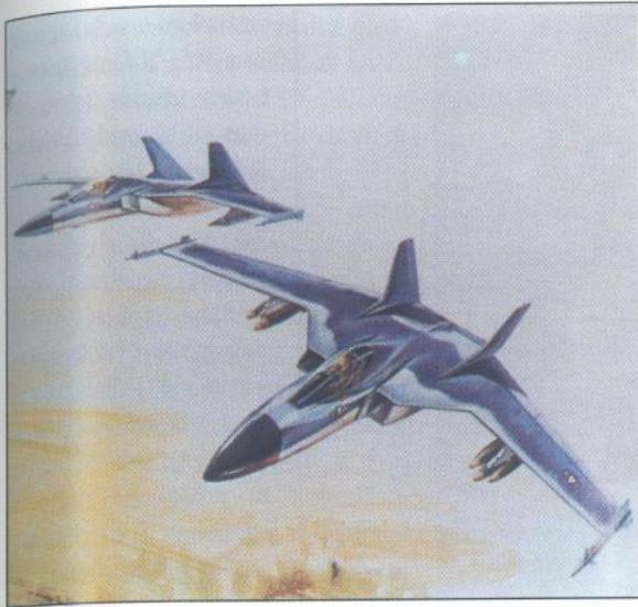
**Grummanov prijedlog višenamjenskog lovca za ATF program; bila je predviđena primjena vektorskog potiska (ugradnja četvrtastih mlaznica), a najveća brzina zrakoplova trebala je iznositi oko 1.5 Macha**
