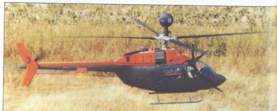
Treći prototip OH-58D, modificirani OH-58A (69-16139), na kome je ugrađen prvi MMS nemogućnost napadanja odnosno branjenja. Sve su te činjenice dovele do toga da je 1979. godine pokrenut program AHIP (Army
