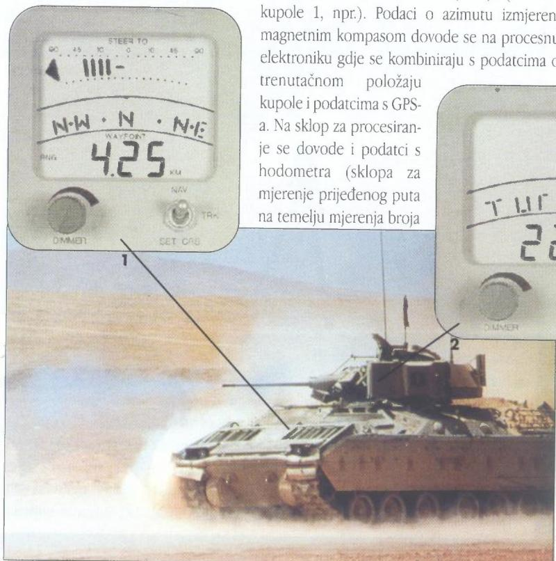
Sustav TACNAV (od TACtical NAVigation) koristi podatke o položaju vozila izmjerene satelitskim sustavom globalnog pozicioniranja PLGR (Precision Lightweight GPS Receiver), u kombinaciji s podatcima o kursu vožnje dobivenih iz elektroničkog kompasa vlastite proizvodnje, kako bi posadu opskrbio pouzdanim i točnim informacijama potrebnim za vožnju i navigaciju.
