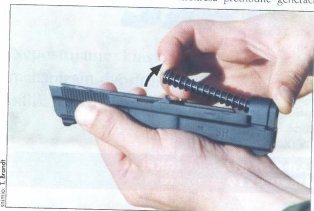
**Odvojiti navlaku od kućišta povlačenjem prema naprijed. Iz navlake izvaditi povratnu oprugu s vodilicom**
