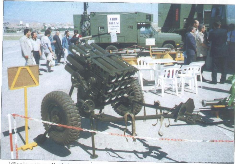
*Višecijevni bacači raket standardno su oružje gotovo svake vojske. Na slici je prikazan dvanaestocijevni bacač turske proizvodnje*
