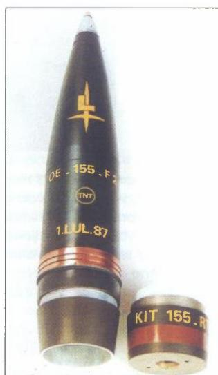
*Topnički projektil kalibra 155 mm F2 Luchaire. U dolnjem dijelu projektila je za uočiti navojno spajanje tzv. supljeg dna ili u slučaju zahtjeva za povećanim dometom, mogućnost ugradnje generatora plina (BB)*
