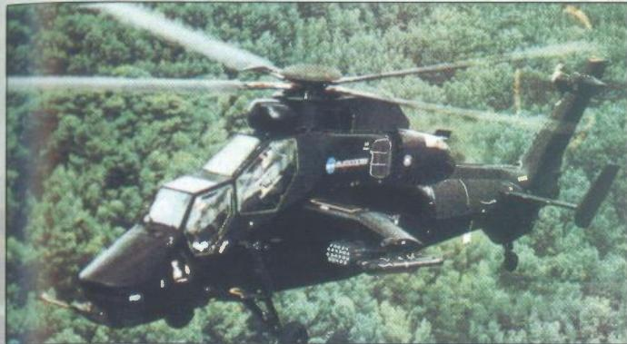
*Na slici je prikazana protuoklopna inačica vrtroleta Eurocopter TIGER koji je konstruiran prema zahtjevima Njemačke i Francuske vojske. Rabiti će PO vodene rakete TRIGAT-LR*
