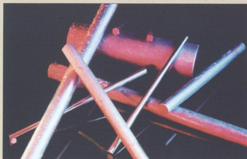
*Magnetostriktivna tvoriva kao što je Terfenol-D, od kojeg su načinjene ove šipke dugačke svega nekoliko centimetara, mijenjaju duljinu u magnetskom polju. Razvijen za primjenu u vojnim sonarima, ove slitine se danas koriste u aktuatorima, senzorima i kontrolerima vibracija*
