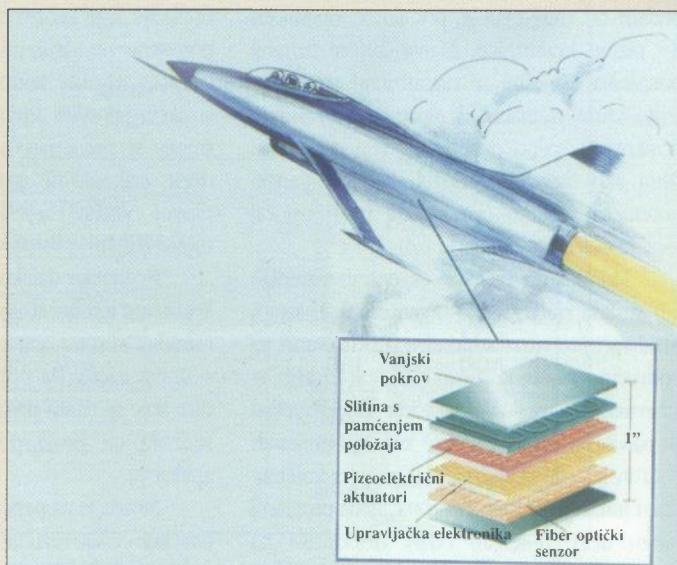
*Tijelo zrakoplova moglo bi biti načinjeno od tankih slojeva aktuatora i fiber-optičkih senzora kojima bi se kompenzirale promjene nastale zamorom tvoriva i detektirale inače neuočljive fizikalne i kemijske promjene u tvorivu koje prethode kvarovima*
