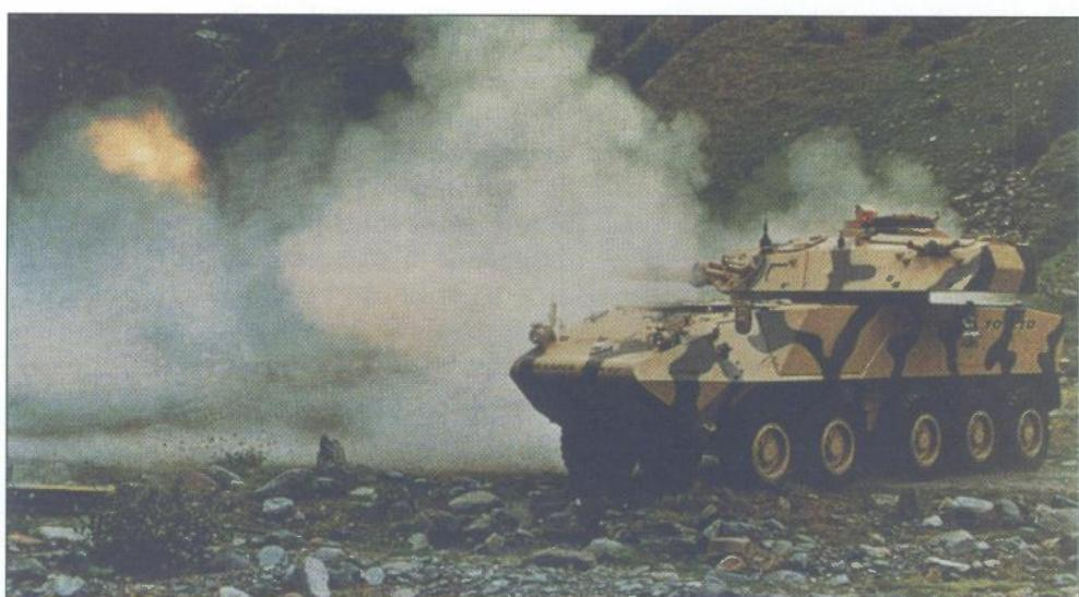
Primjer napretka sa 105 mm topom, vidi se kod vozila Piranha 10x10, tvrtke Mowag. Vozilo je snimljeno za vrijeme ispitivanja paljbenе moći, a posebno je konstruirano kao platforma za visokoučinkoviti top. Potencijalno tržište je Bliski istok
