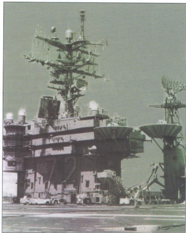
Mnoštvo antena za komunikaciju na nadgrađu nosača zrakoplova je sada reducirano zahvaljujući uporabi optičkih kablova
