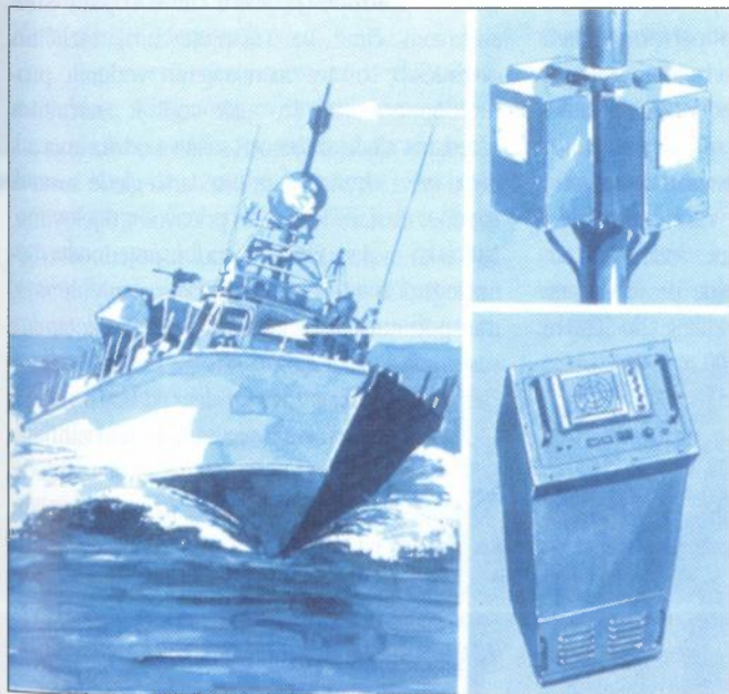
Skica broskog digitalnog detektora radarske opasnosti koji ima četiri sektorske antene na jarbolu i konzolu pokazivača u kormilarnici
