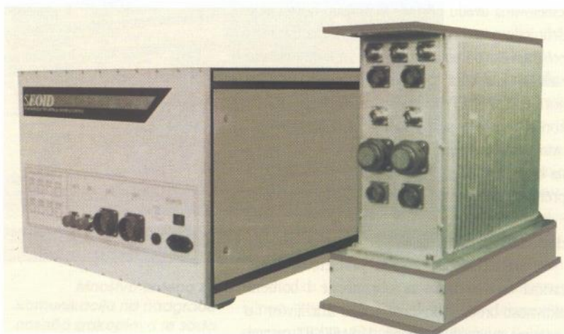
Optoelektronski uređaji tvrtke Quest Communications koji se koriste na nosaču zrakoplova Abraham Lincoln za pretvorbu električnih u optičke signale i obrnuto
