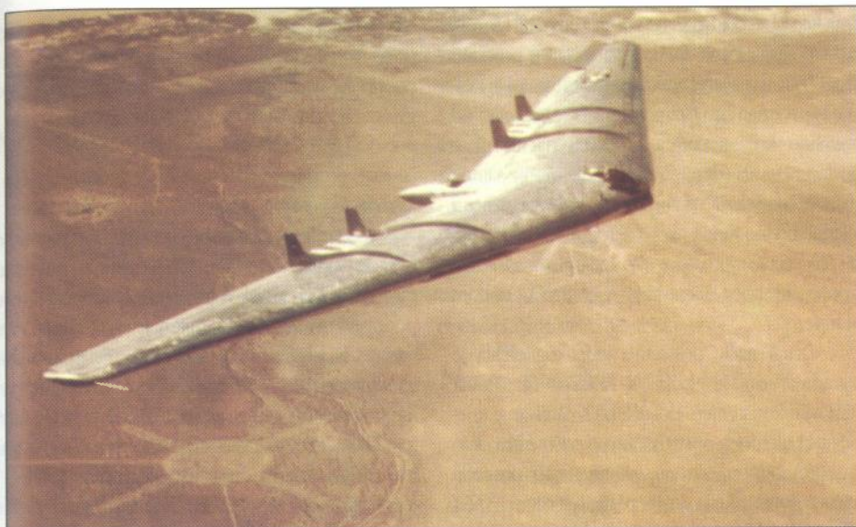
Idealno rješenje za konstrukciju budućih strateških transportnih zrakoplova pruža koncept letećeg krila, prvi puta praktično primjenjen na zrakoplovima kompanije Northrop četrdesetih i pedesetih godina (na slici je Northrop XB-49)
