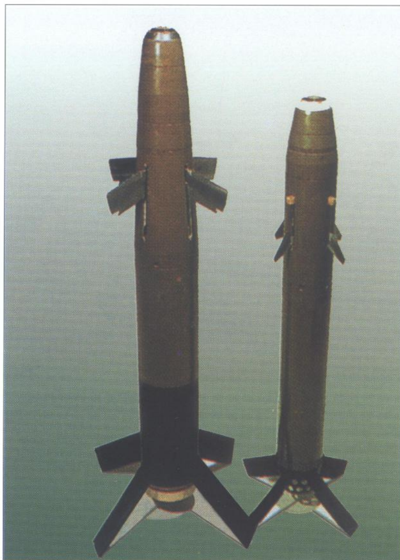
Topnički laserski vođeni projektili ruske proizvodnje. Krasnopol (lijevi) kalibra 152 mm maksimalnog učinkovitog dometa 20.000 m. Desni je laserom vođeni projektil Kitolov-2 kalibra 122 mm dizajniran za uporabu iz samovoznog topničkog sustava 122 mm 2S1 i vučnog topničkog sustava 122 mm D-30
