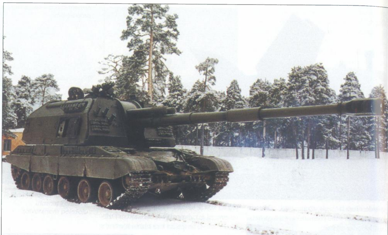
Dolazak oružja na paljbni položaj. Temeljne značajke ruskog samovoznog sustava 152 mm MSTA-S (2S19) su mobilnost, učinkovitost i pouzdanost
