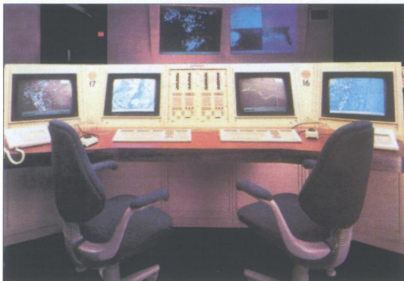
Središte carinske službe SAD (C 3 I) za nadzor i upravljanje pomorskom situacijom u kojemu su dva radna mjesta sa po dva pokazivača, i to lijevo sa slikom iz motrilačkih radara, te desno koje ima radno/obavještajnu ulogu
