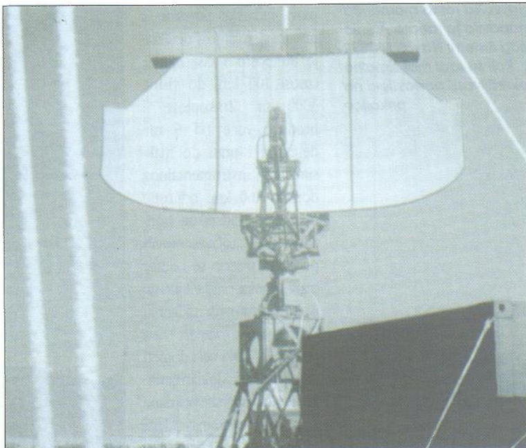
Obalni radar RAT-33S/M za kombinirano motrenje površinskih i zračnih objekata u volumenu "C"
