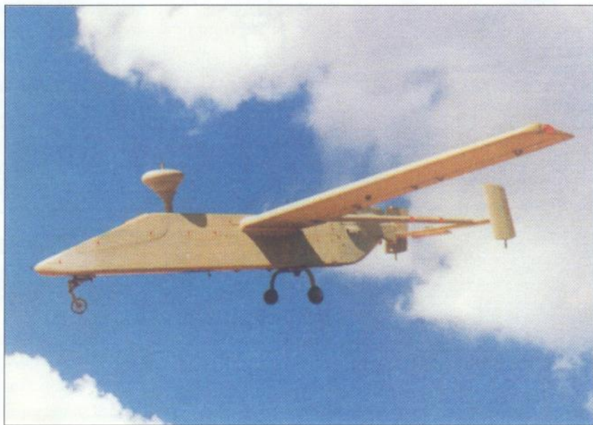
Najnovija, četvrta generacija bespilotnih letjelica Searcher u operativnoj uporabi Izraelske vojske je od 1992. godine. Izviđanje obavlja sa visine oko 7000 m, uz mogućnost neprekidnog leta 24 sata. Od opreme može nositi: TV kameru, infracrveni senzor, ELINT/ESM prijamnik, laser i komunikacijsku opremu
