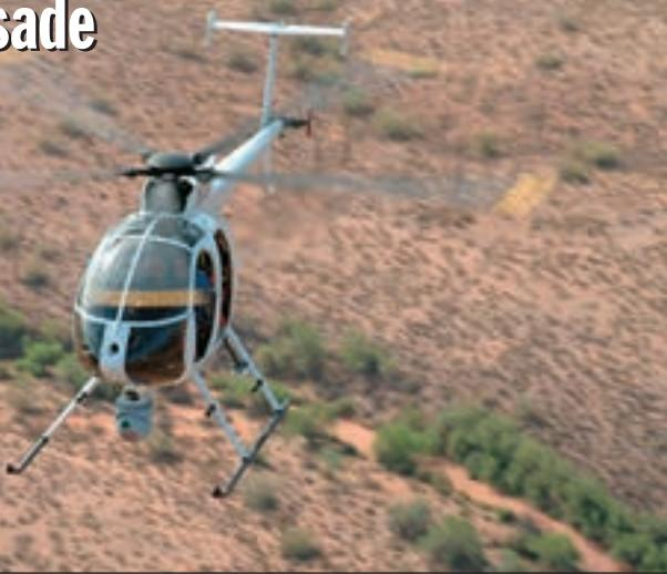
**AMERIČKA** tvrtka Boeing uspješno razvija inačicu helikoptera s alternativnim sustavom upravljanja, odnosno bez pilotske posade, koju je nazvala MD530F, odnosno *Unmanned Little Bird*. Letjelica se temelji na postojećoj platformi helikoptera MD500/AH-6/MH-6 *Little*
