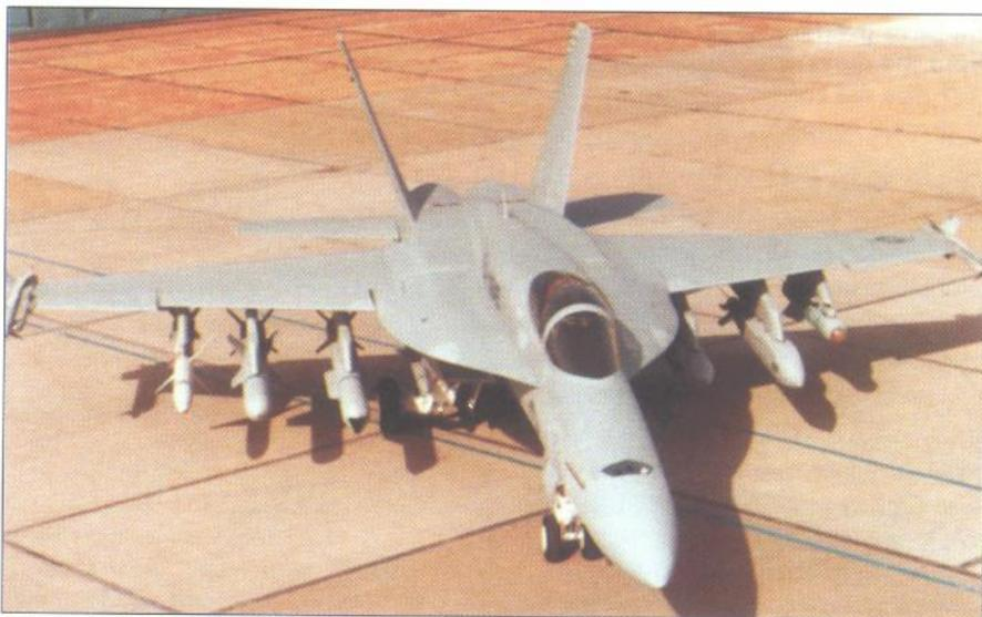
**Prototip E1 sa sljedećim oružjima na potkrilnim nosačima (slijeva nadesno): AIM-9, HARM, Harpoon, SLAM-ER, AIM-120 AMRAAM (ispod lijevog krila), JDAM, JSOW, AGM-65 Maverick, AIM-9 Sidewinder (ispod desnog krila)**
