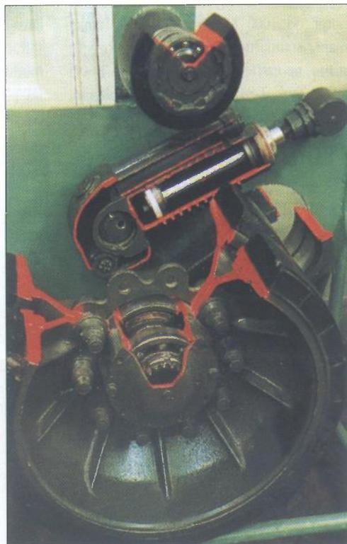
Torzijski ovjes tanka s amortizerom udara iznad kotača
