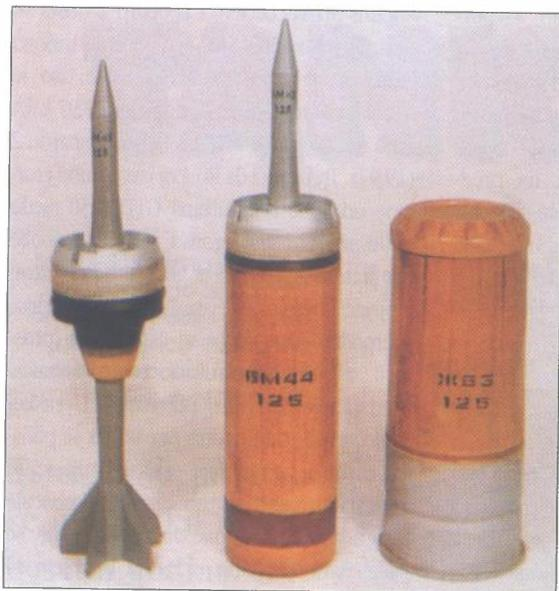
**Razvojni rad na KE streljivu koje se ne zasniva na osiromašenom uranu, doveo je do projektila poput 3BM42 APFSDS, koji ima košuljicu za probijanje od ojačanog čelika i samo neznatno manju moć probijanja kompaktnog cilja od DU streljiva, na udaljenostima do 2000 m**
