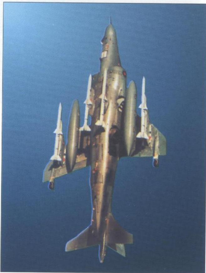
**AIM-120 AMRAAM na Sea Harrieru GR.2 tijekom testova integracije oružanog sustava**
