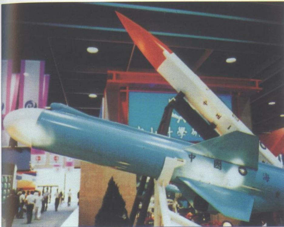
*Jedan od primjera uporabe sustava s dvojnim načinom vođenja izvan područja projektila zrak-zrak je i tajvanski protubrodski projektil Hsiung Feng II (u prvom planu), kod kojeg je mali IC senzor postavljen iza radoma (upotrebljava se za razlikovanje pojedinačnih meta)*
