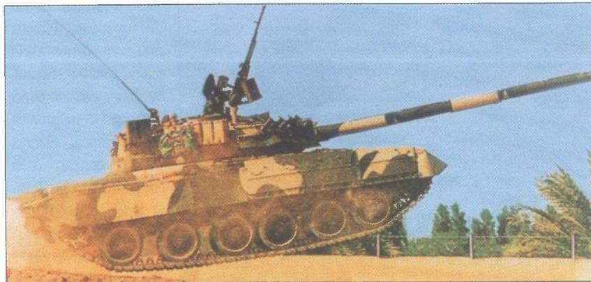
Štora sustav protumjera primjenjuje se u ruskoj vojsci, gdje se ugrađuje na T-80UK zapovjedne tankove. Pri otkrivanju laseriranja, automatski se uključuje optoelektronička uzbuna sustava Štora-1. Izbacivanje aerosolne zavjese (iz šest lansera) je na udaljenosti 50-60 m. Sustav obuhvaća i infracrveno djelovanje s modulatorom ometanja. Djelotvornost sustava se očituje kroz smanjenje vjerojatnosti pogađanja prvim projektilom protivnika:
