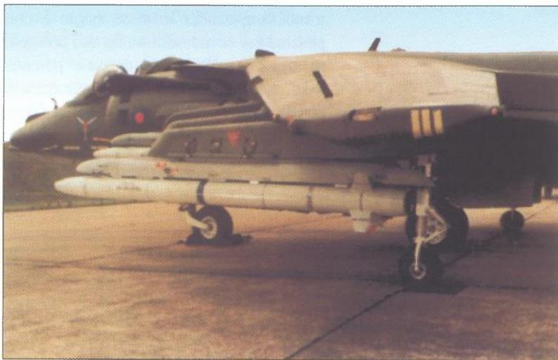
*Britanski ASRAAM u ovom trenutku opremljen je IC tragačem s najvećom otpornošću na IC protumjere*
