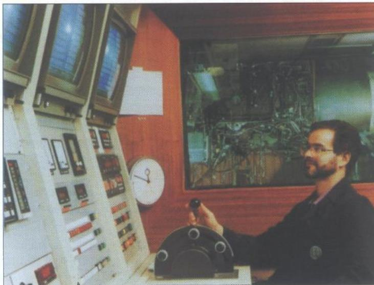
**Ispitna soba s komorom za ispitivanje mlaznih motora. Sustavi za ispitivanje, naravno, imaju veliki značaj na polju provjere aplikacija novih tehnologija**
