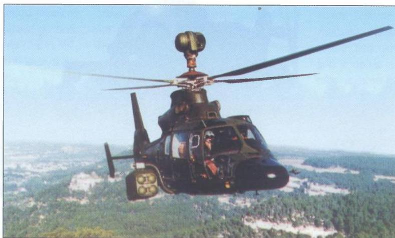
*Modificirani vrtolet Panther (prikazan na slici i korišten za ispitivanje sustava za novi borbeni vrtolet Tiger) opskrbljen je optičkim ciljničkim sustavom Osiris, sustavom ATA za nadzor paljbe, te kontejnerima s protuoklopnim vođenim raketama TRIGAT-LR. U okviru ove konfiguracije sustav Osiris se pokazao kao sustav koji je sposoban prikazati na monitoru sustava za kontrolu i ciljanje visokokvalitetnu TV i termovizijsku sliku na daljinama većim i od 8000 metara*
