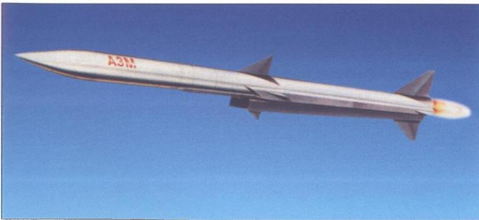
*Crtež srednjedometnog projektila A3M, koji treba dobiti tragač s inercijalnim i djelatnim radarskim vođenjem*
