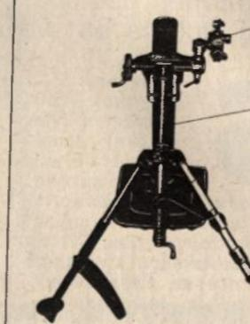
Sl. 1. Kolimator - optički ciljnik, a - kolimator (gletka) za minobacače 1 - objektiv, 2 - končanica; b - ciljanje pomoću kolimatora C-cilj u neizmernosti, K-končanica kolimatora
