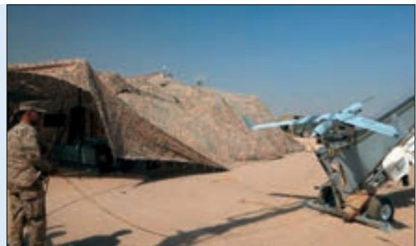
vozila. Za te zadaće ScanEagle rabi žirostabiliziranu elektrooptičku kameru, te laserski senzor za otkrivanje i praćenje ciljeva.
