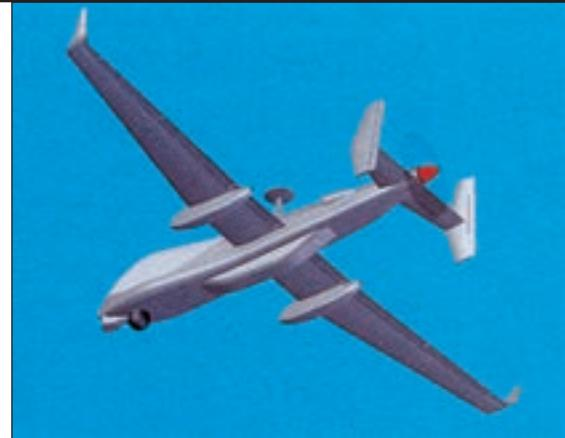
390 m. Struktura letjelice u cijelosti je izrađena od kompozitnog materijala, i modularnog je tipa što omogućava brzo i lako sklapanje, odnosno transport letjelice. Zanimljivo je napomenuti i to kako letjelica Bateluer ima u cijelosti uvlačiv stajni trap. Što se tiče pogonske skupine trenutačno se razmatraju dva prijedloga, odnosno Rotax 914 te Subaru EA-82T s promjenjivim korakom elise.
