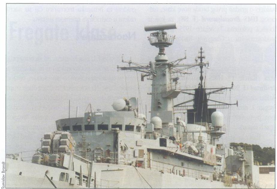
*Ispred zapovjednog mosta F 95 smješteni su lanseri projektila Exocet i Seawolf, na njegovom krovu vidi se ciljnički radar Type 911, a na vrhu prednjeg jarbola je antena radara Type 967/968, dok su ova jarbola puna raznih komunikacijskih i antena sustava za ometanje*
