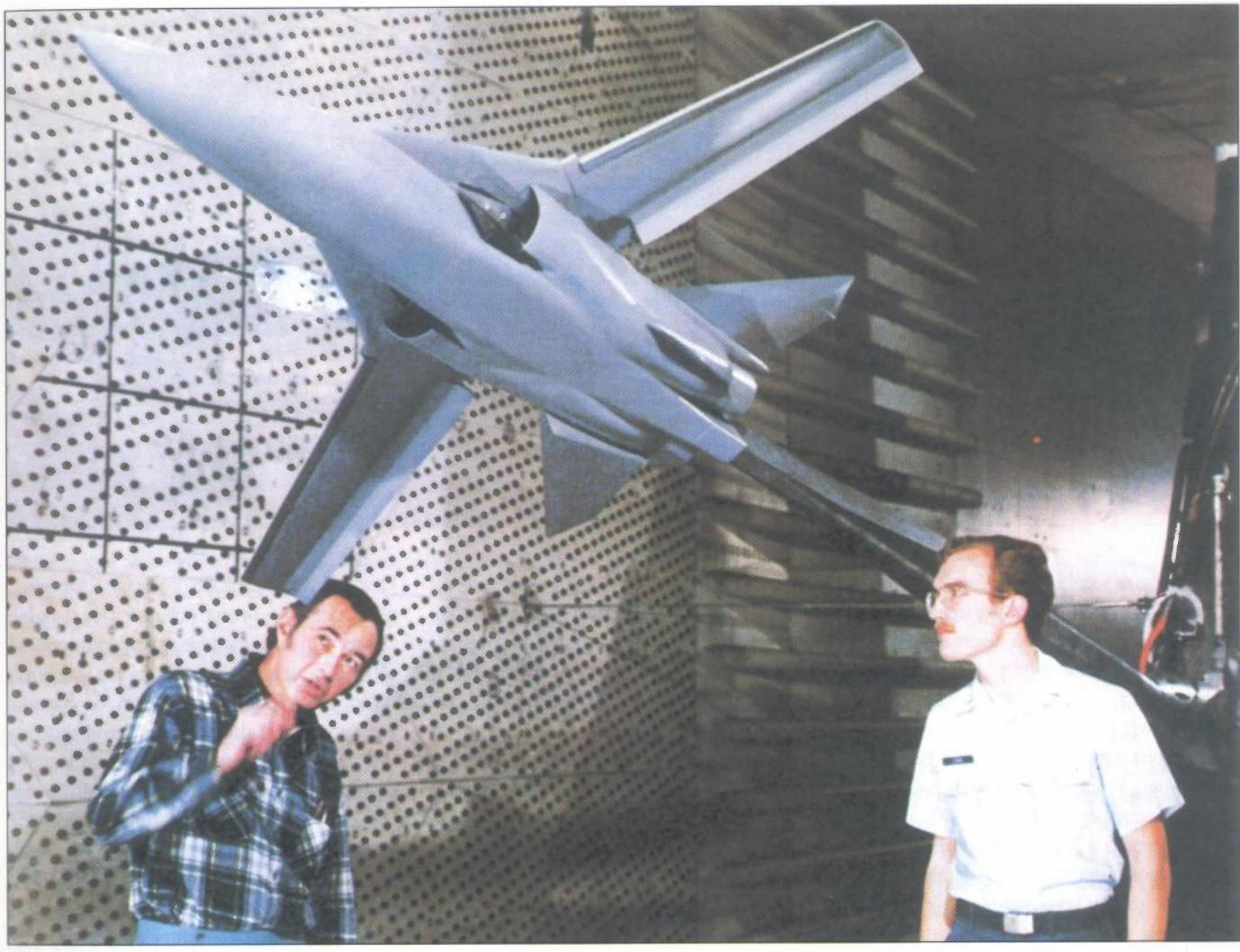
**Model F-111 opremljen MAW-om snimljen tijekom ispitivanja ponašanja pri nadzvučnim brzinama u zračnom tunelu**
