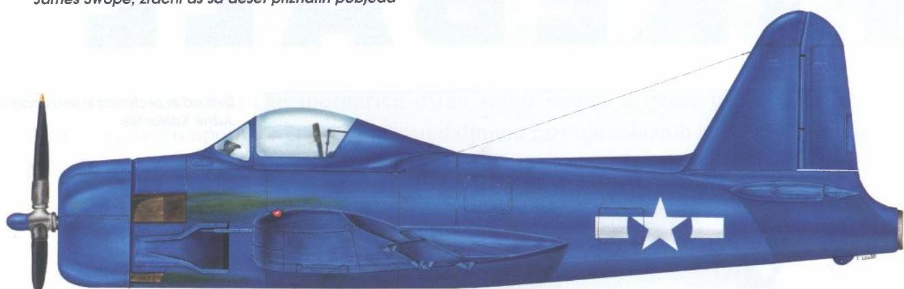
XFR-4, preinačeni FR-1 (Bu.No.39661), korišten kao platforma za ispitivanje mlaznog motora Westinghouse J34
