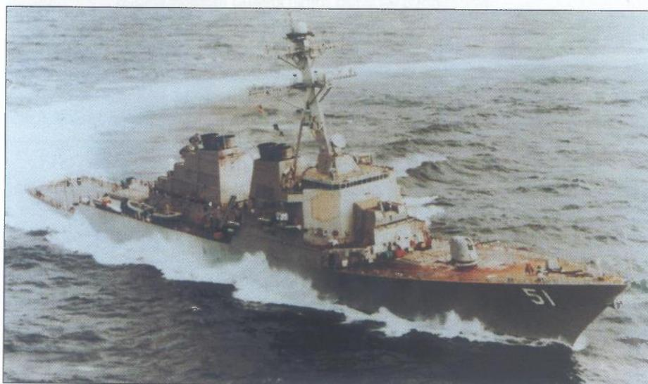
Američki razarači klase Arleigh Burke opremljeni su borbenim sustavom Aegis, sustavom za električno ratovanje AN/SLQ-32 i sustavom za blisku obranu broda Vulcan Phalanx
