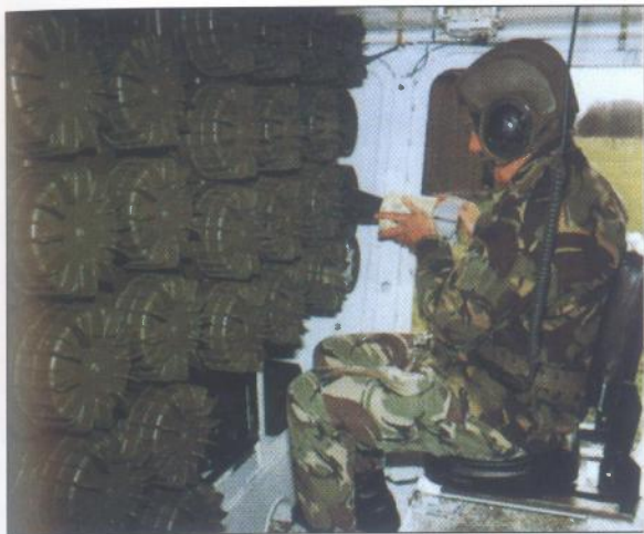
Smještaj granata kalibra 120 mm i način manipulacije
