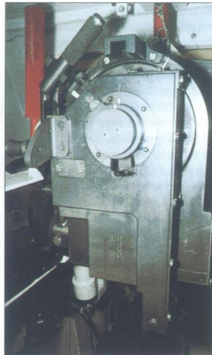
Punjenje cijevi se obavlja kroz zavojni zatvarač njihajućeg tipa
