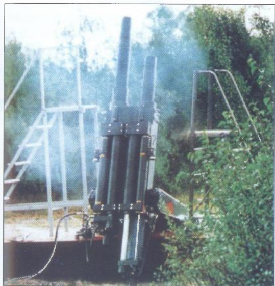
Detalj ispitivanja dvocjevnog minobacača 120 mm (Bofors). Ispitivanja su obavljena u cilju ugradnje na MTLB podvozje
