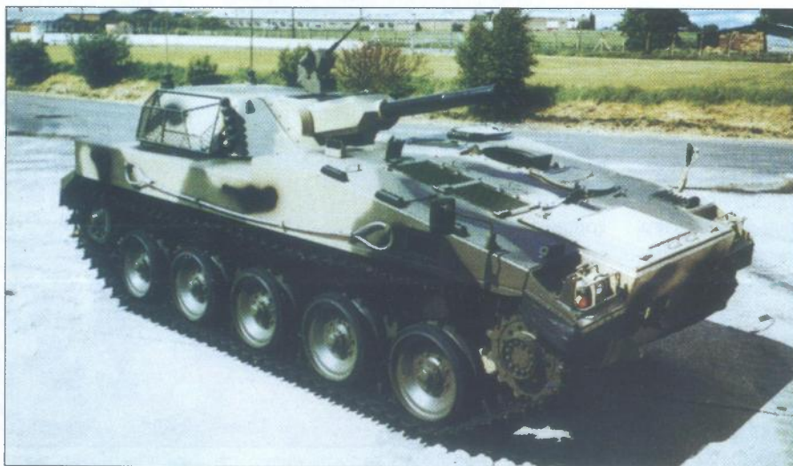
Jedan od britanskih protutipova RO 2003 iz 1986. godine naoružan minobacačem kalibra 120 mm. Podvozje je iz obitelji vozila RO 2000, mase 18 t, koje je predviđeno za proizvodnju u 20 izvedenica mase 15 do 25 tona u funkciji "nosača" oružja i vozila logističke potpore
