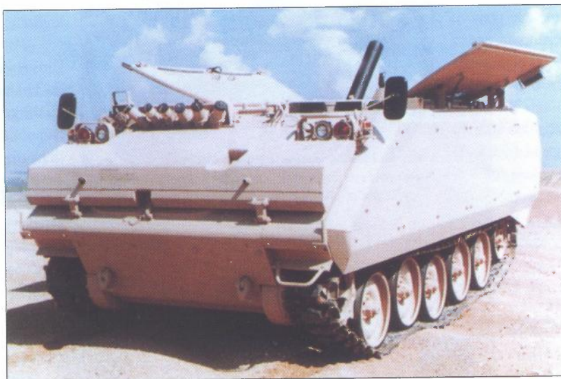
FMC-NUROL je ponudio ugradnju minobacača kalibra 120 mm ožlijebljene cijevi 2R2M na oklopno vozilo M113
