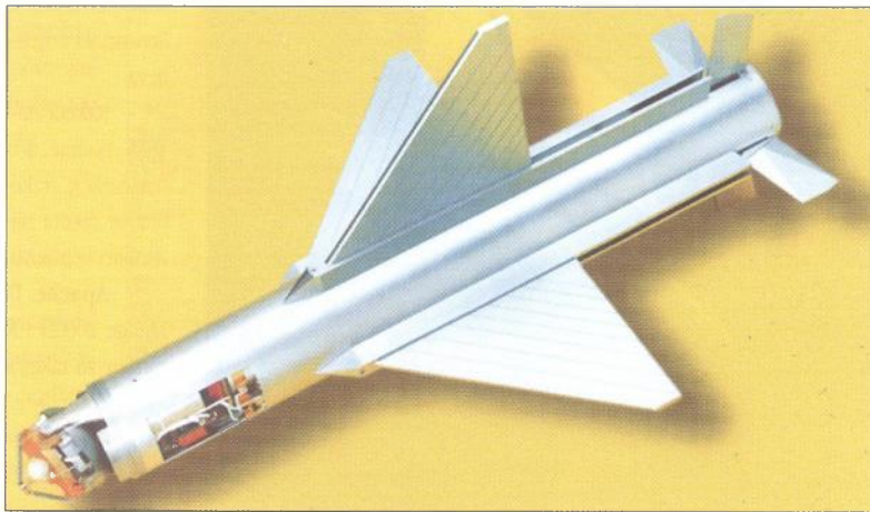
Na slici je prikazano substreljivo koje se samonavodi u posljednjoj fazi leta a razvijeno je u okviru programa MLRS Phase 3 za višecijevni lanser raketa (engl., MLRS - Multiple Launch Rocket System)
