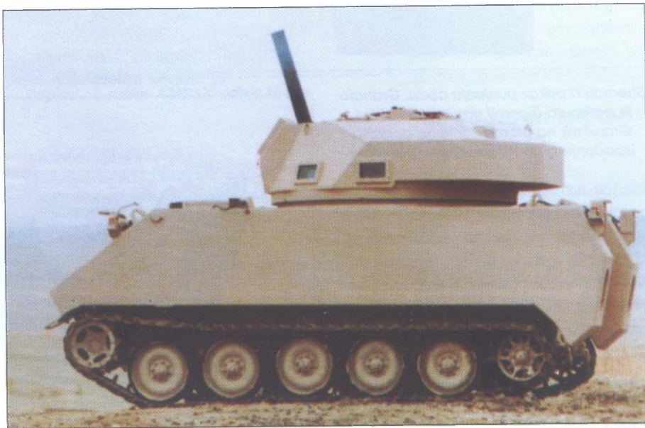
FMC-NUROL također nudi minobacač Mauser s glatkom cijevi kalibra 120 mm u kupolnoj nadgradnji oklopnog vozila M113
