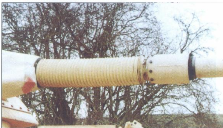
Detalj cijevi sustava AMS. Uočljiv je sustav za izvlačenje barutnih plinova iz cijevi oružja
