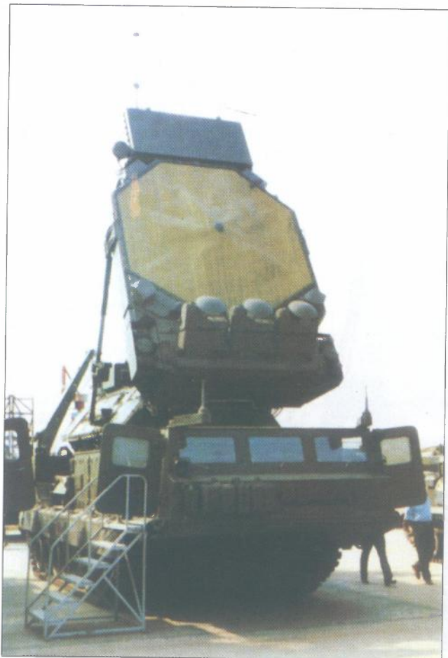
Mnogokanalna radarska postaja za vođenje raketa 9S 32-1 precizno izračunava koordinate cilja, prati ga, lansira rakete i motri prostor oko sebe na ekstremno malim visinama
