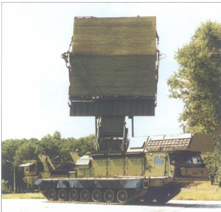
Motrilačko akvizicijski radar kružnog motrenja 9S 15MT je brigadno temeljno sredstvo za otkrivanje zrakoplova i drugih zračnih ciljeva
