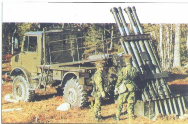
Četverocijevni minobacač 120 mm SM-4 "salvo" austrijskog proizvođača Noricum. Austrijska vojska je svojedobno podržavala razmišljanje o uvođenju SM-4 kao zamjenu za postojeće haubice 105 mm M101, budući da je domet sustava u području 12÷14 km
