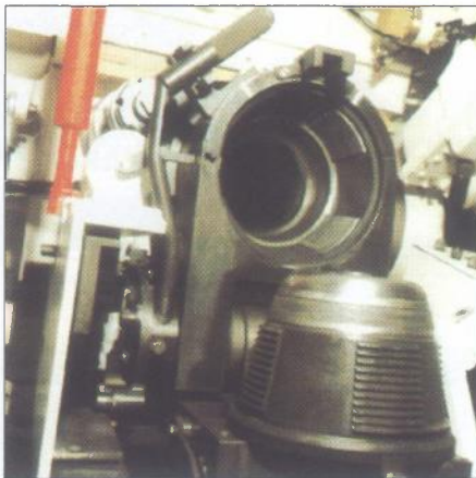
Punjenje cijevi se obavlja kroz zavojni zatvarač njihajućeg tipa
