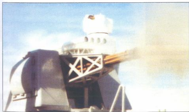
U kompleksnom sustavu SAMOS tvrke Sagema integriran je elektrooptički sustav s IC kamerom i to na zajedničkoj platformi s topom
