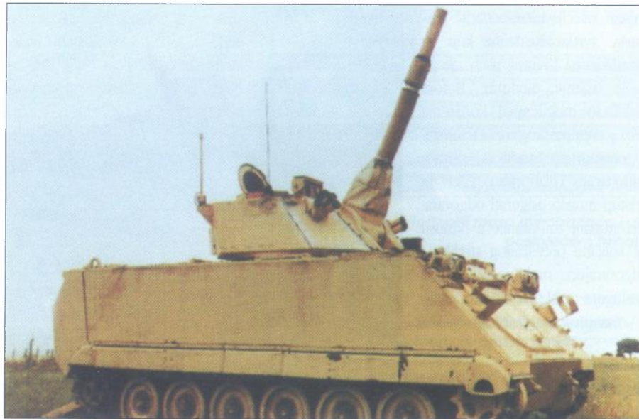
Armoured Mortar System (AMS) ugrađen na gusjenično lako oklopno vozilo MTVL. Vozilo je modificirani transporter M113 kojemu je modernizirana pogonska skupina i sustav ovjesa, a korisna nosivost povećana za 30 posto što omogućuje prevoženje 50 granata kalibra 120 mm u bojnom kompletu. Sustav je razvijen za predstavljanje kupcima Srednjeg istoka. Radi se o kupolnoj izvedenici minobacačkog sustava kakav je ugrađen na lako oklopljeno vozilo LAV 8x8 General Motors
