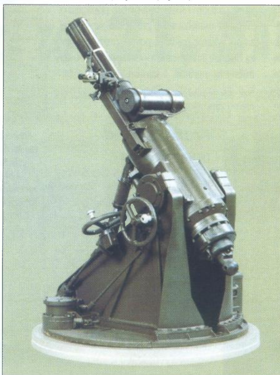
Izraelski minobacač 120 mm RMS6 (Recoiling Mortar System). Prilagođena verzija minobacača K-6 u kombinaciji s protutrzaćim sustavom što omogućuje ugradnju minobacača na mobilno podvozje
