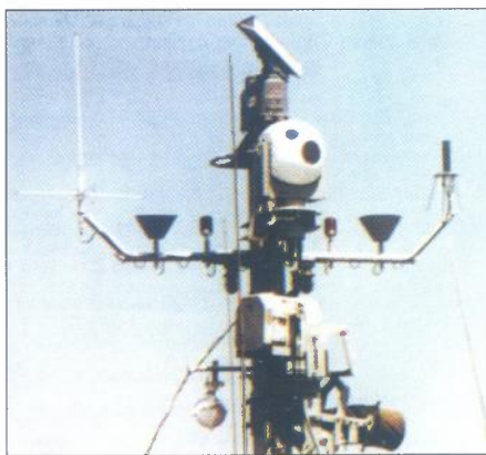
Protežnosti i masa izraelskoga elektrooptičkog sustava, a koji ima FLIR, TV i laserski daljinometer omogućuju njegovo montiranje i na jarbol broda
