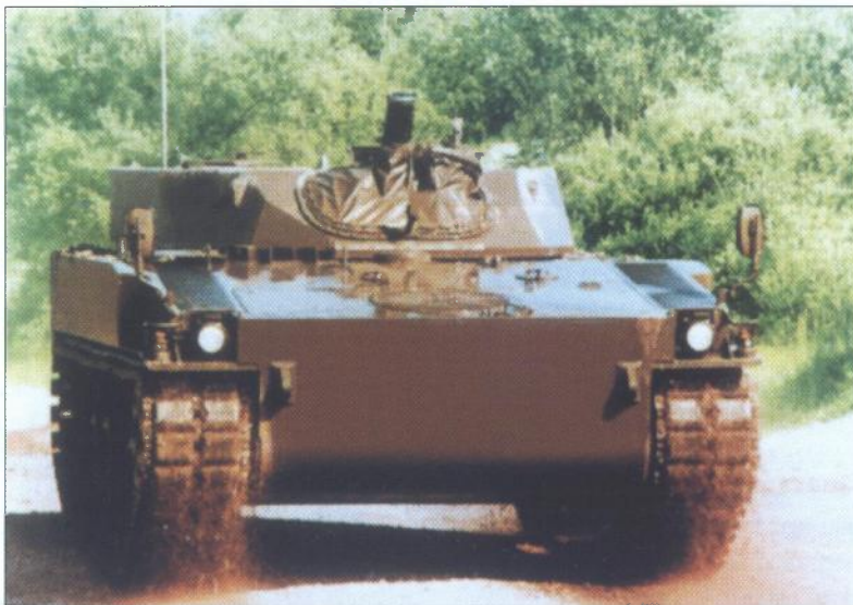
Minobacački sustav Diehl kalibra 120 mm. Minobacač kalibra 120 mm ugrađen je u gusjenično vozilo Puma. Sustav je potpuno operativan u uvjetima ABK opasnosti
