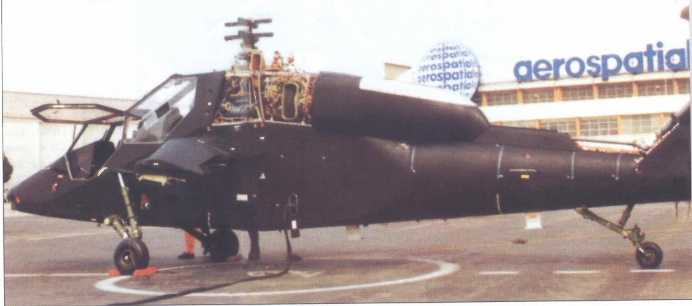
Pogonska skupina Tigera sastoji se od dva motora MTR 130, svaki najveće snage 1160 kW
