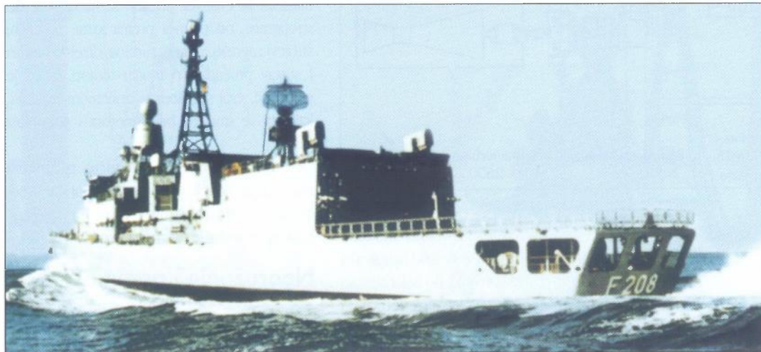
Lanseri sustava RAM (na krovu hangara) prvo su ugrađeni na fregatu Niedersachsen (F 208)
