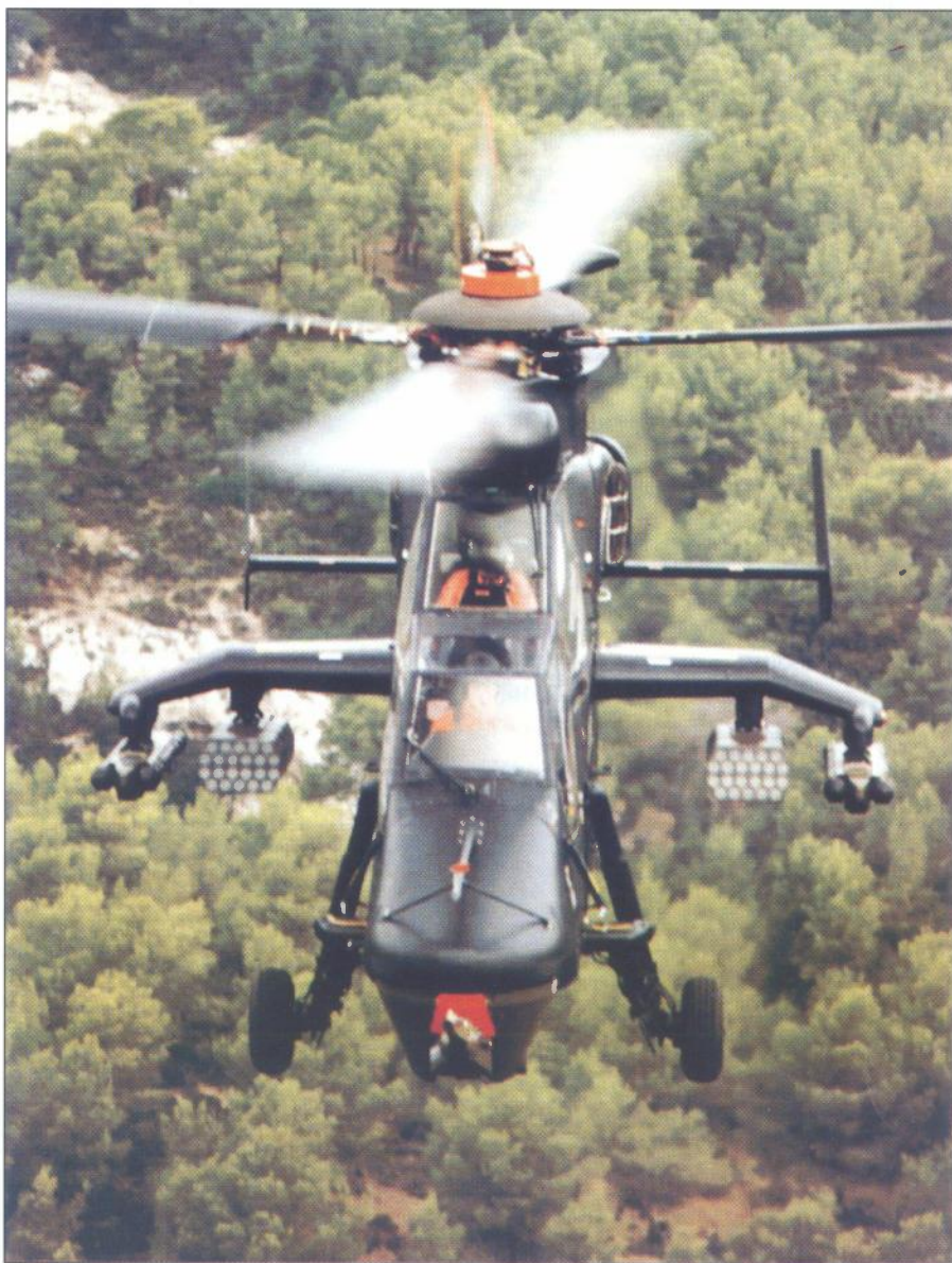
Snimak prednjeg dijela Tigera pokazuje koliko je njegov trup uzak; danas je to standardna karakteristika borbenih vrtoleta, kojom se smanjuje njihova izloženost protivničkoj PZ paljbi
