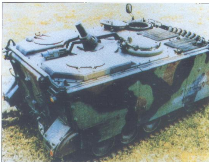
Jedan od prijedloga ugradnje minobacača kalibra 120 mm na podvozje američkoga oklopnog transportera M113. Ovakvo je rješenje Rheinmetall prikazao u listopadu 1990. godine. Postoji mogućnost modularne ugradnje i u druge tipove vozila. Na slici je prikazan sustav VAMS Rheinmetall 120 mm
