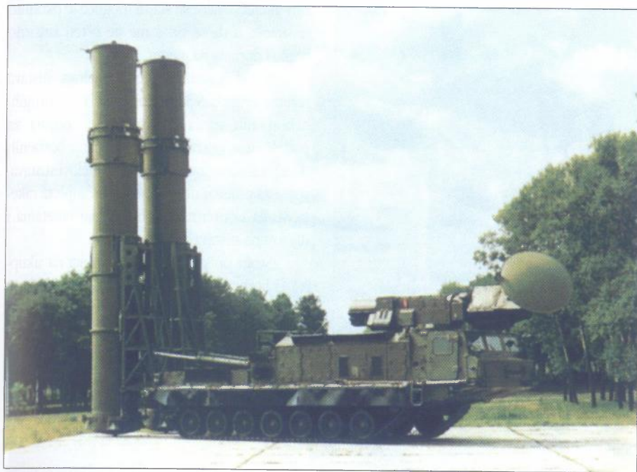
Temeljni lanser 9A 82 nosi po dvije rakete 9M 82. Iznad kabine vozila je antena radara za osvjetljavanje cilja
