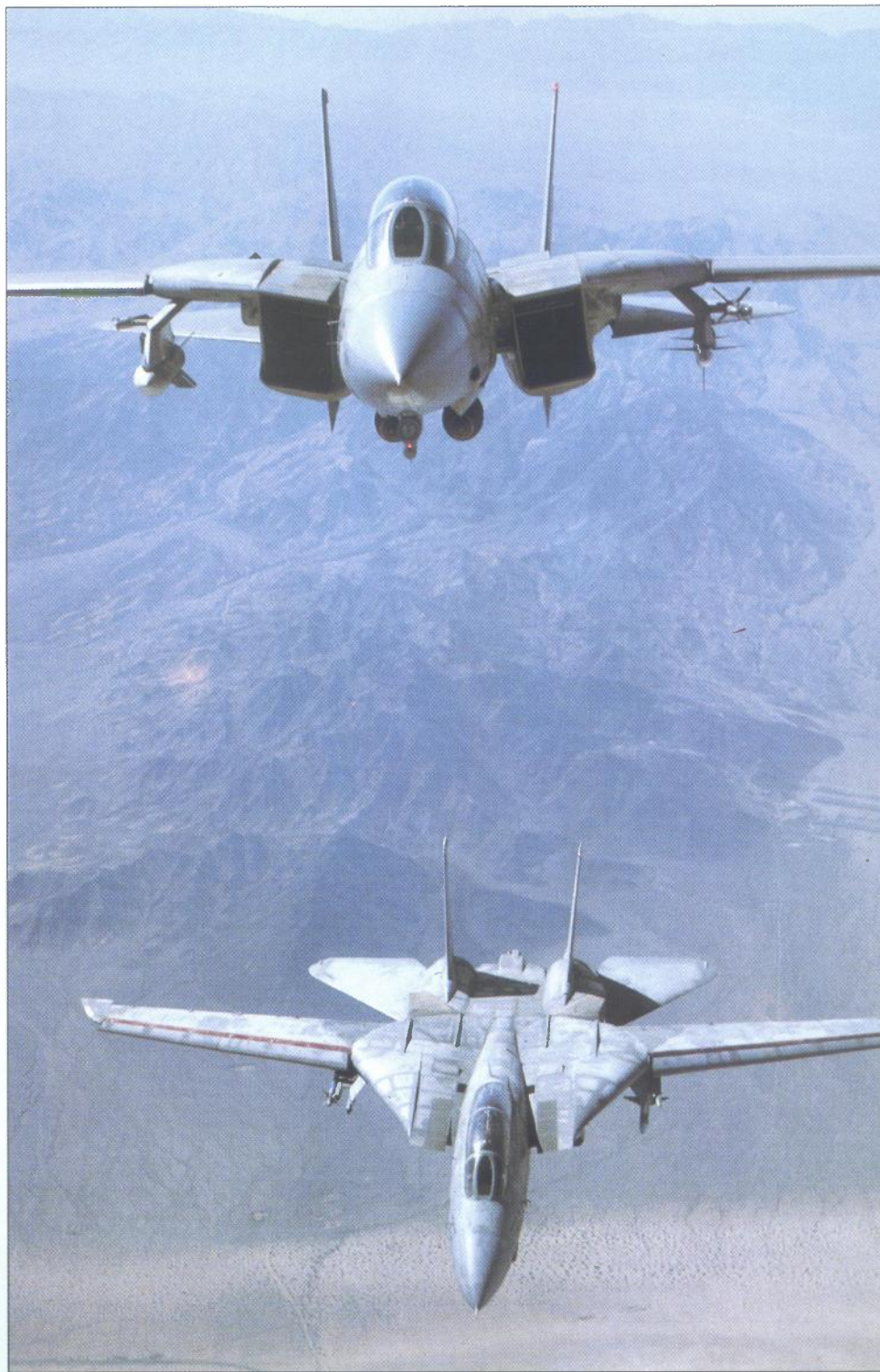
Američki mornarički lovac F-14 Tomcat ima sustav za automatsku kontrolu, koje omogućava kontinuirano podešavanje kuta krila, ovisno o uvjetima leta
