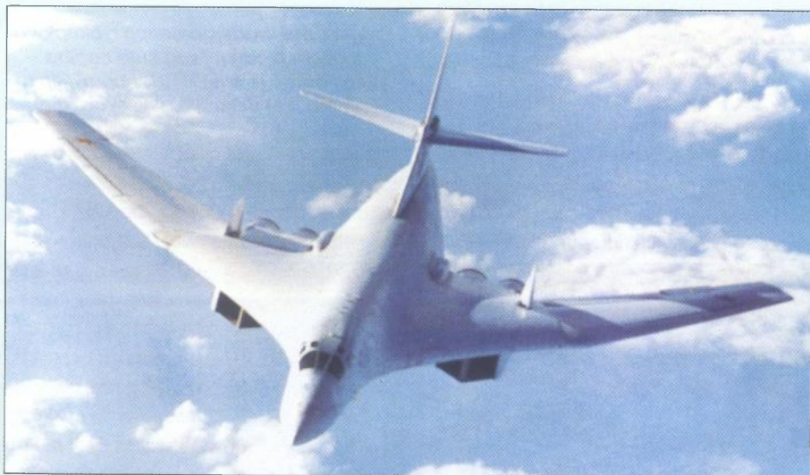
Koncept SW primjenjiv je i na strateške bombardere, poput ruskog Tupoljeva Tu-160, posebice stoga što omogućava prilagodbu strijele krila promjenjivim uvjetima leta (npr., krstarenje na velikim visinama, a zatim spuštanje na male visine radi proboja protivničke PZO), a time i smanjuje potrošnju goriva pri radu pogonske skupine i povećava domet
