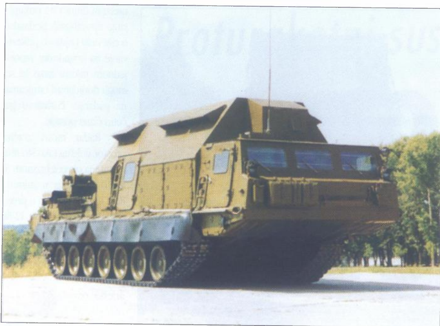
Brigadno zapovjedno mjesto 9S 457-1 prikuplja i obrađuje podatke o ciljevima u zraku i raketnim bitnicama dodjeljuje ciljeve za gađanje
