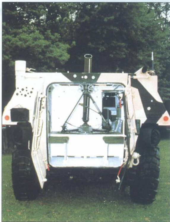
Francuski samovozni minobacački sustav VAB VPM 81 naoružan minobacačem kalibra 81 mm postavljenim u oklopno vozilo VAB
