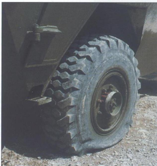
*Start LOV 4x4, s oštećenim pneumatikom sigurnosnog kotača*
