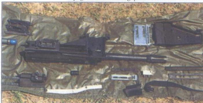
*Izgled rasklopljenog bacača Mk 19. Bacač se rasklapa na 17 podsklopova pri čemu nije potreban nikakav poseban alat*
