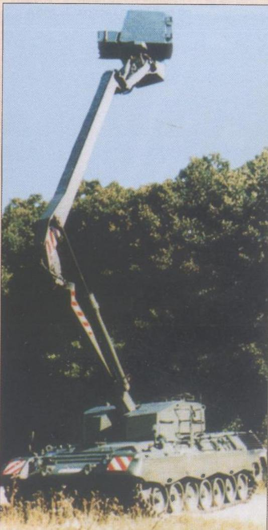
može biti integriran na kopneno vozilo - tank, i da rakete mogu biti ispaljene s podižućom platformom bez ljudi ("unmanned"). Ovo je mjesto gdje njemački TVT ulazi u igru. Njegova konstrukcija zadržava sva značajna svojstva bivšeg projekta Panther, ali sada kao integralni dio TRIGAT programa, koji je upisan kao Ground Trial Carrier (vozilo za terenska ispitivanja).
