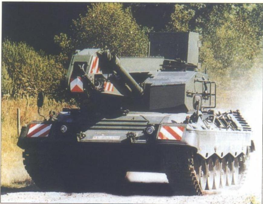
**TVT trilateralno vozilo "demonstrator" na podvozju tanka Leopard 1 na terenskom ispitivanju mobilnosti, Wegmann, Kassel 1994.**
