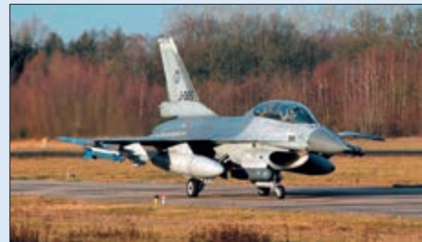
ču kako je jedna bitna činjenica utjecala na odabir RecceLite sustava. A to je mogućnost integriranja podvjesnika na uvodnik zraka, te time nije „potrošena“ jedna od potkrilnih, odnosno podtrupnih točki za nošenje tereta. Uz Zeiss Elektronik na nizozemskom natječaju natjecao se i Lockheed Martin sa svojim Pantera izvidničkim sustavom.
