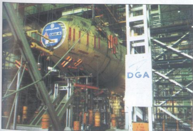
Certifikacijski testovi za Airbus A340 u CEAT-u
