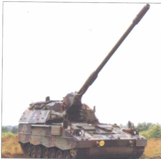
Panzerhaubitze PzH 2000. Danas najmoderniji samovozni topnički sustav na svijetu koji među prvima ima ugrađenu topovsku cijev dužine 52 kalibra za mogućnost dometa većeg od 40 km
