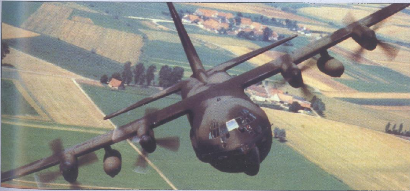
USAF-ovo zapovjedništvo za specijalne operacije u svom sastavu ima posebno modificirane zrakoplove i vrtotele. Na slici je jedna od specijalnih verzija transportnog zrakoplova Hercules, MC-130E Combat Talon
