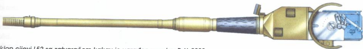
Sklop cijevi L52 sa zatvaračem kakav je ugrađen u sustav PzH-2000
