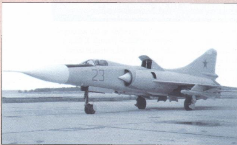
Model 23-01, pokušaj kombiniranja VG-a s STOVL-om
