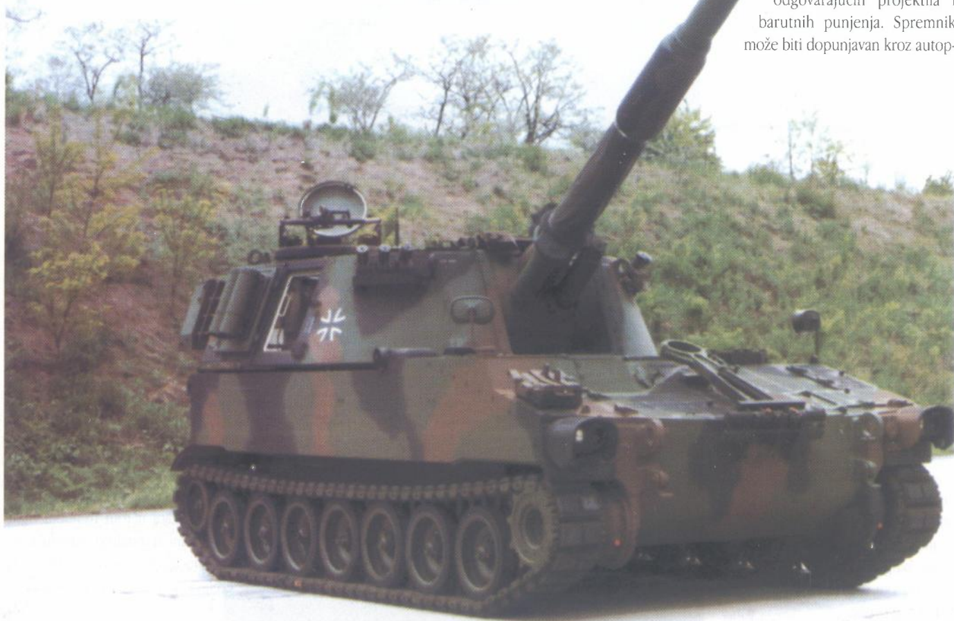
Samovozni topnički sustav M109A3G. Riječ je o njemačkoj izvedenici američke haubice M109. Glavno obilježje je ugradnja kliznog zatvarača na cijev dužine L39. Danas se planira zamjena ovog sustava (600 sustava) s modernijim sustavom PzH 2000
