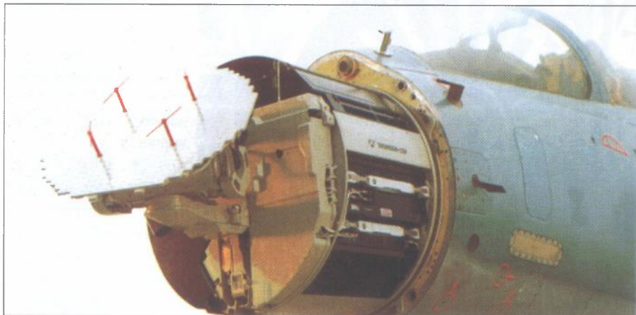
Na slici je prikazan novi radar za nadzor paljbe pod nazivom RDY s novom skenirajućom antenom
