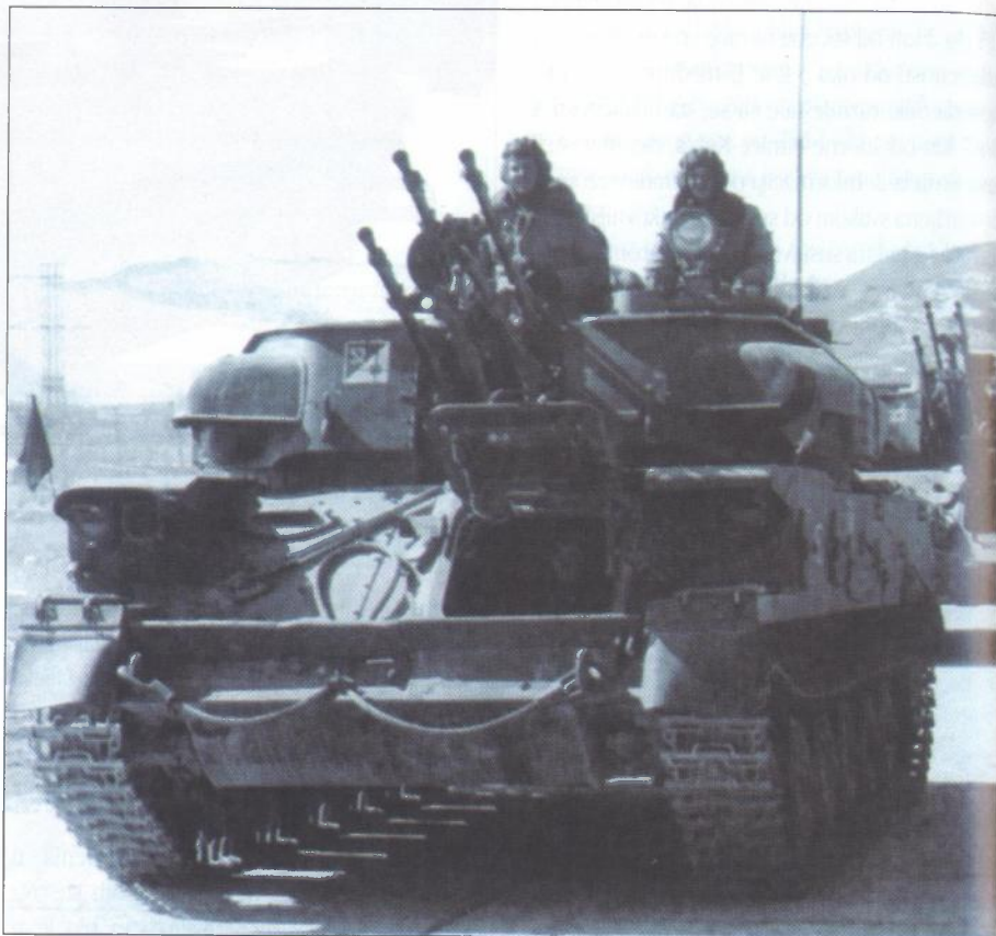
U Afganistanu su Šilke upotrebljavane za pružanje paljbene potpore kopnenim postrojbama pri obrani konvoja; kako im u ovoj ulozi nije trebao radar, on je uklonjen (na njegovo mjesto smješteno je dodatno streljivo za topove)
