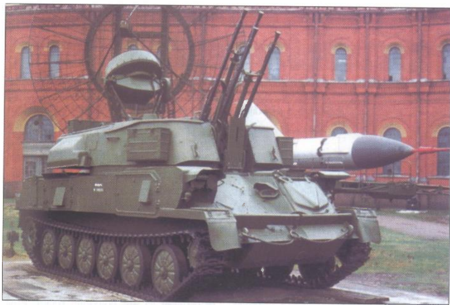
Prednji pogled na ZSU-23-4V model 1968; najčešća verzija ranih primjeraka Šilke, ima znatno povećano pokrivalo otvora za hlađenje na lijevom boku kupole. Mijenjanje veličine otvora za hlađenje na ranim primjercima Šilke proizišlo je iz problema s intenzivnim nastajanjem topline u elektronskim cijevima
