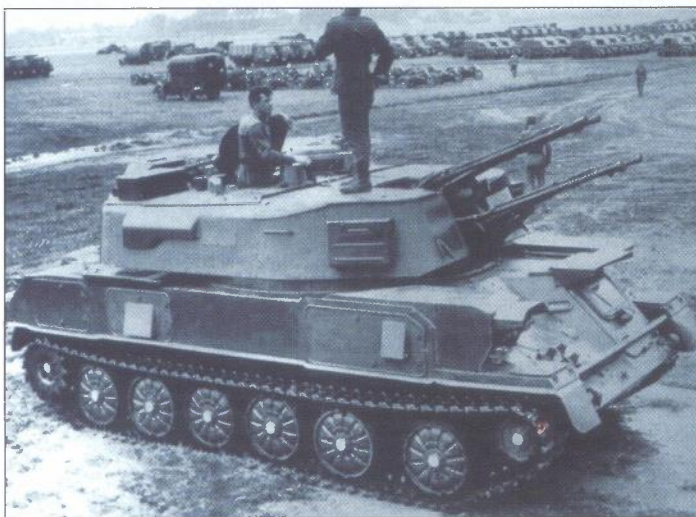
Primjerak Šilke s početka proizvodnje u sastavu poljskih oružanih snaga. Na ovoj verziji vidi se pokrivalo otvora za hlađenje na desnoj strani kupole, koji je manji u usporedbi s otvorom na kasnijim vozilima
