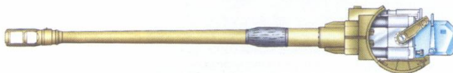
Sklop Rheinmetallove cijevi L39 s kliznim zatvaračem kakva je ugrađena u sustav M109A3G
