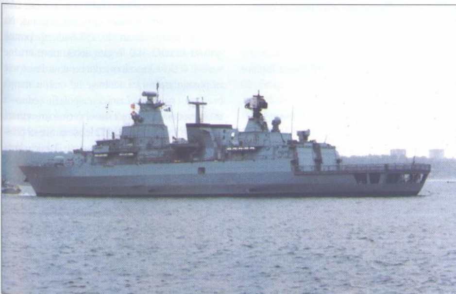
Na drugoj fregati tipa 123, Schleswig-Holstein, na stražnjem jarbolu uočljiva je velika antena motrilačkog radara LW 08
