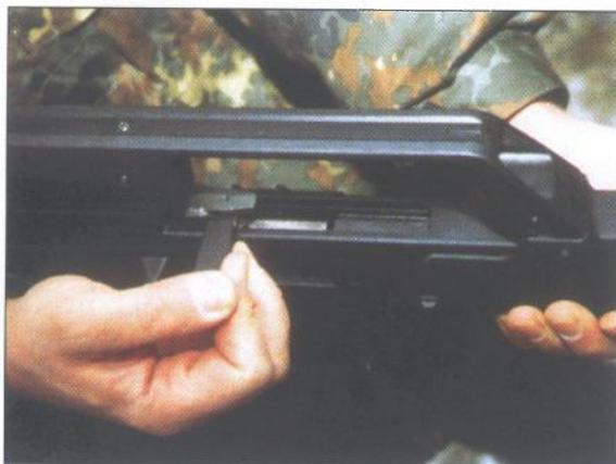
*Ručica za zapinjanje zatvarača može se zakrenuti u desnu (na slici) ili lijevu stranu. Na taj način zapinjanje postaje podjednako jednostavno i ljevacima i dešnjacima*
