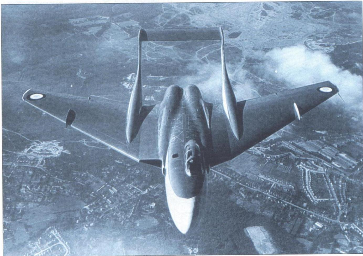
*Drugi prototip WG240; pored pilotske kabine vidi se mali prozorčić operatera radara*
