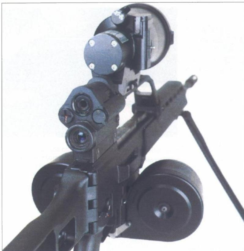
*Pogled na puškostrojinicu MG36 sa stražnje strane. Uočava se optički ciljnik za dnevno gađanje, ciljnik-kolimator, pasivni ciljnik za noćno gađanje, te spremnik u obliku dvostrukog bubnja kapaciteta sto metaka*
