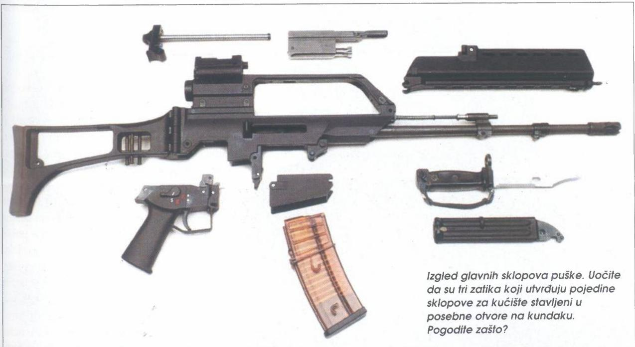
*Izgled glavnih sklopova puške. Uočite da su tri zatika koji utvrđuju pojedine sklopove za kućište stavljene u posebne otvore na kundaku. Pogodite zašto?*
