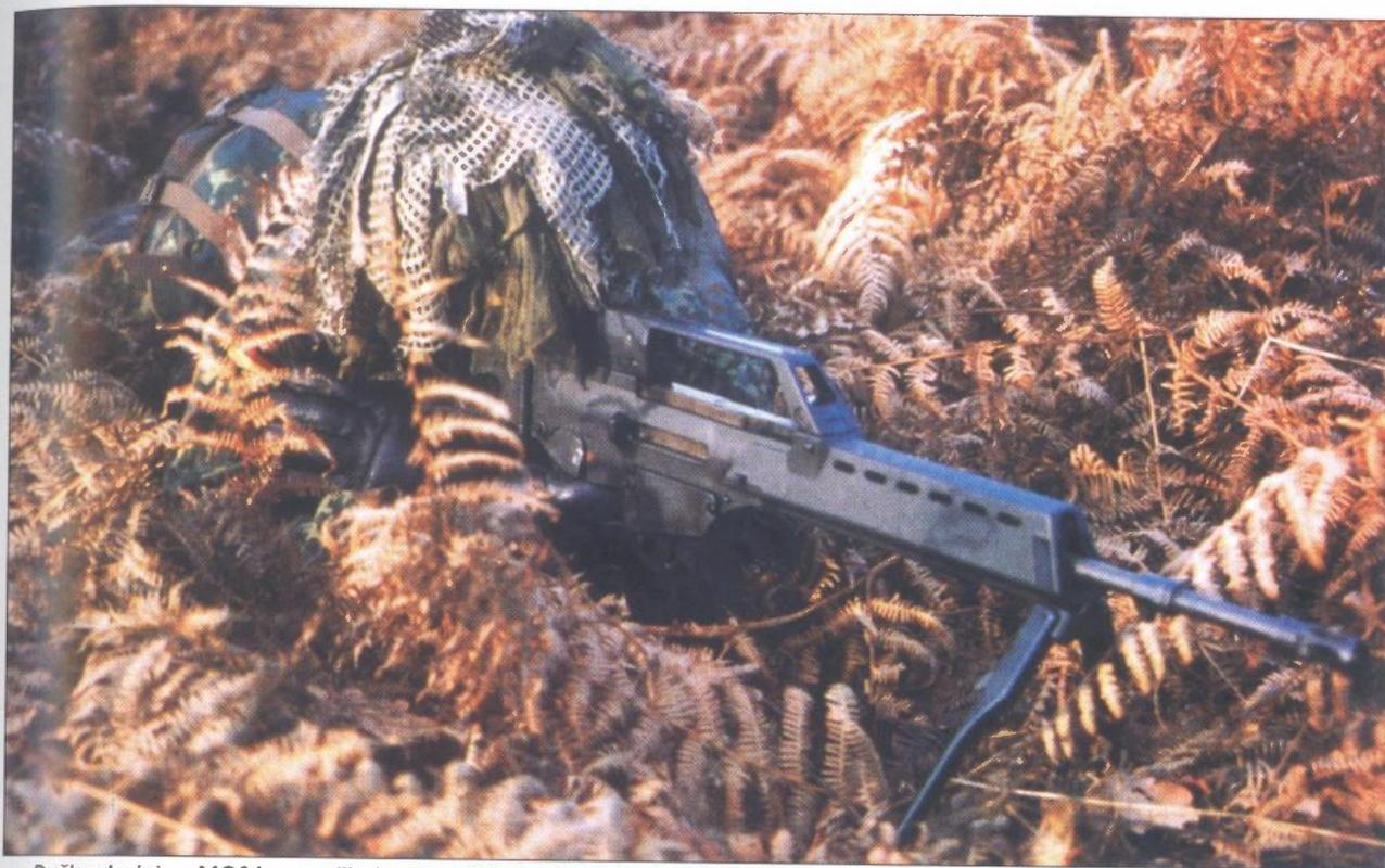
**Puškostrojnica MG36 se razlikuje od puške G36 po masivnoj cijevi i nožicama, te mogućnosti da se umjesto spremnika od 30 metaka koristi spremnik većeg kapaciteta**
