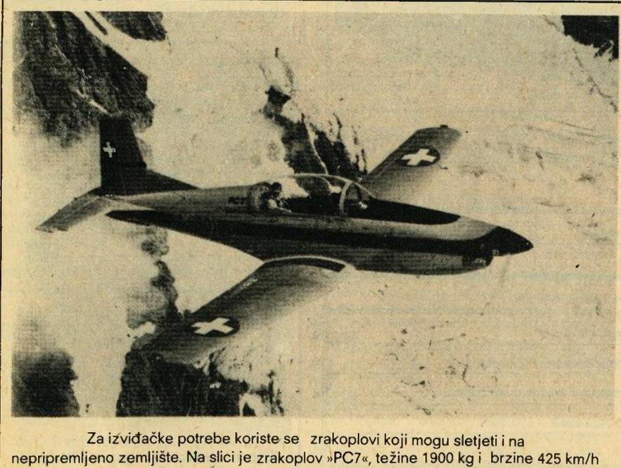
Za izviđačke potrebe koriste se zrakoplovi koji mogu sletjeti i na nepripremljeno zemljište. Na slici je zrakoplov »PC7«, težine 1900 kg i brzine 425 km/h
