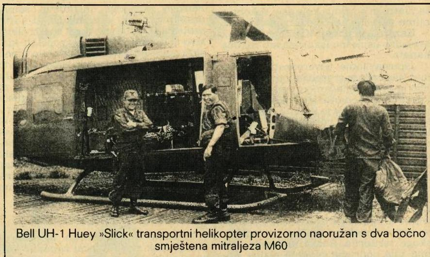
Bell UH-1 Huey »Slick« transportni helikopter provizorno naoružan s dva bočno smještena mitraljeza M60
