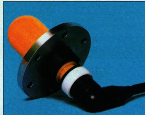
Jedan od hidrofona što se ugrađuju na trup podmornice za mjerjenje vlastitih zvukova
