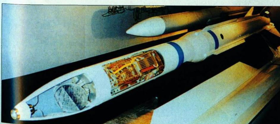
Opći izgled najnovije ESSM rakete s presjekom sustava za samonavodenje u nosnim sekcijama rakete: u samom nosu rakete je IC prijamnik sustava za pasivno samonavodenje, a iza njega vidljiva je prijamna antena sustava za poluaktivno radarsko samonavodenje
