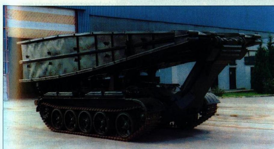
**Tank nosač mosta nakon remonta**
