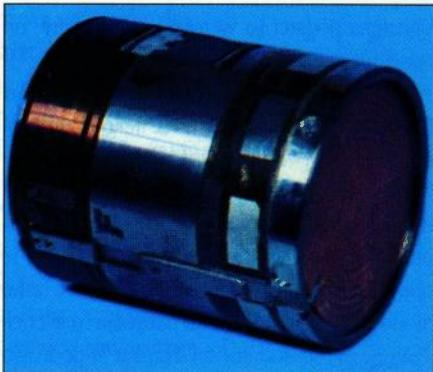
**Na slici je prikazano substrativno tvrtke Honeywell za projekt SADAR. Tražilo koje radi u milimetarskom valnom području pretražuje tlo iznad kojeg leti po modelu unutarnje spirale**
