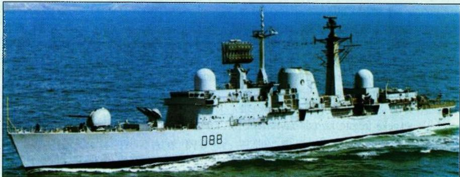
Prvom nizu razarača tipa 42 pripada i HMS Glasgow (D 88) na čijem se krovu nadgrađa iza kupole radara za upravljanje paljbiom Type 909 uočava velika antena motričkog radara Type 965M koji je kasnije zamijenjen radarom Type 1022
