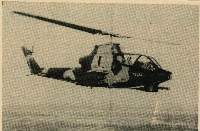
Prototip AH-1G Cobra sa uvlačnim skijama stajnog trapa
