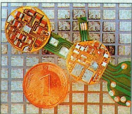
**Kompletna elektronika blizinskog upaljača DM 64 sastoji se uglavnom od četiri specijalna LSI čipa te nekoliko diskretnih elektroničkih elemenata. Straga se vidi wafer iz kojeg se izrezuju navedeni čipovi**
