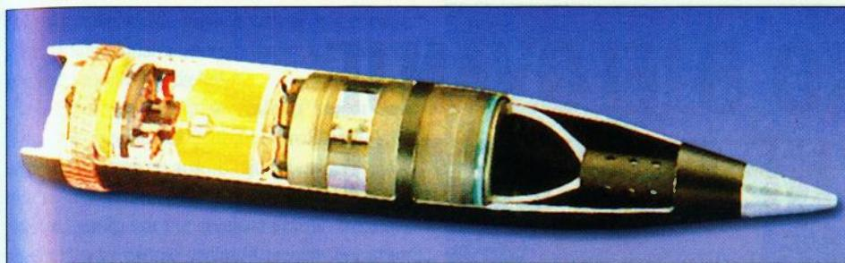
**Presjek 155 mm projektila-nosača substreljiva SMArt**
