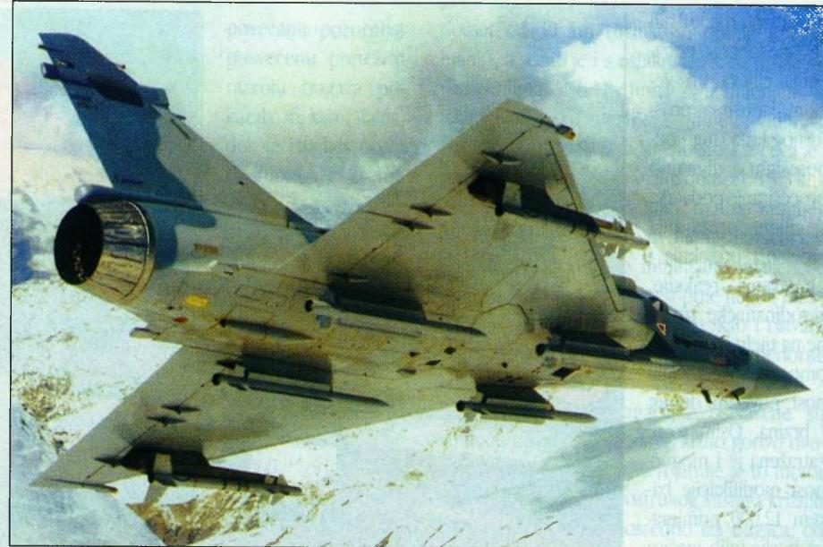
**Francuska Matra MICA** (na slici se vide četiri projektila na podtrupnim nosačima) pretstavlja zanimljiv hibrid kratko- i srednjedometnog projektila zrak-zrak
