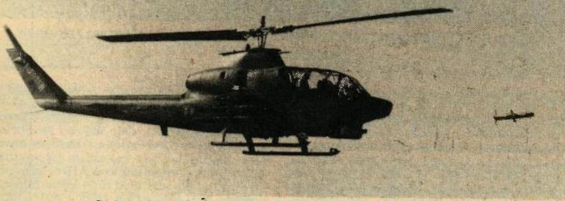
Cobra AH-1Q ispaljuje BGM-71A TOW projektil
