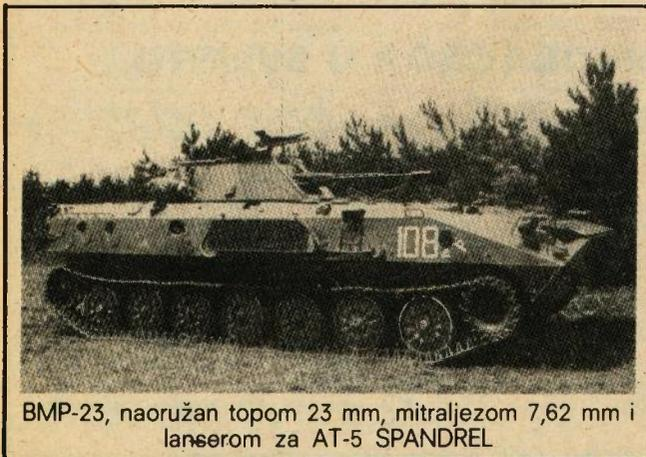
BMP-23, naoružan topom 23 mm, mitraljezom 7,62 mm i lanserom za AT-5 SPANDREL
