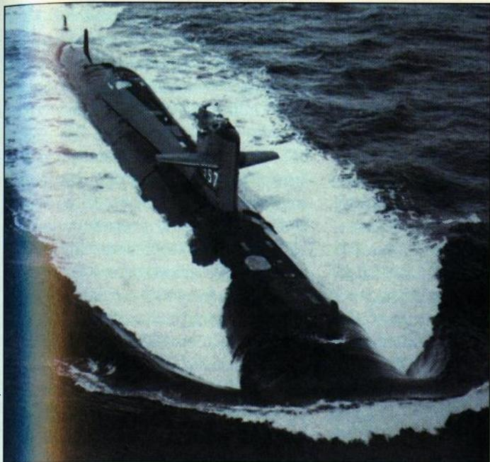
**Na USS Tullibee (SSN 597) bila je ugrađena turboelektrična propulzija**
