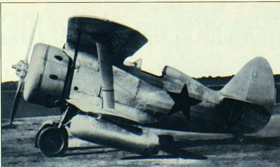
**I-153 opremljen motorima DM-4, koji je Merkulov rabio za ispitivanja 1940**
