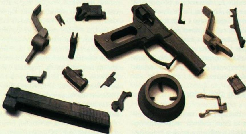
Dijelovi izrađeni tehnologijom mikroljeva
