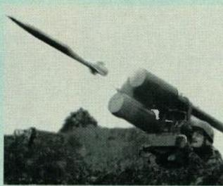
posebnu naprtnjaču za nošenje na ledima jednog poslužitelja tako da se lansirna cijev s raketom rasstavlja u dva dijela. Nakon spuštanja i zauzimanja paljbenog položaja ciljač spaja ta dva dijela u jednu cjelinu. Rasklapanjem lansirne cijevi i rakete u njoj stvoren je sustav kojem niti jedan dio nije duži od 1,1 m i s kojim je znatno lakše izvođenje desanta. Koliko je poznato to je jedina tako konstruirana inačica bilo kog LPRS PZO u svijetu.
