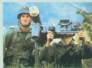
**IC pasivno samonavođenje s programiranim procesorom selekcije signala cilja**
