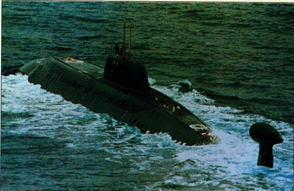
**Na vrhu krmnenog stabilizatora podmornice Projekta 671RTM klase Victor III nalazi se tegljeni sonar i drugi senzori**
