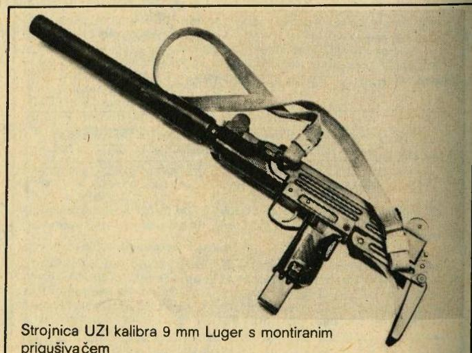
Strojnica UZI kalibra 9 mm Luger s montiranim prigušivačem
