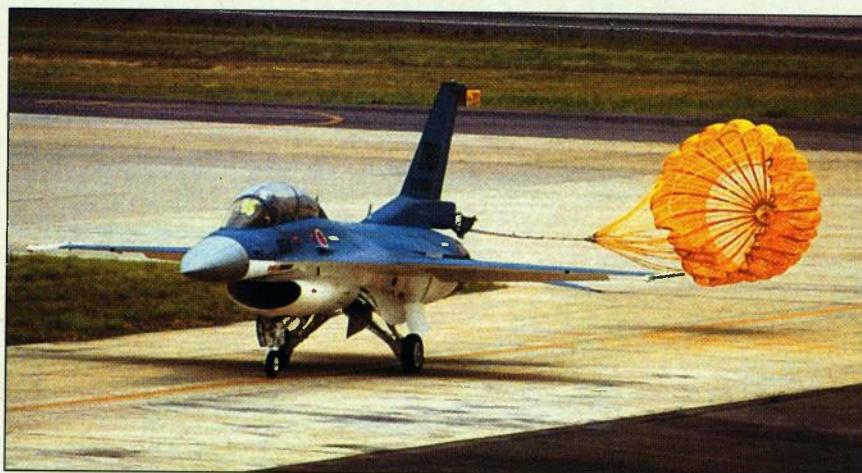
**F-2 nakon misije. Uočljiv je dvodjelni pokrov kokpita (nije primijenjen jednodjelni pokrov kao kod F-16, radi postizanja veće otpornosti na mogući sudar s pticama tijekom leta) i redizajnirani uvodnik zraka motora u čijoj su izradi primijenjena i RAM tvoriva**
