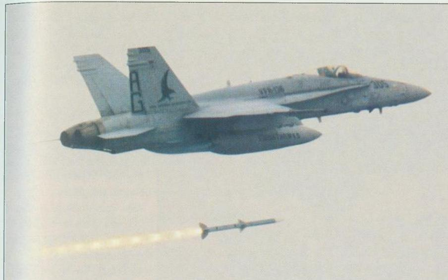
*Lansiranje projektila Hughes AIM-120 AMRAAM s F/A-18C Horneta. Tehnologije koje se razvijaju za nove BVR projektili omogućavaju i daljnje usavršavanje AMRAAM-a, npr. ugradnjom ramjet motora*
