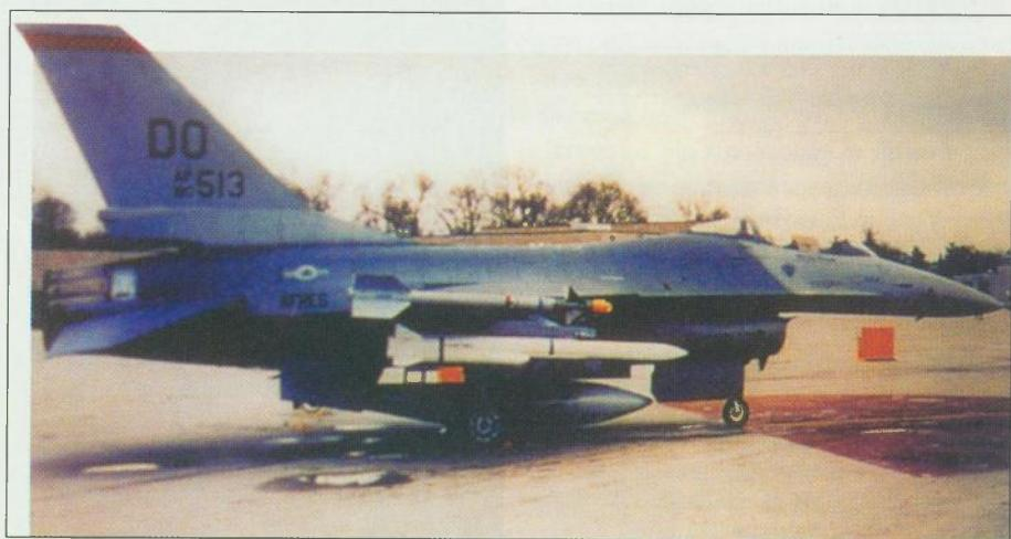
*U sklopu programa ARC nastavlja se razvoj VDRF tehnologije (koji traje već deset godina), koji bi u budućnosti mogao dovesti do razvoja projektila s kombiniranim pogonskom skupinom (startni raketni motor na čvrsto gorivo i putni ramjet motor), poput ovog modela prikazanog na potkrilnom nosaču F-16*
