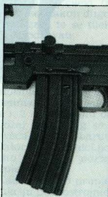
Osim bubenja od 100 metaka Ultimax 100 može se puniti i spremnik od 30 metaka
