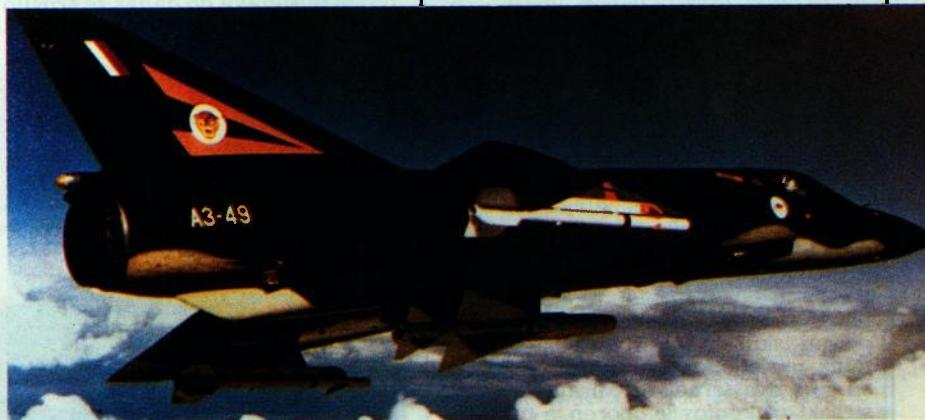
Mirage III O australskih zračnih snaga, naoružan sa dva vođena projektila zrak-zrak Sidewinder AIM-9B i jednim projektilom Matra R.530
