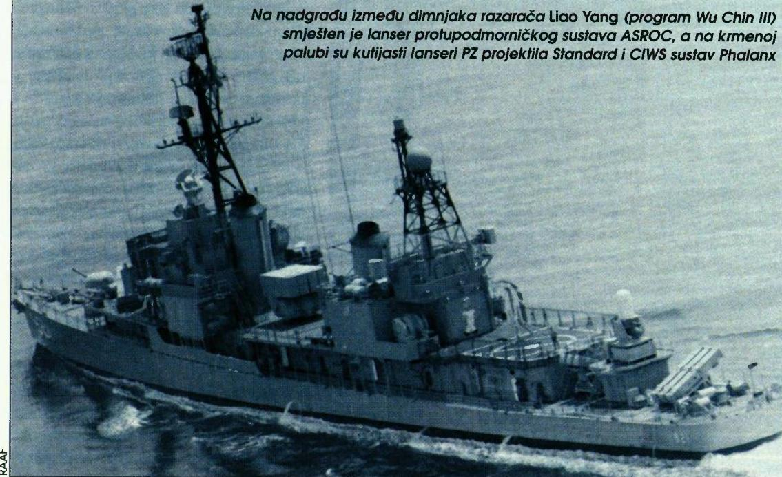
prostora Lockheed AN/SPS 40 ili AN/SPS 29 i radar za motrenje površine Elta EL/L-1040. Brodovi imaju sonar Raytheon AN/SQS 23H (osim razarača Dang Yang koji ima Atlas Elektronik DSQS-21CZ), a opremljeni su uređajima za električku borbu i bacačima chaff-ova Kung Fen 6. Ova četiri broda prebaćena su u 133. ophodnu eskadru, a *Lai Yang* (920) je u travnju ove godine imao sudar s fregatom *Feng Yang* (934).
