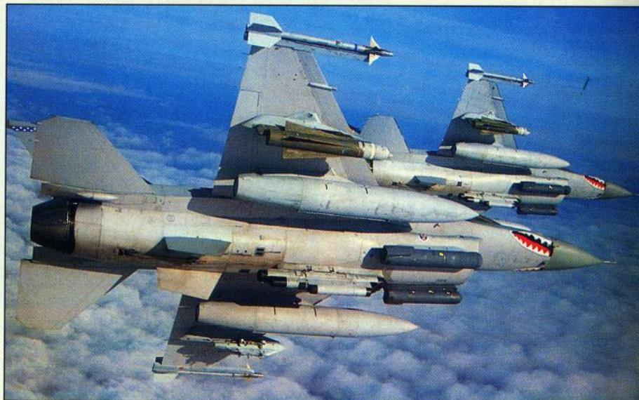
**Postavljanje navigacijsko-ciljničkog sustava LANTIRN na zrakoplove serije Block 40 omogućilo je pilotima Falcona izvođenje preciznih napadaja na kopnene ciljeve u svim vremenskim uvjetima, danju i noću (na slici su dva zrakoplova opremljena LANTIRN-om i projektilima AGM-65 Maverick)**
