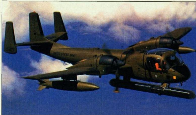
Jedan od prvih zrakoplova za nadzor bojišta, opremljen SLAR radarom bio je američki zrakoplov Grumman OV-1 Mohawk, uveden u naoružanje 1961.
