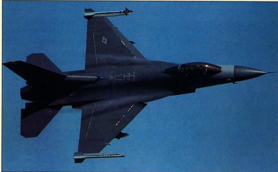
**F-16C Block 25 pri izvođenju manevra na maloj visini. Ovi zrakoplovi prvotno su bili opremljeni turboventilatorskim motorima F100-PW-200, ali kasnije su svi primjerici te serije dobili novije motore F-100-PW220/-220E**
