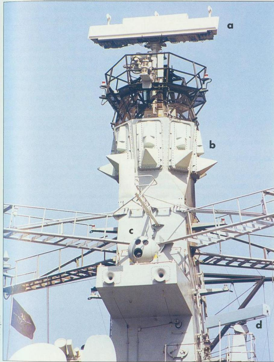
Vrh jarbola fregate HMS Northumberland: a) antena motričnog radara Type 996(1), b) antene sustava za elektroničku potporu UAF-1 Cutlass, c) optoelektronički sustav Sea Archer 30, d) navigacijski radar Type 1007
