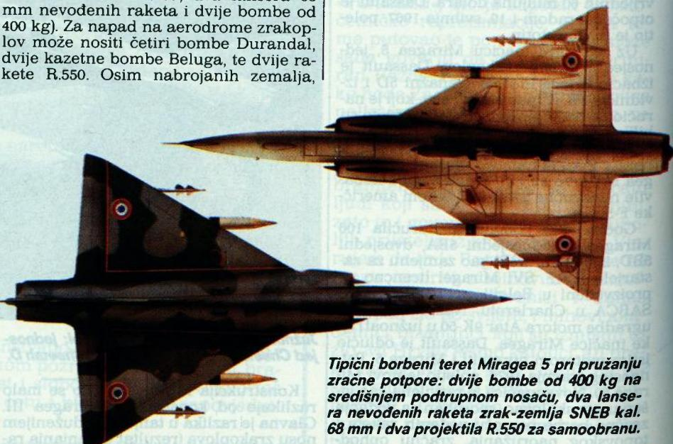
Tipični borbeni teret Miragea 5 pri pružanju zračne potpore: dvije bombe od 400 kg na središnjem podtrupnom nosaču, dva lansera nevodenih raketa zrak-zemlja SNEB kal. 68 mm i dva projektila R.550 za samoobranu.
