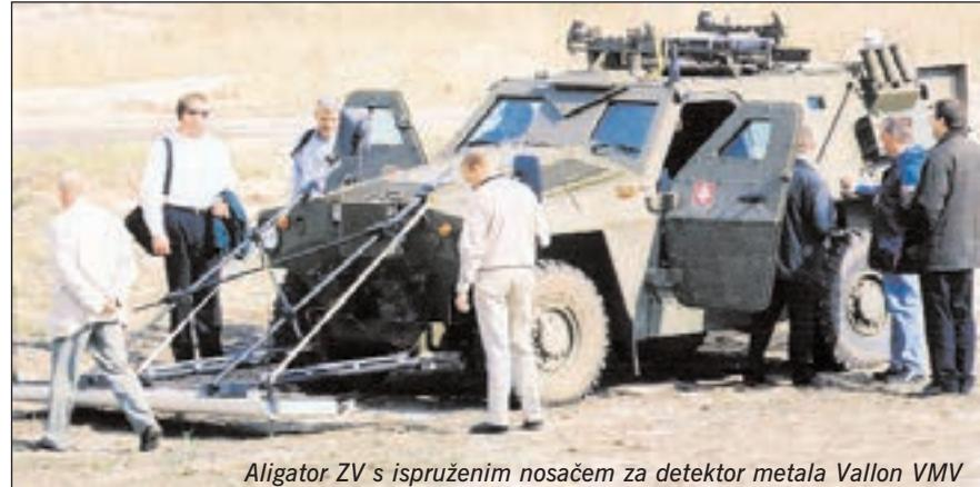
Aligator ZV s ispruženim nosačem za detektor metala Vallon VMV
