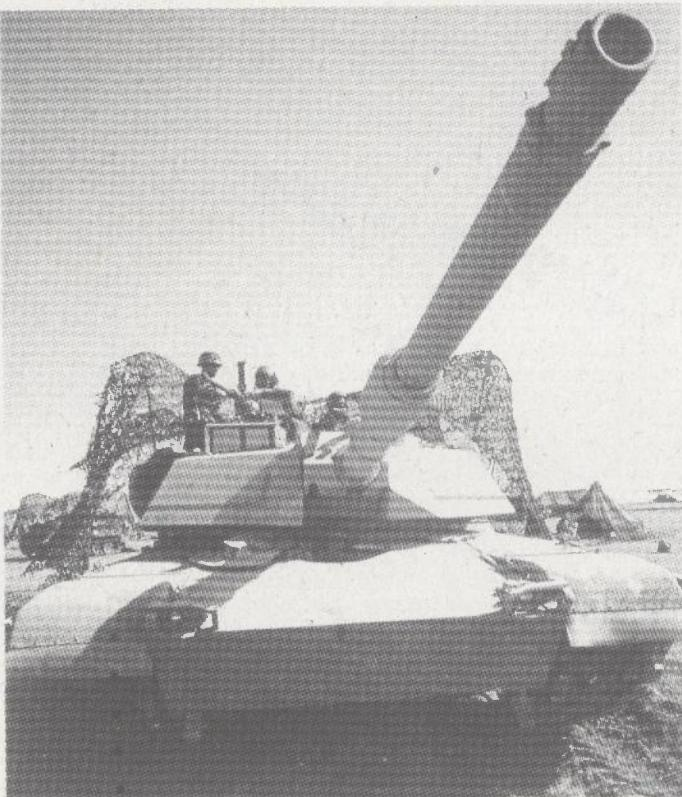
*Tank M1A1 za pogon ima ugrađenu plinsku turbinu koja ga čini mnogo tišim u odnosašu na tankove s ugrađenim diesel motorom*
