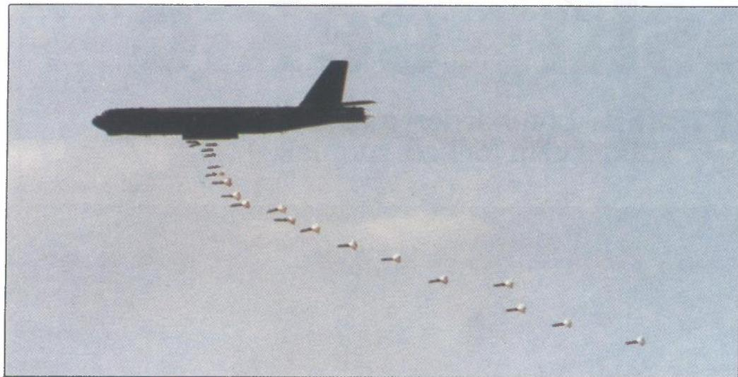
*B-52, razvijen kao bombarder za nošenje projektila opremljenih nuklearnim bojevim glavama. Također može obavljati misije koje zahtijevaju konvencionalno bombardiranje – na slici je prikazan B-52H kako izbacuje gomilu usporavajućih bombi*
