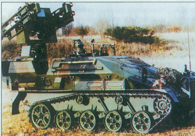
Četiri Stinger ili Igla rakete naoružanje su novog lakog oklopnog vozila Wiesel 2 namijenjenog njemačkim zračno desantnim snagama (gore je prototipski primjerak, a na donjoj slici serijski proizvedeno vozilo)
