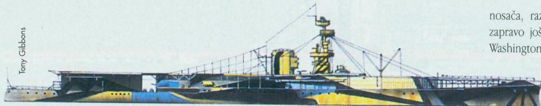
HMS Furious bio je postupno pregrađivan iz velike lake krstarice u nosač zrakoplova; prikazan je u stanju u kakvom je bio 1918.
