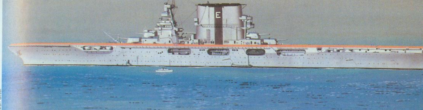
Nosač zrakoplova USS Saratoga (CV 3) građen je na temelju trupa otkazanog bojnog krstaša; uočljive su kule s topovima kalibra 203 mm
