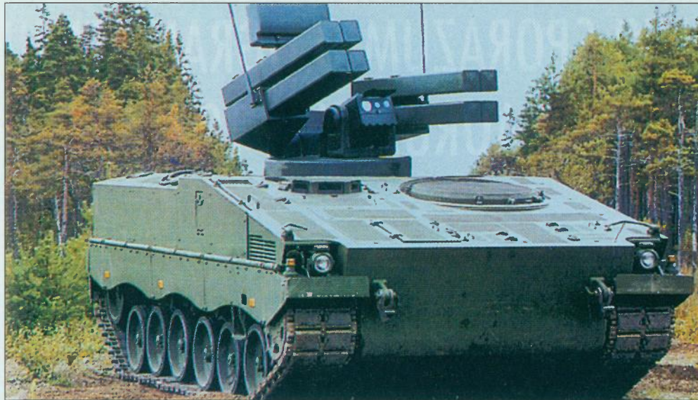
Švedska tvrtka Bofors eksperimentira s prototipom raketnog sustava BOSAM koji bi zajedno s borbenim vozilom CV 90 AD trebao štititi oklopno mehanizirane snage švedske kopnene vojske
