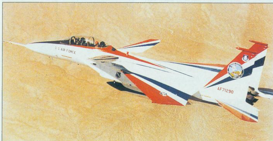
Druge prednosti uporabe vektorskog potiska, uz povećanu agilnost lovca, su i skraćivanje duljine piste pri uzlijetanju i slijetanju, te brzom usporavanju sa supersoničnih na subsonične brzine. Ti su rezultati postignuti s eksperimentalnim zrakoplovom NF-15B S/MTD
