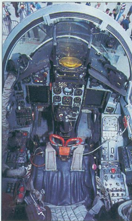
Kokpiti modernih lovaca pokazuju rezultate postignute u zadnjih 20-ak godina, usmjerene na olakšavanje opterećenja pilota pri letu i borbi. Na primjeru kokpita MiG-29M vidi se postignut napredak u odnosu na lovce koji su ušli u naoružanje u šezdesetim i sedamdesetim
