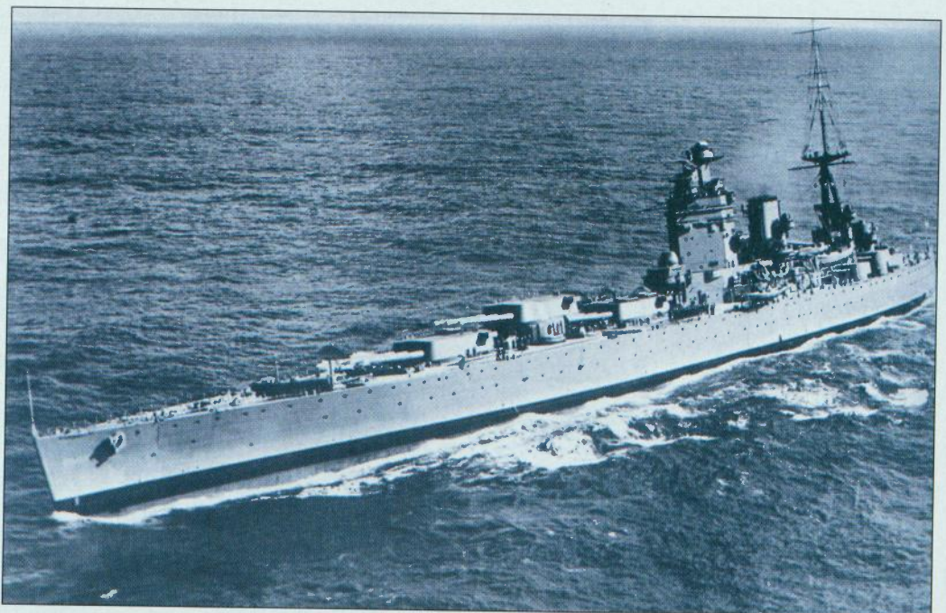
HMS Rodney utjelovljivao je sve pouke prethodnog rata; definicijom standardne istisnine prikriveno je 2000 tona vode koje su bile dijelom njegovog sustava podvodne zaštite
