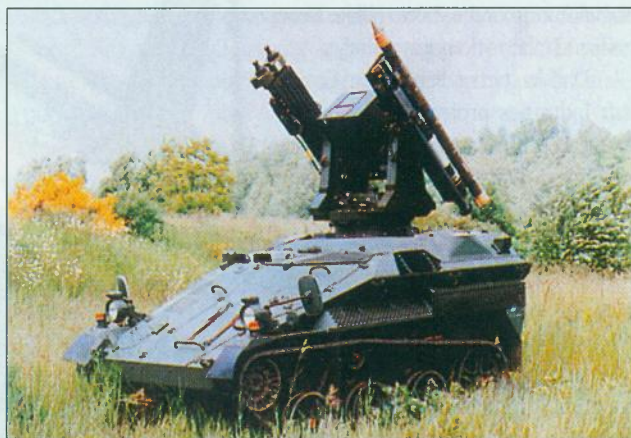
Četiri Stinger ili Igla rakete naoružanje su novog lakog oklopnog vozila Wiesel 2 namijenjenog njemačkim zračno desantnim snagama (gore je prototipski primjerak, a na donjoj slici serijski proizvedeno vozilo)
