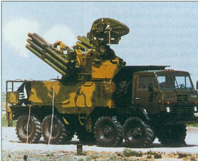
Panzir S-1 mješoviti je samovozni raketno topnički PZ sustav s vlastitim motrilačkim radarom. Sustav je ispitan i spreman za serijsku proizvodnju
