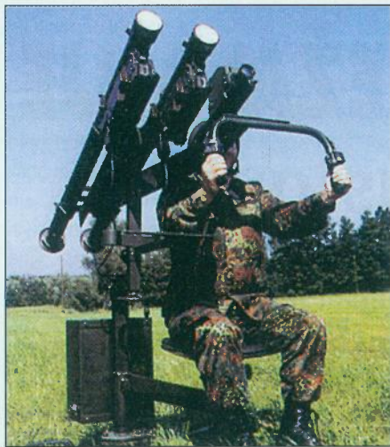
Novi Stinger lanser za dvije rakete Stinger ili Igla proizvod je tvrtke LFK i namijenjen je za njemačku vojsku i europske zemlje NATO saveza.
