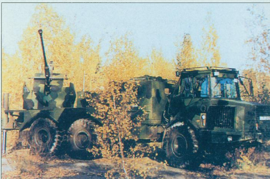
Sve veća pozornost usmjerava se na povećanje taktičke pokretljivosti PZ topničkih i raketnih sustava, te se i poznati švedski top L/70 kalibra 40 mm montira na šasije terenskog vozila Volvo
