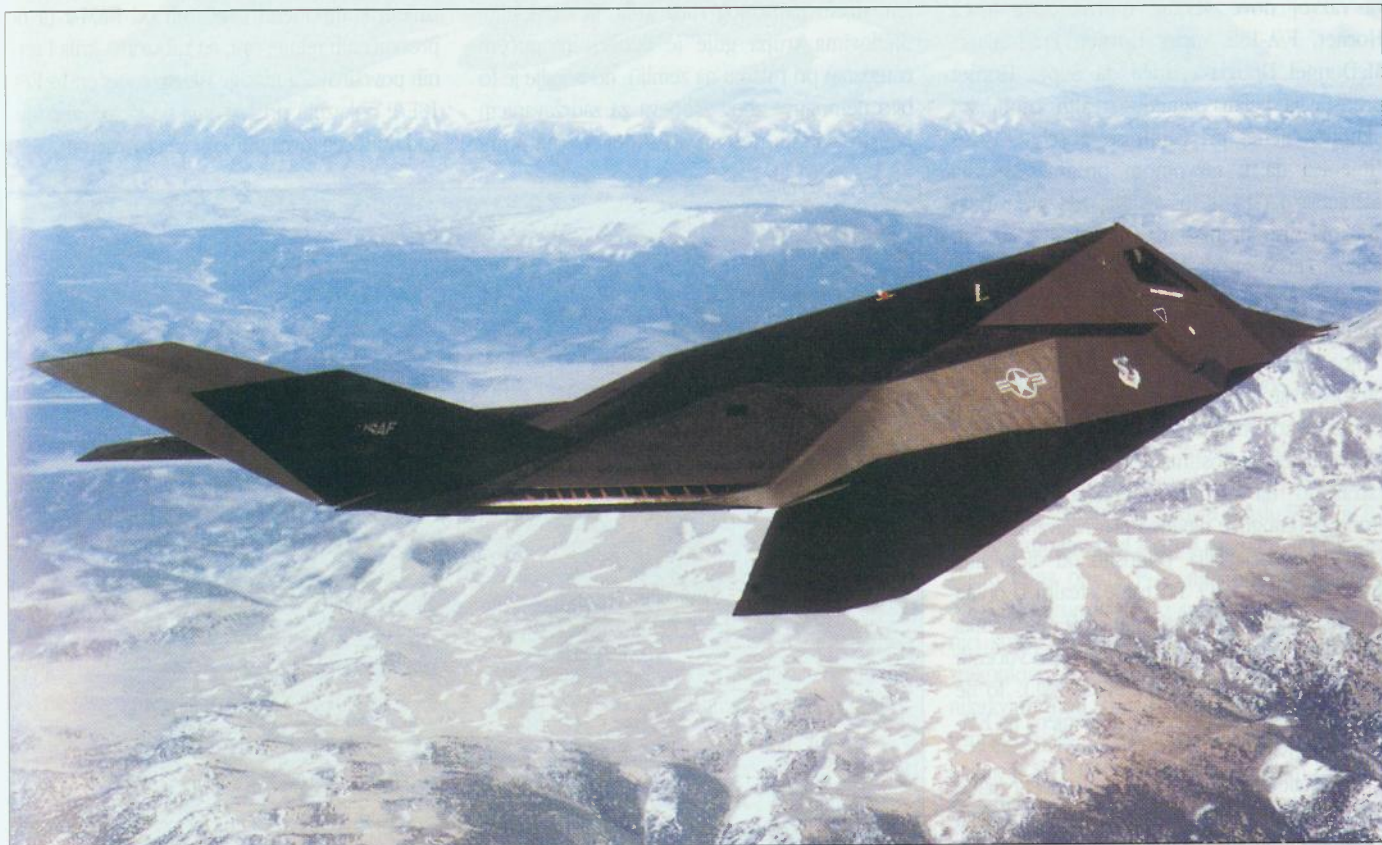
Primjena stealth tehnologija, prvi puta uspješno uporabljenih na jurišnom zrakoplovu F-117 (na slici) i strateškim bombarderom B-2, znatno će povećati borbenu vrijednost modernih lovaca
