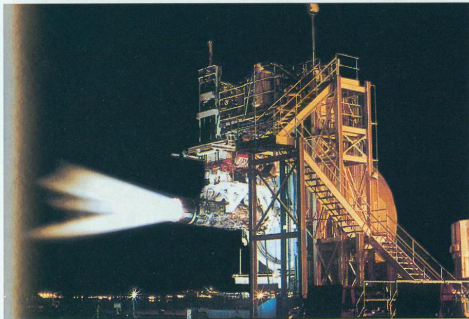
Primjena vektorskog potiska omogućit će znatno veću agilnost lovaca u zračnoj borbi. Na slici je ispitivanje 3D vektorske mlaznice AVEN na turboventilatorskom motoru General Electric F110, uspješno isprobane u letu na eksperimentalnom zrakoplovu F-16 MATV
