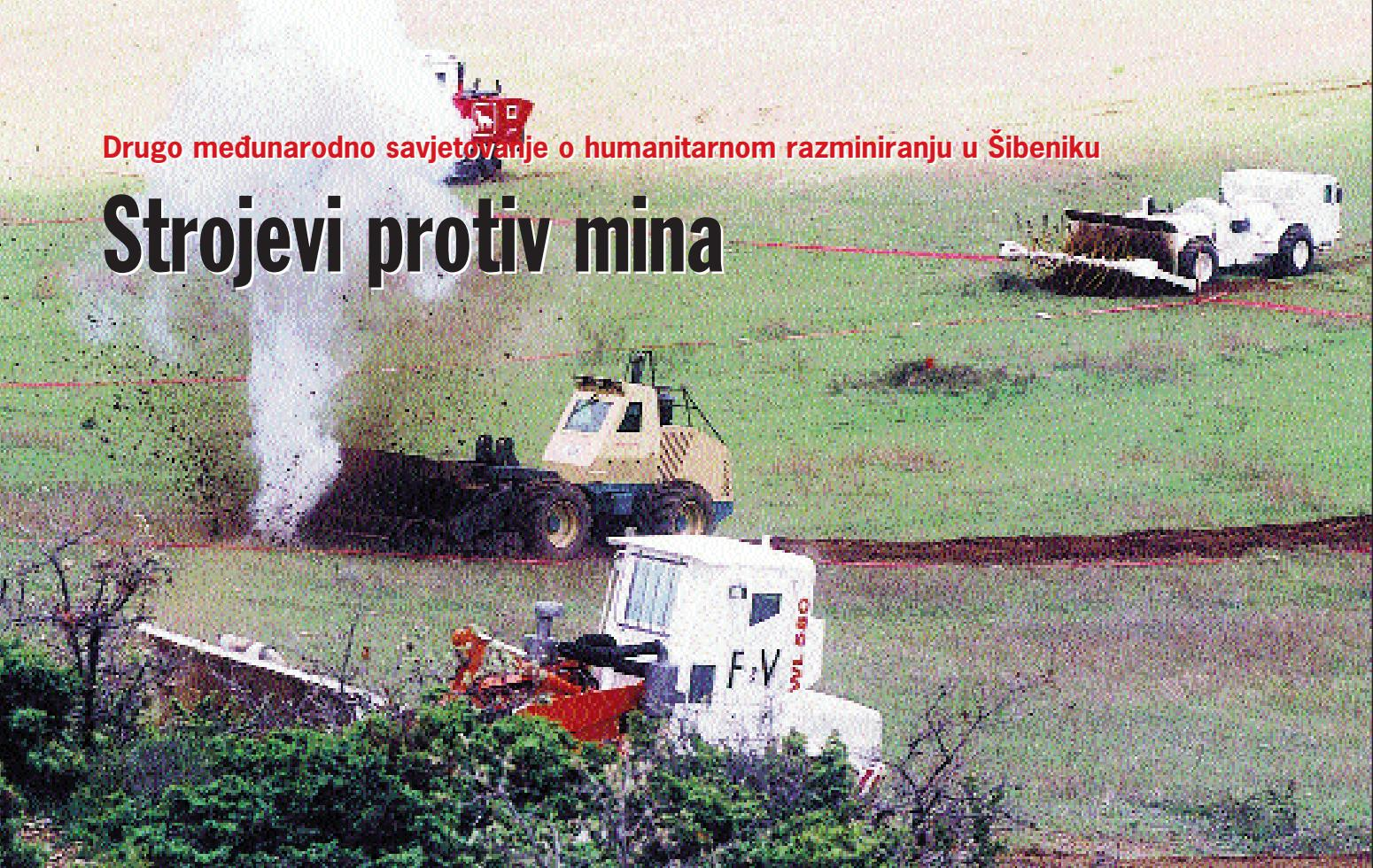
Strojevi bitno ubrzavaju razminiranje, te smanjuju rizik za ljudе koji uz strojeve sudjeluju u tome. Primjenom strojeva, ponajprije zbog bitno veće produktivnosti u odnosu na ručno pretraživanje sumnjivog terena, smanjuje se i cijena po jedinici površine obrađenog tla. No, strojevi ipak ne mogu nadomjestiti čovjeka, što znači da sve metode imaju svoje mjesto i ulogu, zaključak je sudionika savjetovanja
