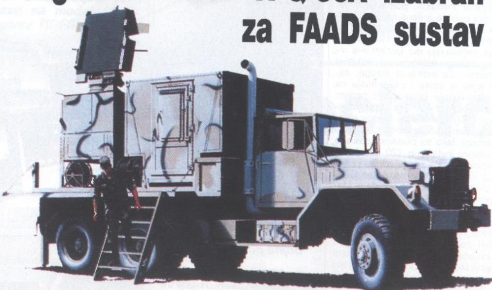
Novi Hughesov radar TPQ-36A prvo će biti postavljen na pettonski kamion
