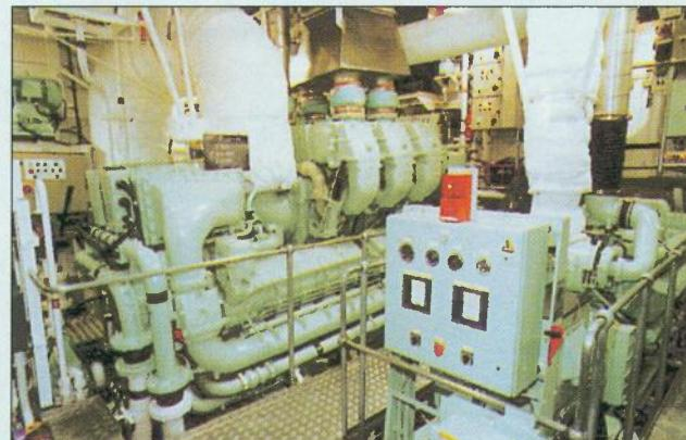
Prednja strojarnica s dva Dieselova motora MTU i generatorom smještenim između njih
