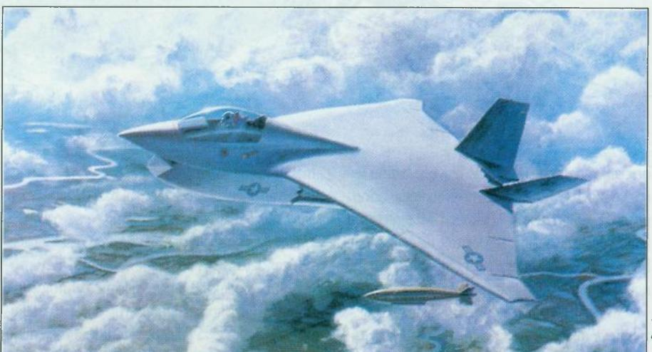
**Crtanje Boeinga X-35. Boeingov prijedlog je zanimljiv po činjenici da odabrana bezrepa konfiguracija delta krila isključuje primjenu dodatnih aerodinamičkih površina za stvaranje ugona, te da zbog kompaktnosti dizajna nema potrebe za preklapanjem krila radi lakšeg smještaja na nosaču zrakoplova (raspon krila iznosi samo 10,97 m)**
