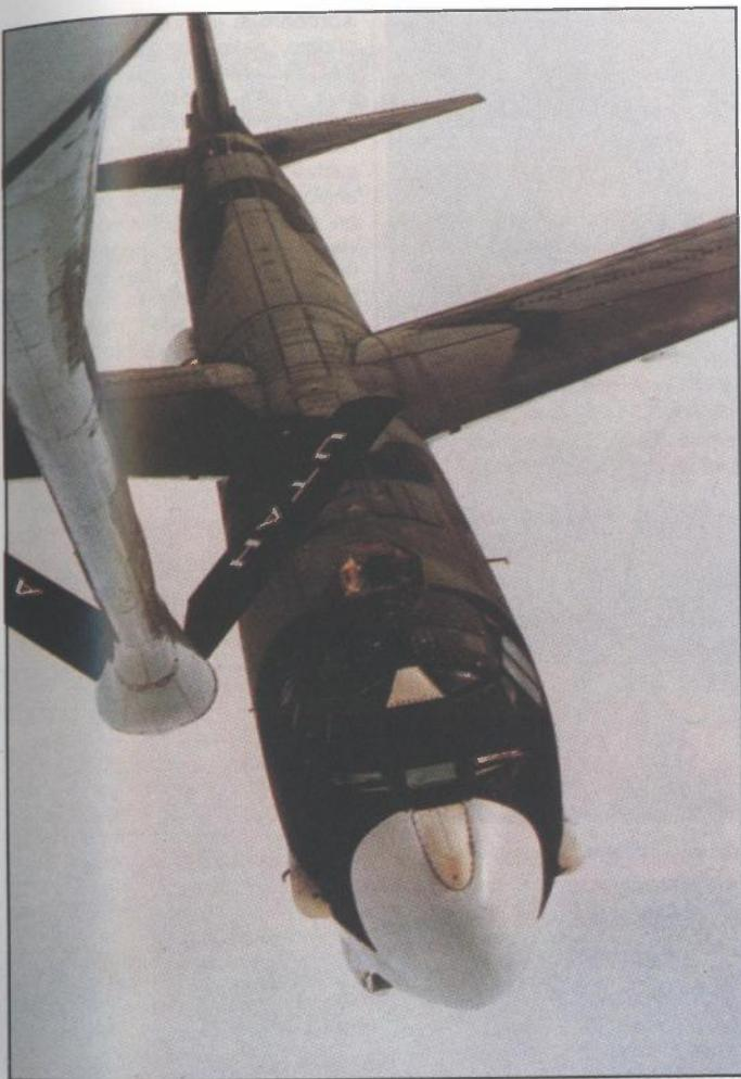
**B-52G zauzima poziciju za pretakanje goriva u zraku, s izvućenim stajnim trapom; između krila se vidi jedna od dvije prijamne antene navigacijskog GPS sustava**
