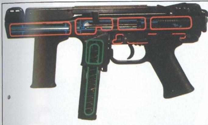
Djelomični presjek kratke strojnicy SPECTRE. Konstrukcija je zasnovana na trostupnom ciklusu rada zatvarača i nema klasične kočnice
