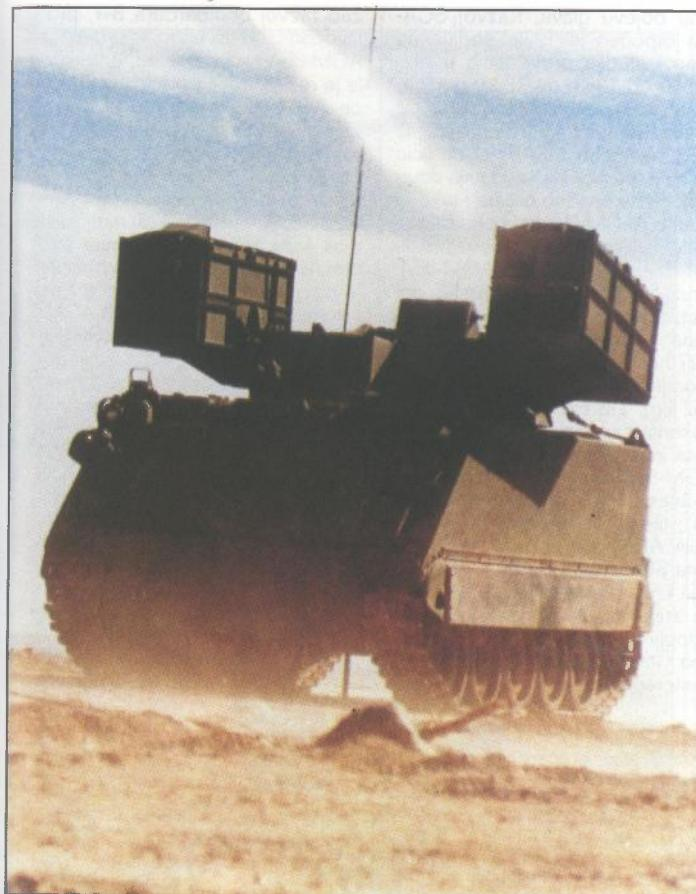
*Tvrtka Electronics and Space Corp (ESCO) integrirala je HELLFIRE raketu s oklopnim transporterom M113 u sklopu ugovora s Missile Commandom američke vojske. Sustav kupole koji može smjestiti osam raketa zaštićenih oklopom primjeniv je i za druge platforme na gusjenicama ili kotačima. ESCO i Rockwell zajednički provode marketinšku promicbu sustava pod imenom Ground Launch Hellfire – Heavy (zemaljski lansirana Hellfire raketa – teška inačica)*
