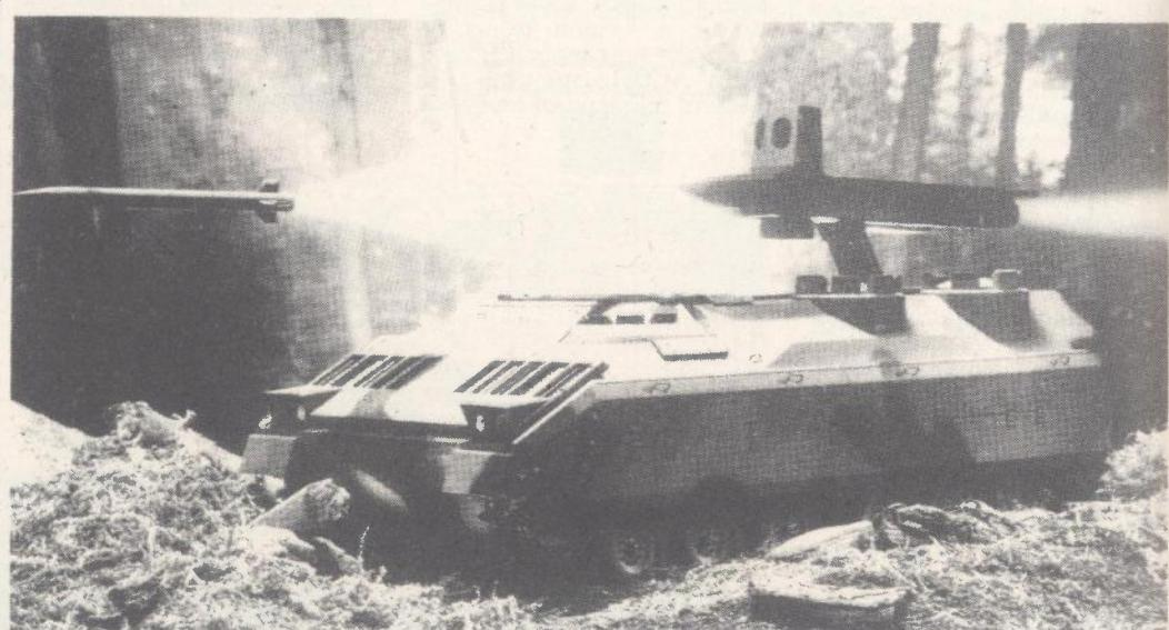
Borbeno vozilo LOSAT s lanserom raket na podizanje koji uključuje i optičke ciljničko-motričke sastave
