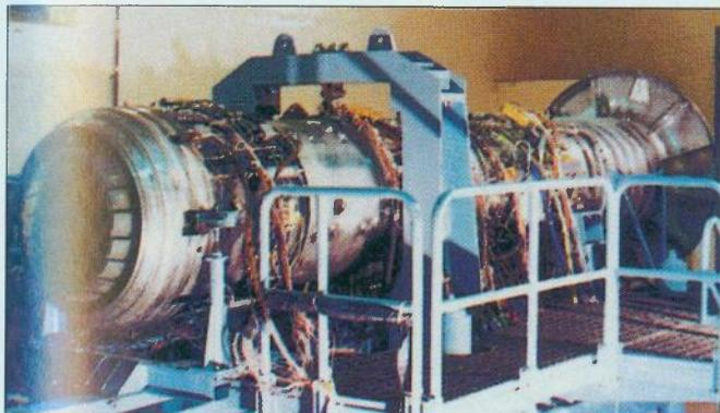
Za LCA razvija se turboventilatorski motor GTX-35VS, čije je zanimljivo svojstvo zadržavanje visokog potiska bez obzira na visoku temperaturu okolnog zraka
