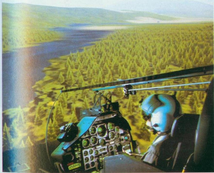
Visoko vjerni zrakoplovni simulatori daju visokovjerne prikaze prostora kroz koje, ili iznad kojih "leti" pilot prigodom trenaže, no isto tako treba istaknuti i njihovu visoku cijenu koja poneki put prelazi i cijenu stvarne letjelice za koju se pilot izučava
