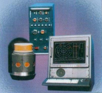
Američki RESM sustav ARGO Systems AR-900 pokriva frekvencijski opseg od 2 do 18 GHz, osjetljivost mu je -65 dBm, točnost određivanja smjera mu je od 2 do 3,5 stupnjeva, a točnost mjerjenja frekvencije od 3 do 6 MHz, dok je kapacitet obrade signala 1.000.000 impulsa u sekundi
