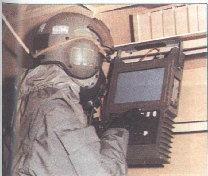
Pi, eksperjni sustav za dijagnostiku (lociranje mogućih pogrešaka u radu) u sastavu sustava za upravljanje letom helikoptera CH-47D. Napisan je u C-u i implementiran na prijenosno računalo. Pi preporučuje kalibraciju, podešavanje i zamjenu pojedinih komponenti prepovlađujući na taj način broj potrebnih probnih letova.
