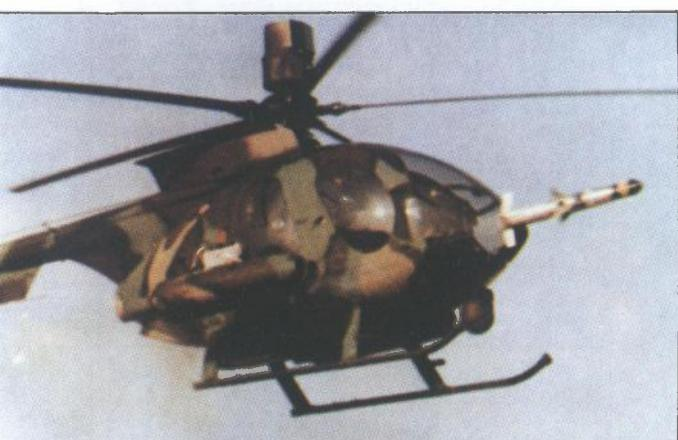
**Ispaljivanje rakete BGM – 71A TOW s Mc Donnel Douglas 530 MG Defender helikoptera. Raketa je tek napustila lansirnu cijev a njezina krilca su gotovo već otvorena a krila se tek otvaraju. Optički sustav je na ovom helikopteru smješten iznad rotora**
