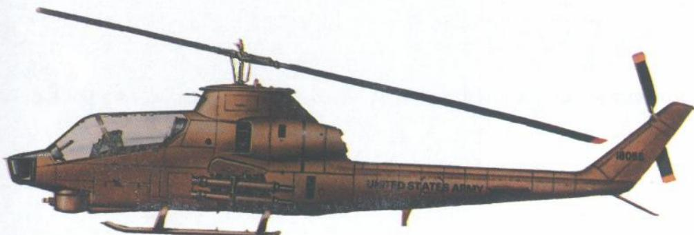
**AH-1S TOW Cobra ima montiran M65 TOW sustav koji obuhvaća TSU (teleskopski) ciljnik na nosu, pojačivač repne grede, uređaj u kabini i osam lansirnih cijevi**
