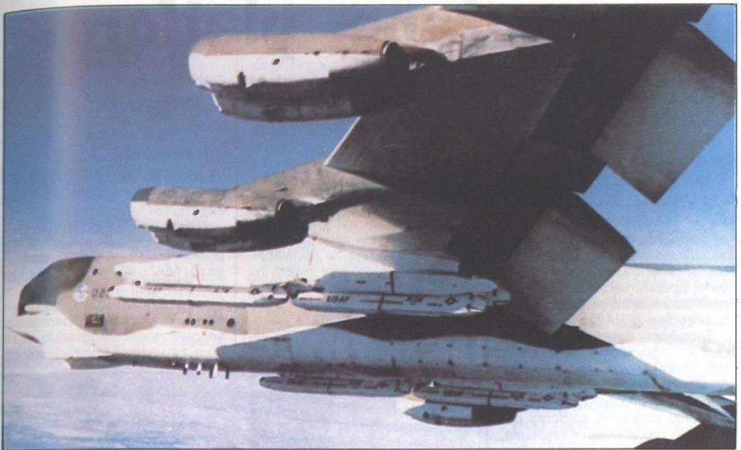
**Na svakom potkrilnom nosaču B-52 može nositi do šest krstarećih projektila**
