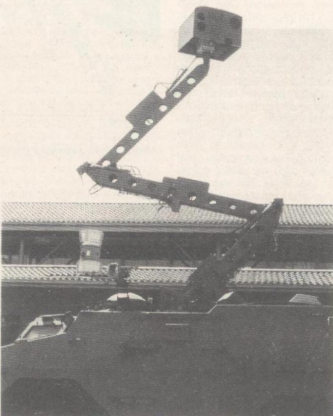
Motrički sustav EAOS smješten na sklopivom jarbolu ugrađenom na borbeno vozilo RATEL 6x6
