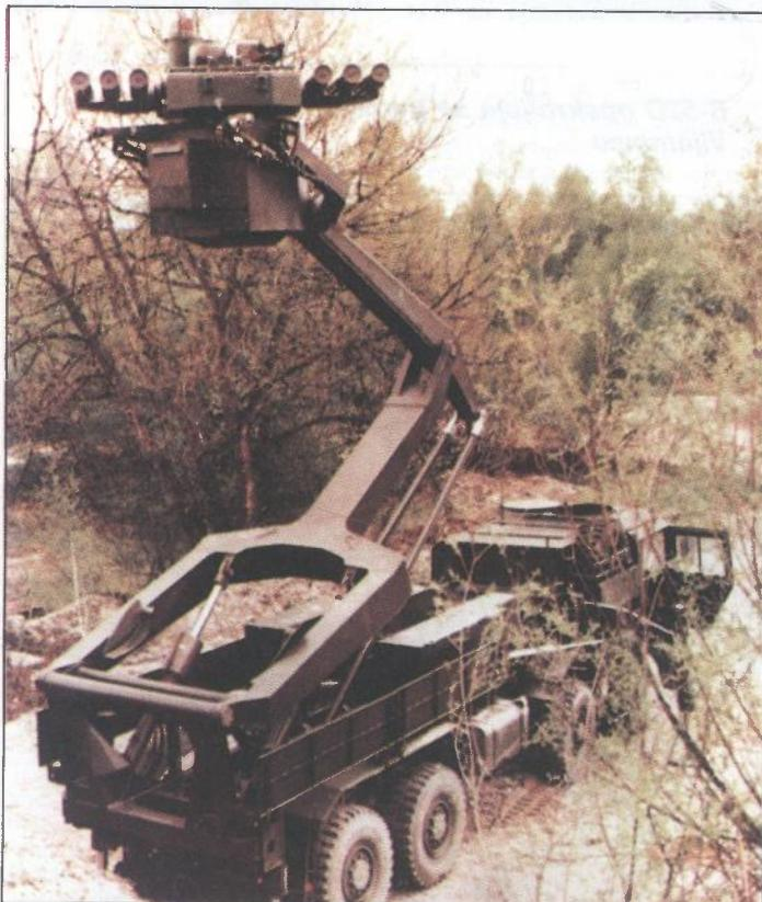
tira, te se s njim eksperimentira i Njemačka koja razvija hidrauličkom pokretane podižuće platforme s oružjem za protuoklopnu i protuhelikoptersku borbu na srednjim daljinama.
