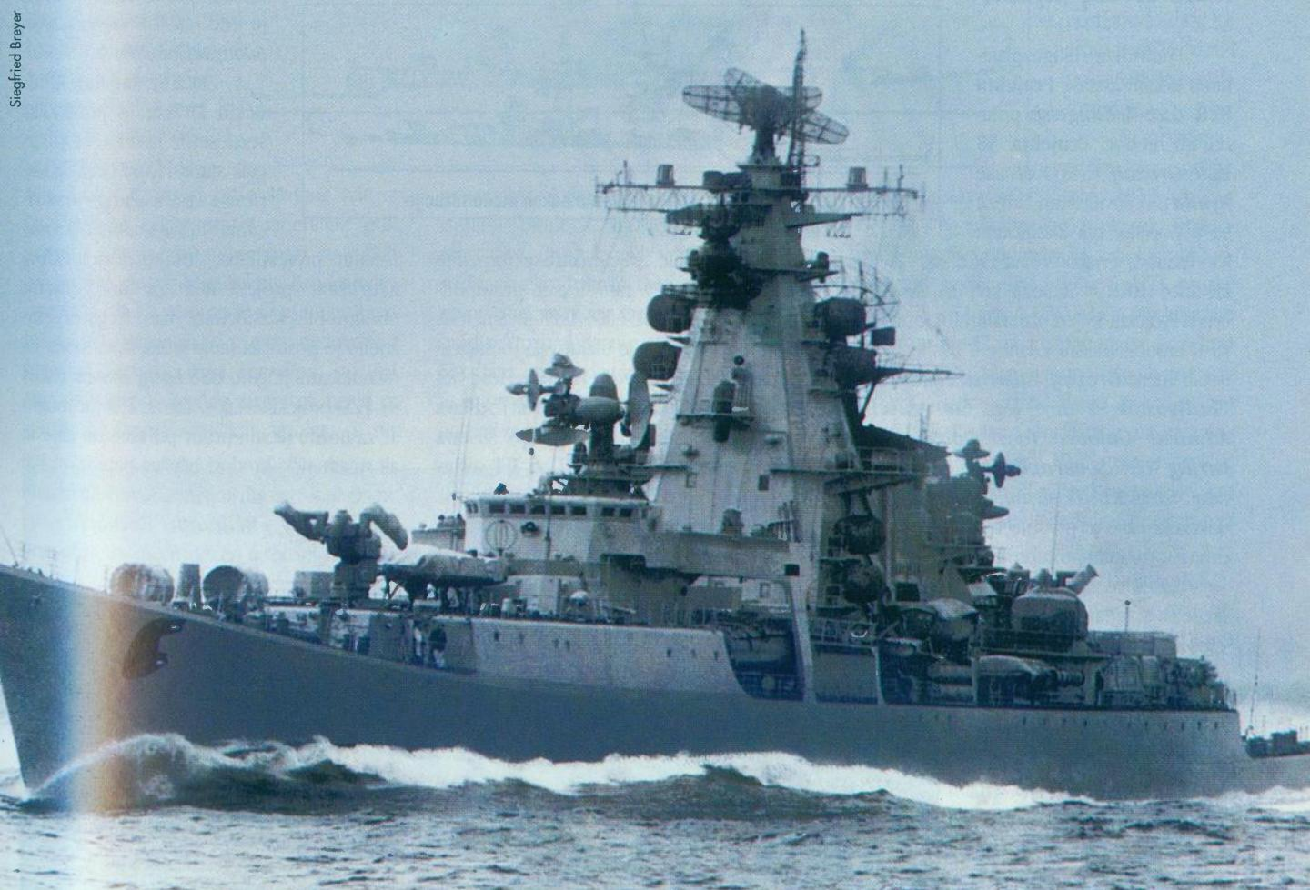
Na pramcu krstarice klase Kresta I dobro je vidljiv lanser ZIF-101 za protuzračne projektile sustava 4K91 Volna M-1 (NATO oznake SA-N-1), a na nadgradu iznad zapovjednog mosta smješten je radarski sustav Jatagan (Peel Group)
