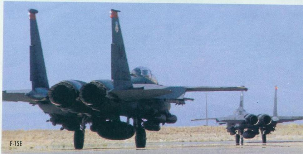
postavljaju na bokove zrakoplova, novim radarem APG-70. Pogonska skupina je dva turboventilatorska motora Pratt&Whitney F100-P-220. Dvosjedna trenažna inačica F-15C je F-15D (u službu ulazi 1979.).
