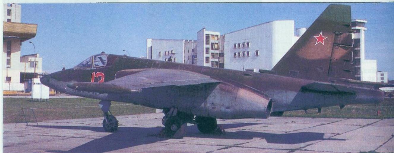
Misteriozni predserijski T-8-12, na čijoj je oplati primijenjen specijalni premaz za upijanje radarskog zračenja. Zrakoplov je bio izložen kratko vrijeme na izložbi u zrakoplovnoj bazi Hodinka pokraj Moskve
