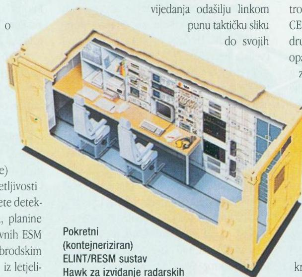
**Pokretni (kontejneriziran) ELM/RESM sustav Hawk za izviđanje radarskih signala u frekvenčijskom opsegu 0,5-18 GHz**
