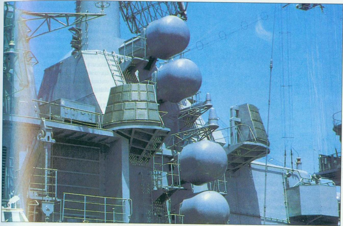
Antene ruskog ESM sustava koji je NATO nazvao Rum Tub (zelenkaste sačaste površine) snimljene na krstarici klase *Slava*. Četiri okomito postavljene polukugle su antene širokopojasnog omotača Side Globe (rusko ime Gurzuf)
