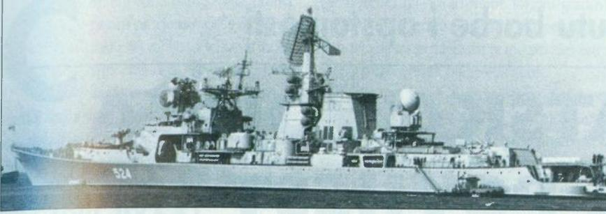
Na krmenom nadgradu krstarice Azov smješten je radarski sustav Volna (Top Dome) sustava S-300F
