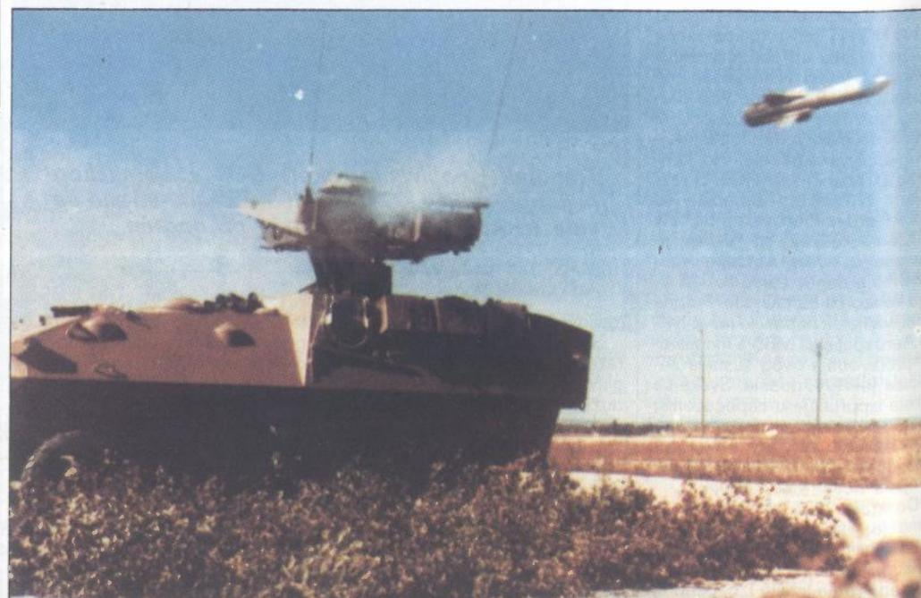
keta za 8,6 sekundi stiže do daljine od 2000 metara, za 12,5 sekundi do 3000 metara te 16,30 sekundi do 4000 metara. Startni motor ima četiri kose mlaznice blizu korijena rasklopnih krila. Raketom upravlja TVC spoiler (spoiler za upravljanje vektorom potiska ili spoiler za mijenjanje pravca potiska raketnog motora radi upravljanja kretanjem raketne glave) koji je smješten u sredini ispušnog mla-za.
