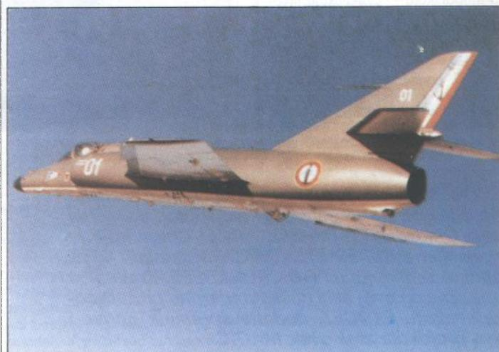
*Prvi prototip, dobiven pregradnjom 68. proizvedenog ETENDARDA IVM*
