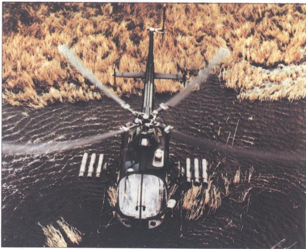
**Pogled odozgo na helikopter BO 105P. Jasno se vidi šest kontejnera (po tri sa svake strane). Žirostabilizirani optički sustav je montiran na krovu desno**
