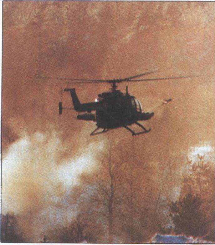
*Trenutak ispaljivanja rakete HOT s njemačkog helikoptera BÖLKOW BO 105. Zdesne strane se vide tri kontejnera montirana na nosaču*
