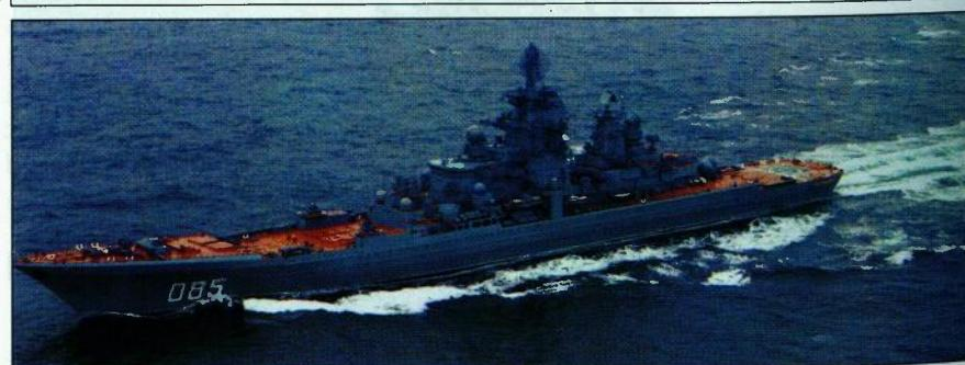
*Admiral Nahimov* (bivši *Kalinjin*) jedini je od prva tri broda operativan. U pramčanim kosim lanserima nosi po 20 protubrodskih projektila sustava Granit (SS-N-19 Shipwreck), dok u 12 okomitih lansera protuzračnog sustava S-300F Fort (SA-N-6 Grumble) nosi ukupno 96 projektila
