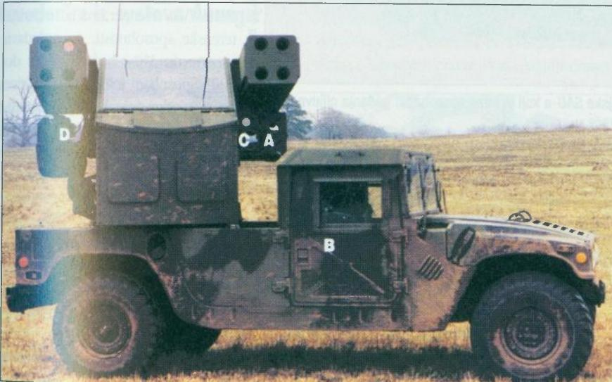
PZO raketni sustav Avenger sastoji se iz visokoprohodnog terenskog vozila tipa HMMWV (B) i borbene kupole. Najvažniji podsustavi borbene kupole su: FLIR kamera (A); laserski daljinomjer (C); teška strojnica M3P (D); dva skupa s po četiri Stinger rakete (E); jedinica za daljinsko upravljanje kupolom (F) i sustavi veza u kupoli
