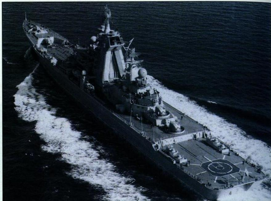
Jedino je *Kirov* (sadašnji *Admiral Ušakov*), kao prva jedinica istoimene klase, naoružan s dva topa AK-100 kalibra 100 mm i lanserom protupodmorničkih projektila sustava Metelj, dok ostala tri broda imaju jedan dvocijevni top AK-130 kalibra 130 mm i sustav Vodopad-NK
