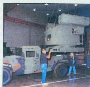
Prebacivanje borbene kupole s jednog vozila na drugo ili njezino postavljanje na tlo, jednostavno je izvodivo dizalicom odgovarajuće nosivosti
