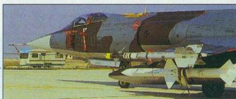
Uz standardni AIM-9 Sidewinder, talijanski F-104S nose i poluaktivno radarski navođene projektele srednjeg dometa zrak-zrak AIM-7 Sparrow
