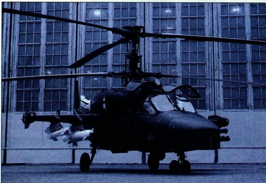
Ka-52 naoružan kombinacijom projektila zrak-zrak (R-73, na desnom vanjskom potkrilnom nosaču) i zrak zemlja (AS-12/H- na desnom unutarnjem potkrilnom nosaču, te lansirne cijevi za PO projektila Vikhr na lijevom vanjskom potkrilnom nosaču)
