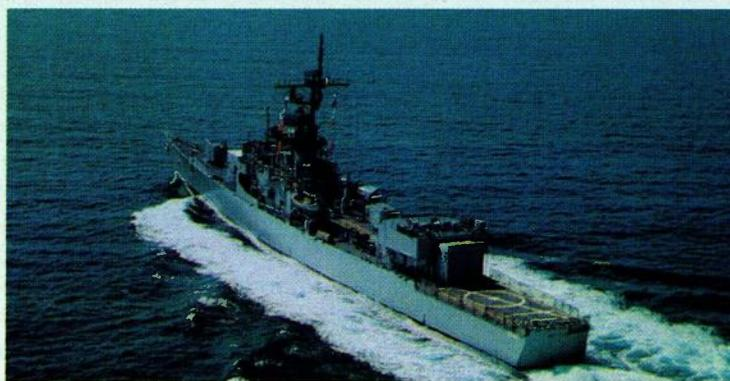
Na krmi fregate **USS Bradley** (sada u brazilskoj službi kao **Pernambuco**) razreda **Garcia** uočava se teleskopski hangar, nužan zbog ukrcavanja klasičnog vrtoleta umjesto prvotno planiranog bespilotnog vrtoleta **DASH**
