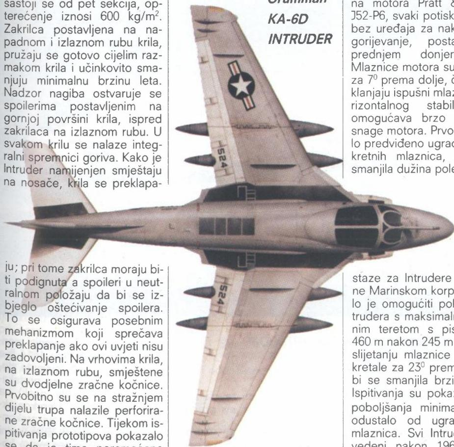
ju; pri tome zakrilca moraju biti podignuta a spoileri u neutralnom položaju da bi se izbjeglo oštećivanje spoileru. To se osigurava posebnim mehanizmom koji sprečava preklapanje ako ovi uvjeti nisu zadovoljeni. Na vrhovima krila, na izlaznom rubu, smještene su dvodjelne zračne kočnice. Prvobitno su se na stražnjem dijelu trupa nalazile perforirane zračne kočnice. Tijekom ispitivanja prototipova pokazalo se da je time poremećeno strujanje zraka prema repnim
