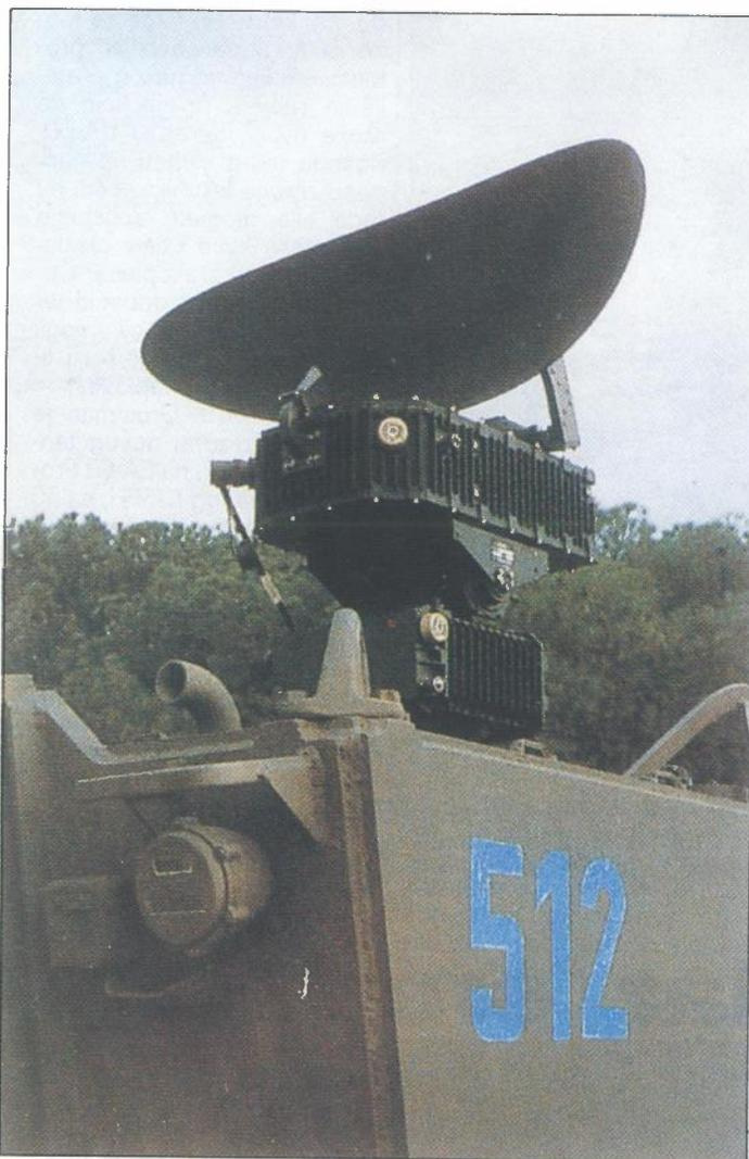
**ARINE će biti postavljen i na oklopna vozila, gdje će zamijeniti radar RASURA**
