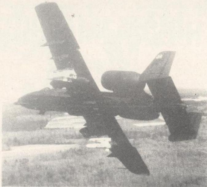
Jurišni zrakoplov za izravnu potporu A-10A. Pod krilima se vide rakete AGM-65 MAVERICKS
