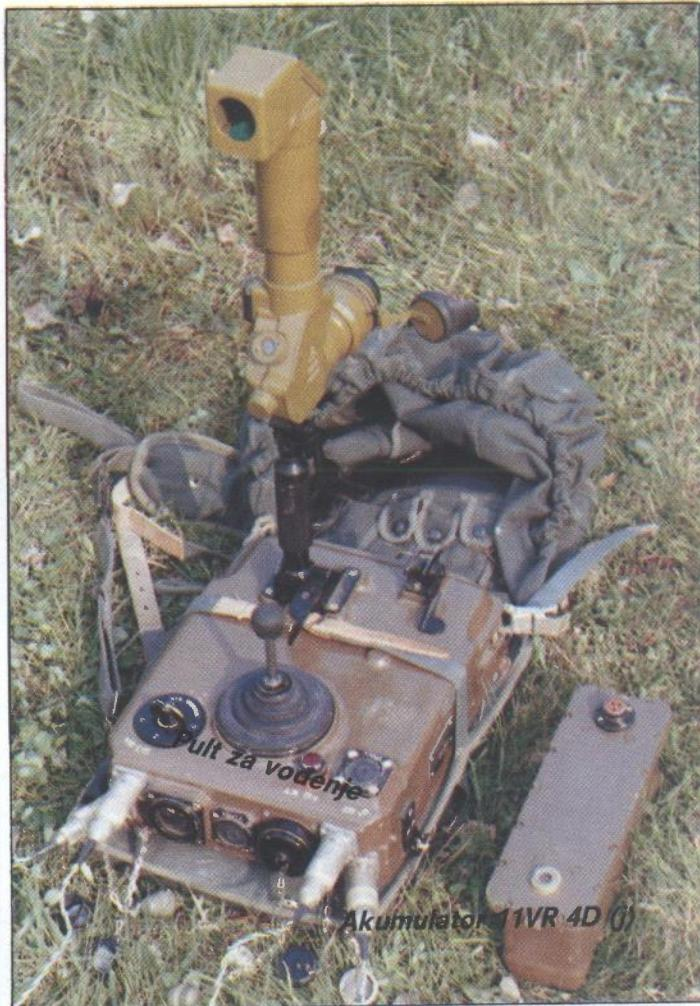
Prikazba spajanja spojnih kablova na pult za vođenje. U prednjem planu se vide kalemovi na koje se namataju kabelovi za spajanje pojedinih raketa s pultom za vođenje. Desno od pulta za vođenje nalazi se akumulator 11VR 4D (j)
