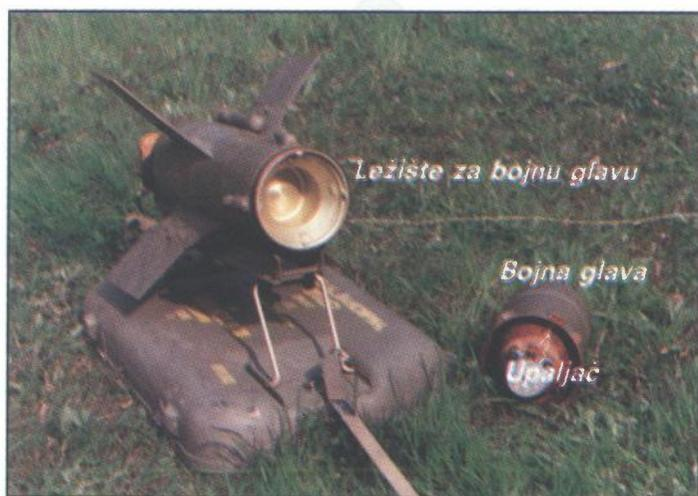
Raketa 9M14M na lanseru s odvojenom bojnom glavom
