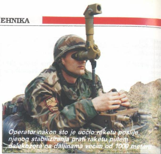
**Operator nakon što je uočio raketu poslije njenog stabiliziranja prati raketu putem dalekozora na daljinama većim od 1000 metara**
