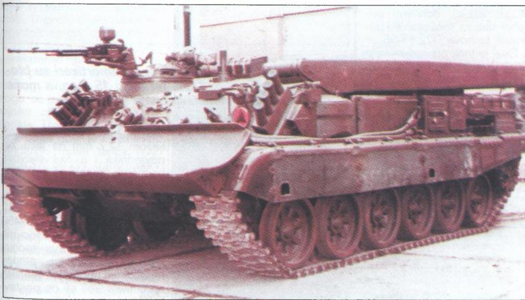
**Tank za izvlačenje i popravak WZT-3 izgrađen na bazi tanka T-72, poljske proizvodnje**
