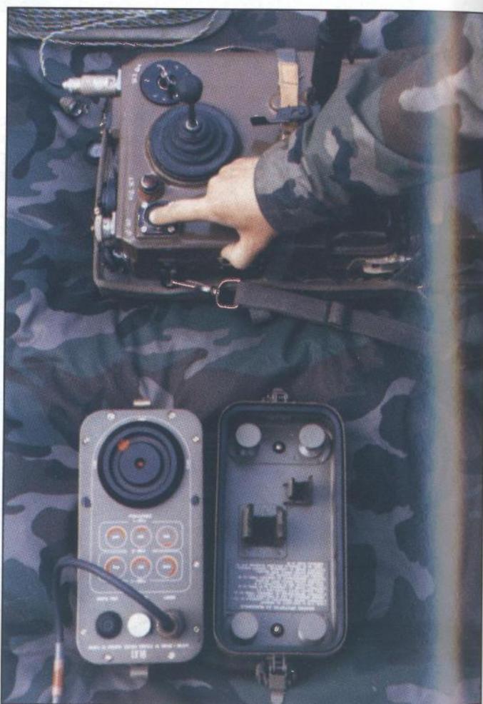
*Prikazba spajanja pulta za vođenje na uređaj LV16 za ispitivanje ispravnosti pulta*
