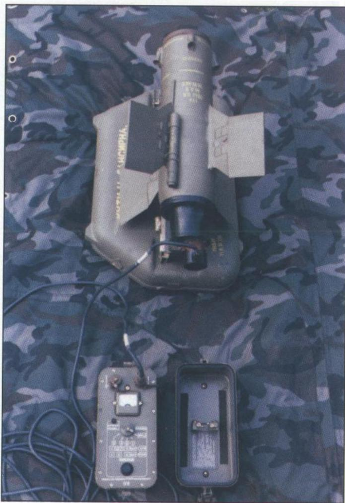
*Pogled na spoj rakete i uređaja LV18 za ispitivanje rakete (bojna glava rakete obvezno mora biti skinuta s tijela rakete)*
