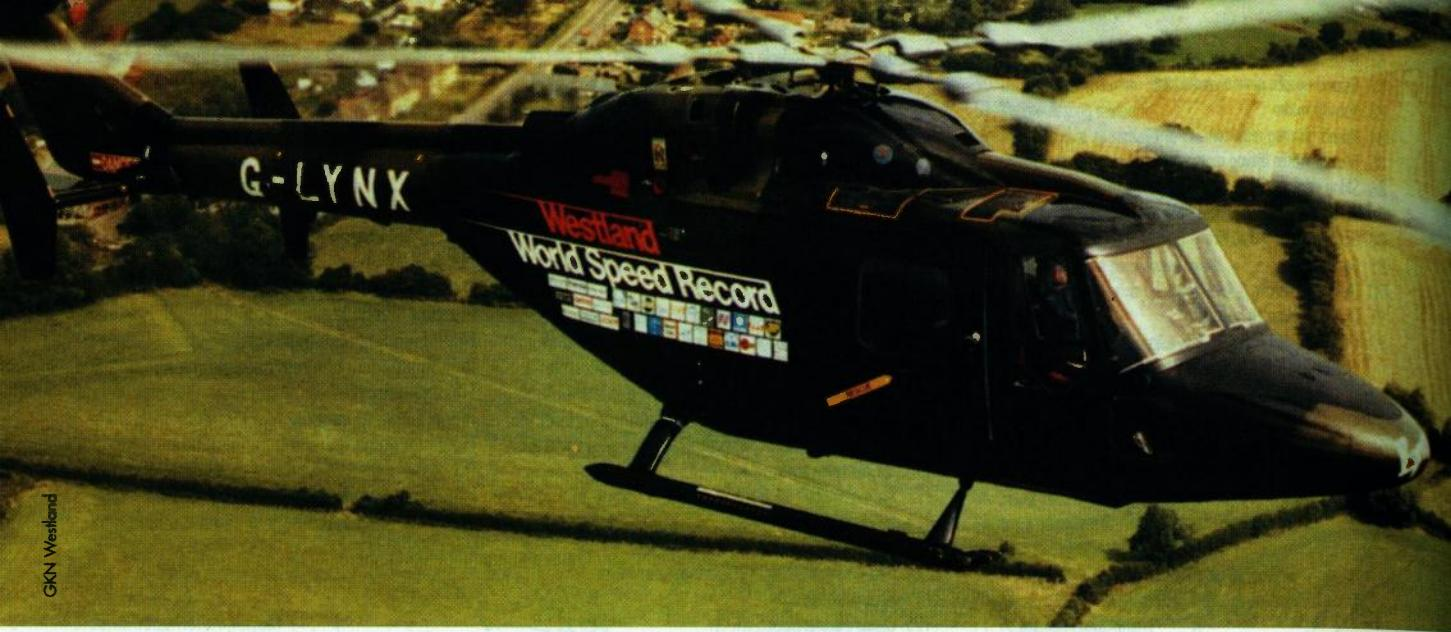
**U izradbi krakova rotora EH 101 iskorišteno je iskustvo stečeno s BERP (British Experimental Rotor Project) programom, u sklopu kojega je jedan Lynx (na slici) s povećanim vrhovima krakova rotora postigao 1986. svjetski rekord brzine leta za vrtotele od 399 km/h**
