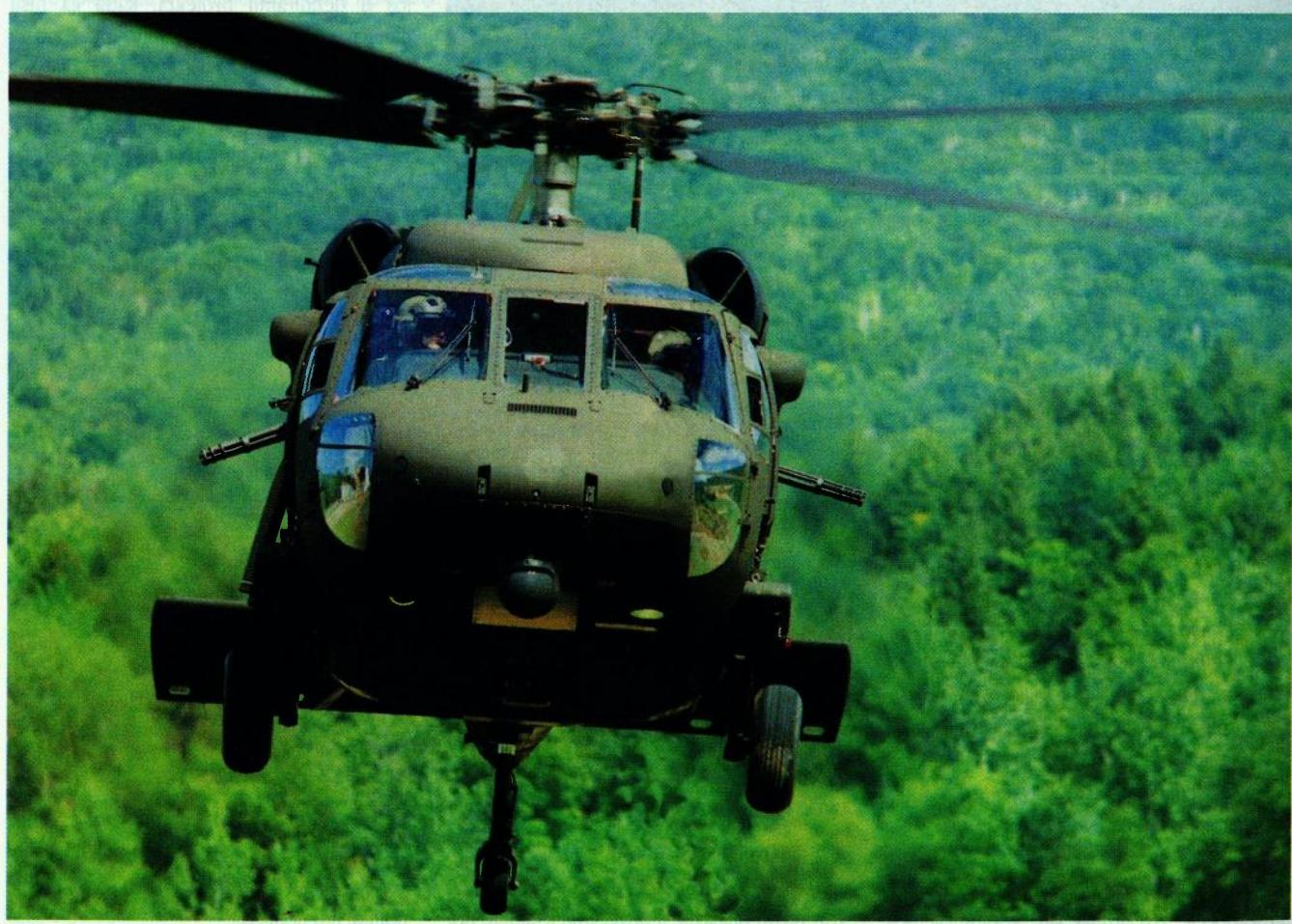
Američki višenamjenski vrtoljet Sikorsky UH-60A Black Hawk s na lijevom i desnom boku postavljenim višecijevnim strojnicama M134 Minigun. Strojnice su postavljene na posebno izradene slobodnokretne držače (Pintle Mount) i mogu se uvući unutar trupa ili izvući tako da vire kroz prozore (to je ujedno i borbeni položaj pri djelovanju).
