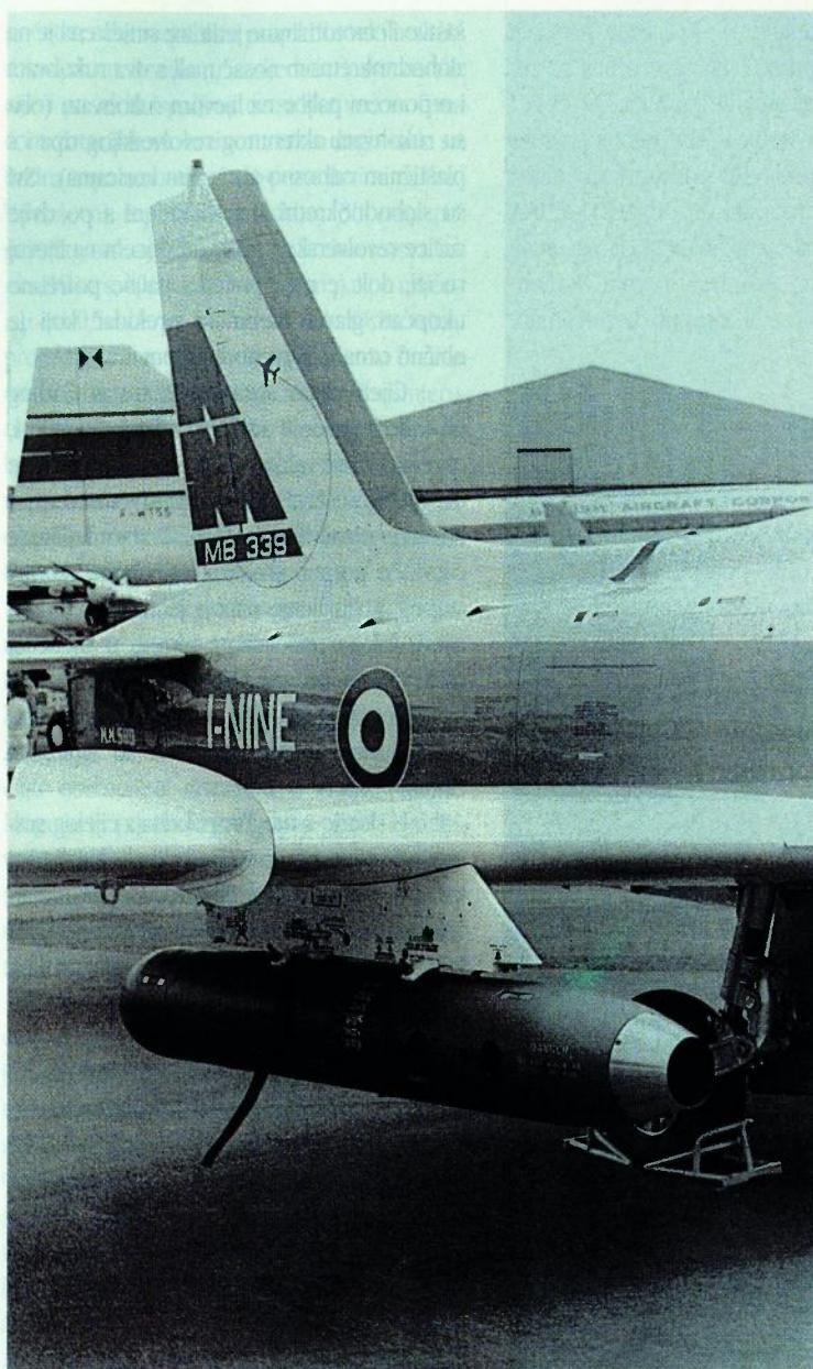
Strojnica Minigun postavljena je i u podvjesne kontejnere. Na slici je kontejner SUU-11B/A, snimljen 1977. podvišen pod desno krilo talijanskog borbenog zrakoplova MB.339
