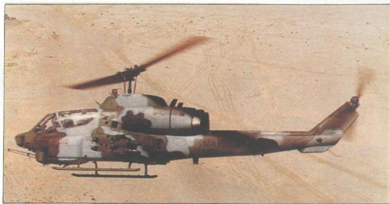
*Jurišni helikopter AH-1W naoružan protuoklopnim raketama TOW sustava*
