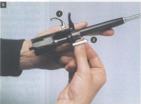
5. Odvajanje zatvarača od nosača
