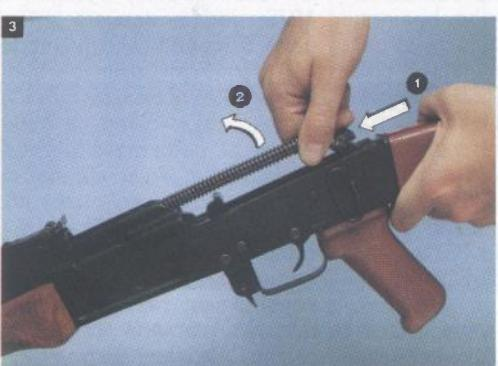
4. Vađenje nosača zatvarača sa zatvaraćem
