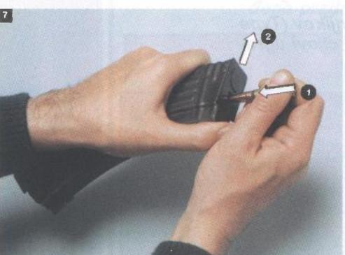
7. Rasklapanje spremnika (pritisnuti utvrđivač dna spremnika, a zatim odvojiti dno spremnika te izvaditi oprugu s donosačem metaka)
